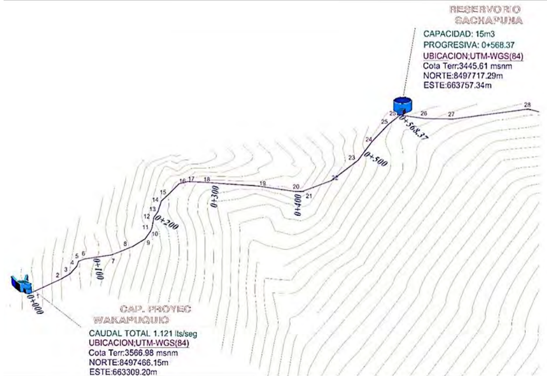
Figura 45. sistema de conducción
