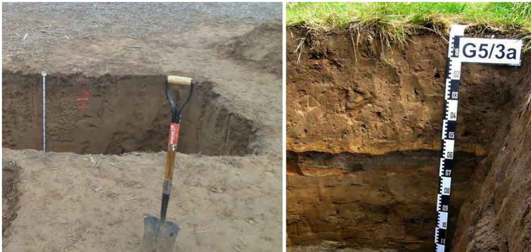
Figura 2. Calicata, toma de muestras Fuente: Portal frutícola.com
