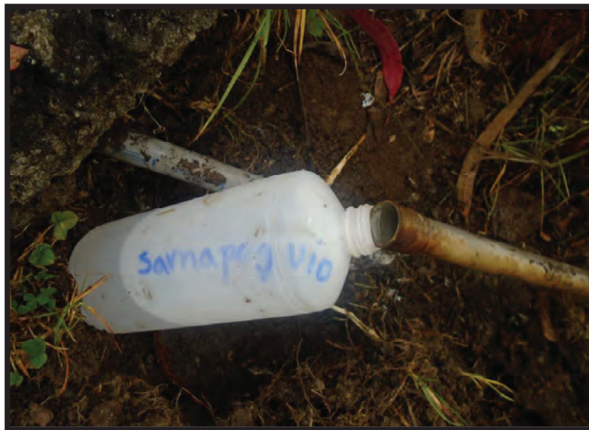
Foto N° 16: PROCESO DE AFORO MANANTIAL WAKAPUQUIO anotando los datos hallados en campo.
