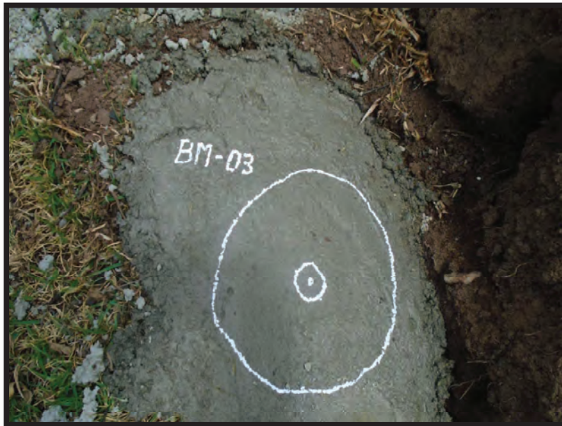
Foto N° 6: Pintado de los BMS durante el levantamiento topográfico.
