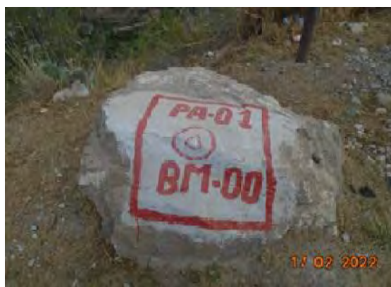
Figura 19. pintado de BMs durante el levantamiento topográfico
