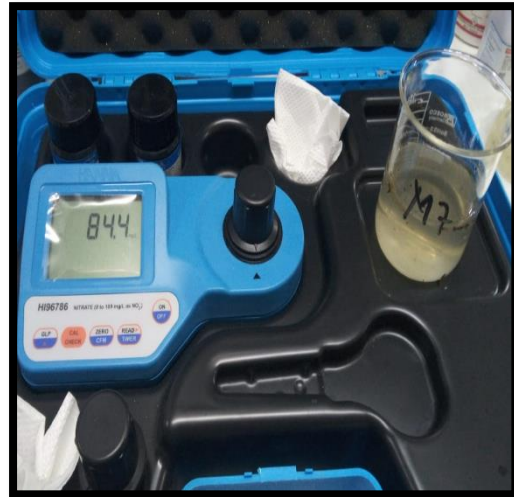
Figura 51: Medición de nitratos por espectrofotometría UV/v
