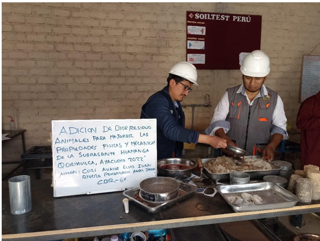
Fotografía N°14: Mezclado del terreno natural (suelo) con biorresiduo animal 6%
