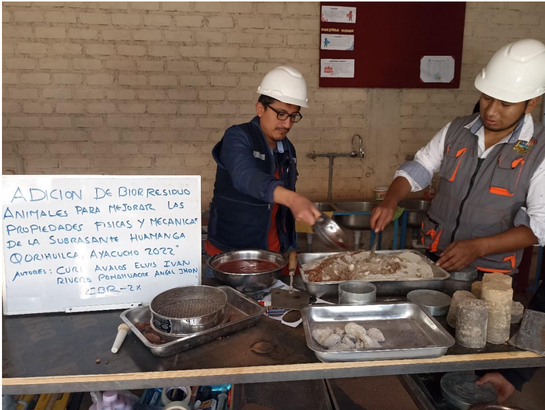
Fotografía N°12: Mezclado del terreno natural (suelo) con biorresiduo animal 2%
