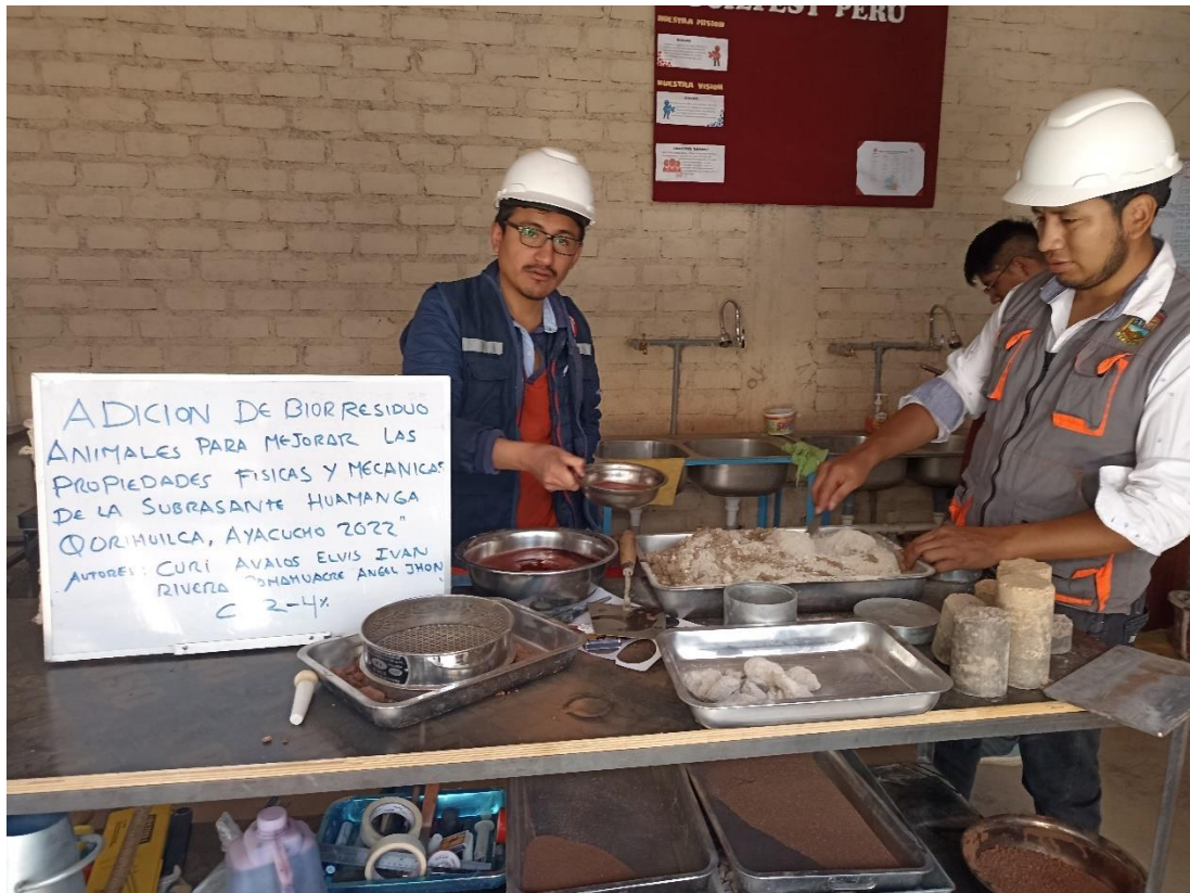
Fotografía N°13: Mezclado del terreno natural (suelo) con biorresiduo animal 4%
