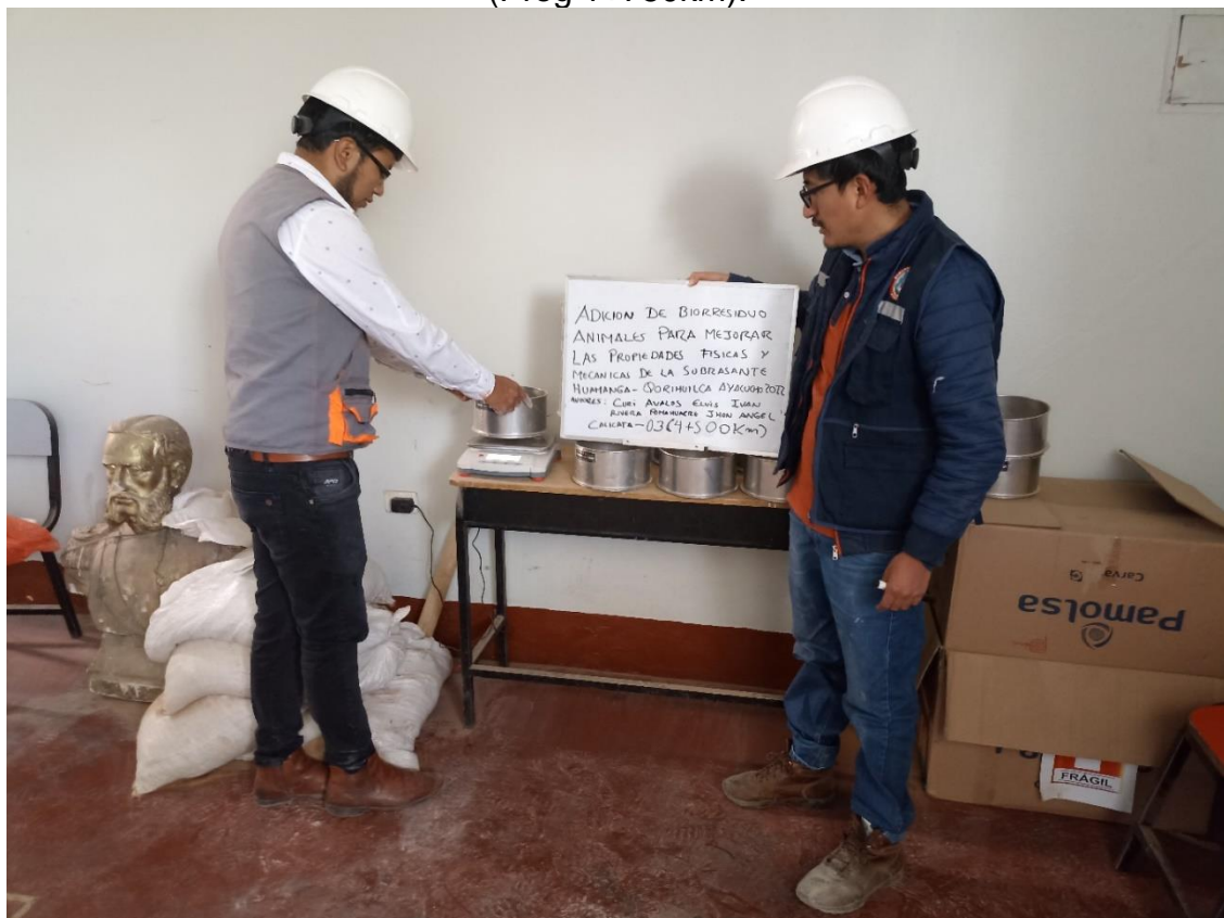
Fotografía N°08: Proceso del Análisis granulométrico-Tamizado de la calicata 03 (Prog 4+500km).
