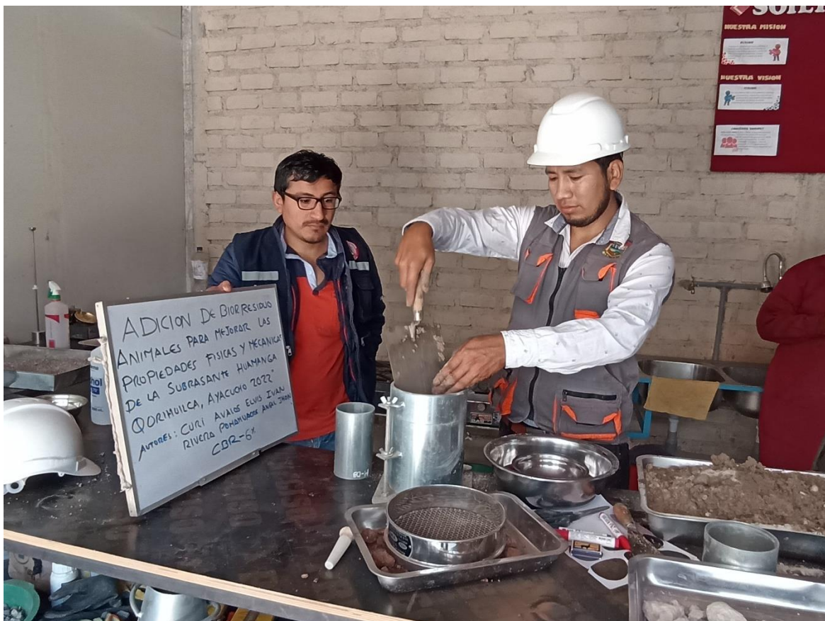
Fotografía N°16: Proceso de llenado en los testigos del terreno natural (suelo) con biorresiduo animal 6% para su evaluación a través del ensayo de CBR.
