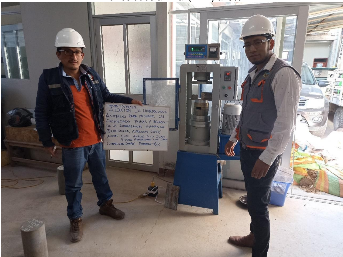
Fotografía N°22: Ensayo de Compresión simple del terreno natural con Adición de Biorresiduos animal (BRA) al 6%.
