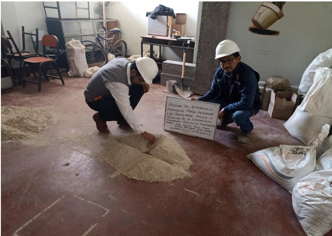
Fotografía N°04: Cuarteo de muestra extraída de la calicata 01 (Prog1+750km).
