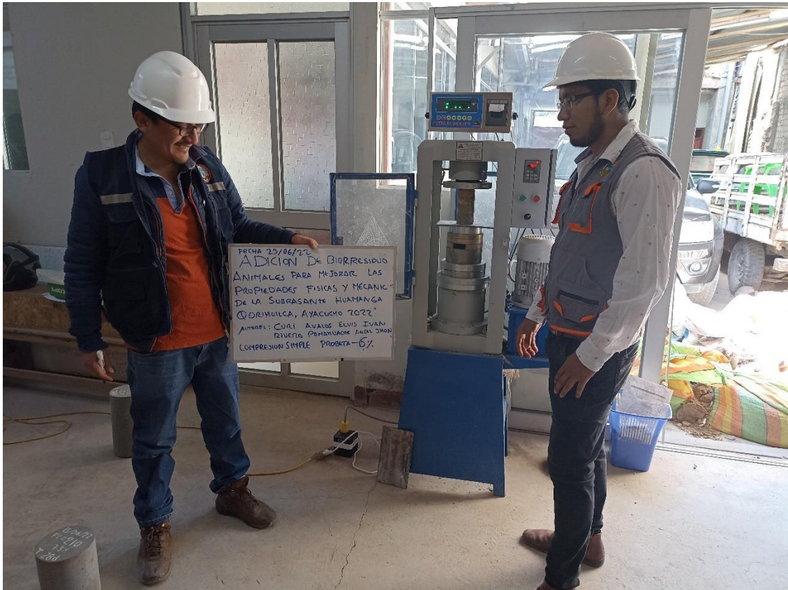
Fotografía N°21: Ensayo de Compresión simple del terreno natural con Adición de Biorresiduos animal (BRA) al 6%.
