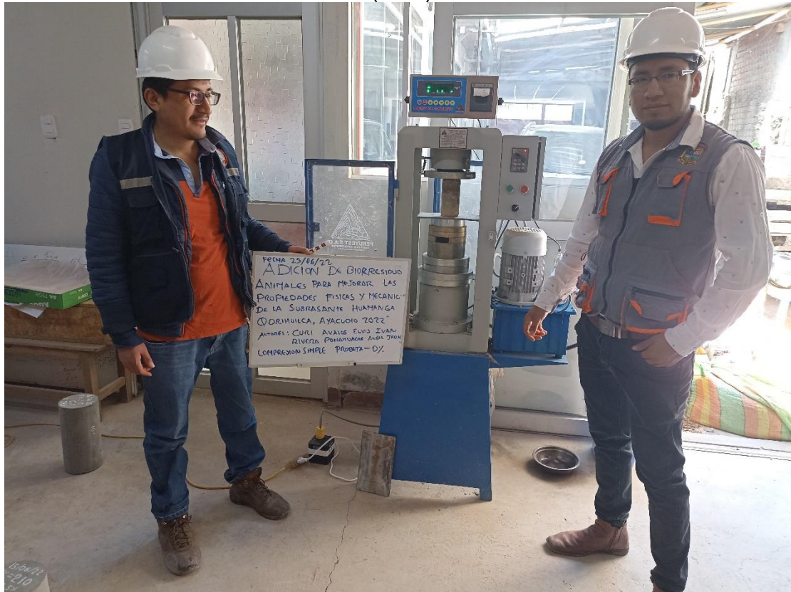
Fotografía N°20: Ensayo de Compresión simple del terreno natural sin Adición de Biorresiduos animal (BRA).
