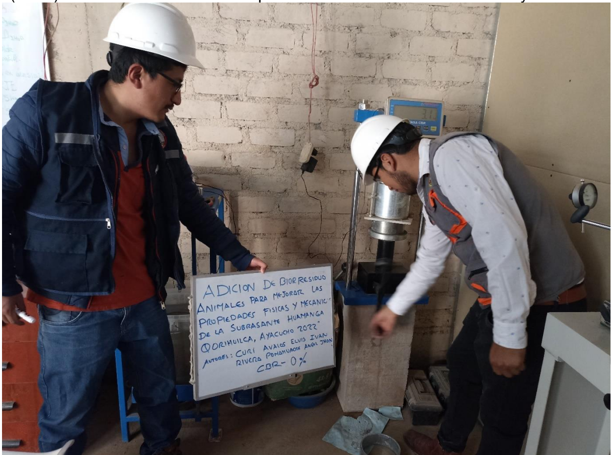
Fotografía N°18: Ensayo de CBR del terreno natural (suelo) sin Adición de Biorresiduos animal (BRA).
