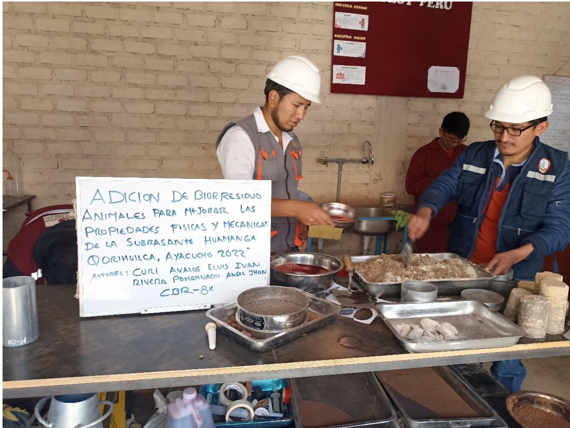
Fotografía N°15: Mezclado del terreno natural (suelo) con biorresiduo animal 8%
