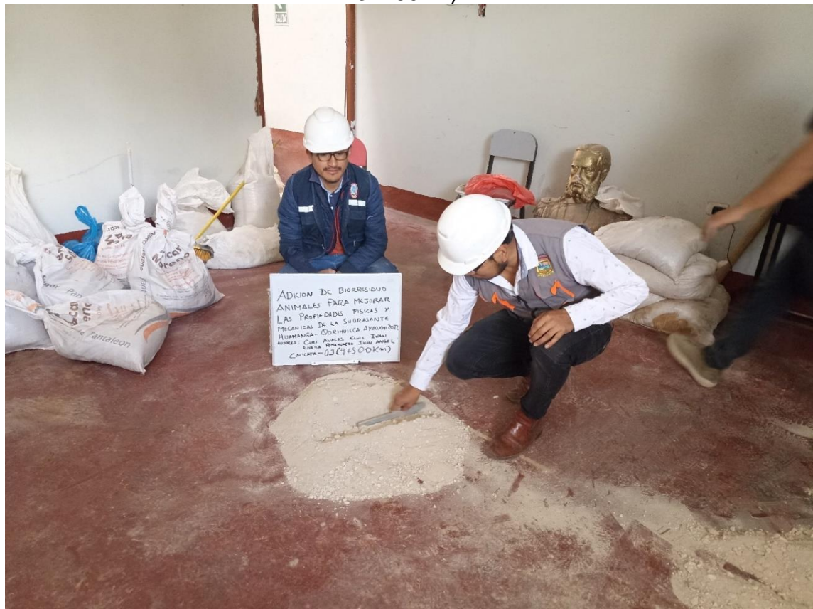
Fotografía N°06: Cuarteo de muestra extraída de la calicata 03 (Prog 4+500km).
