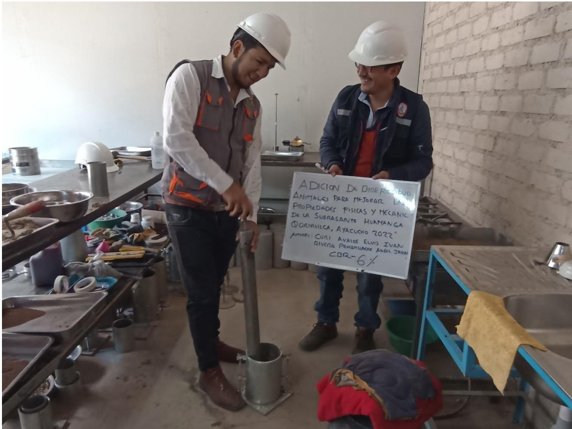
Fotografía N°17: Proceso de compactación de los testigos del terreno natural (suelo) con biorresiduo animal 6% para su evaluación a través del ensayo de CBR.
