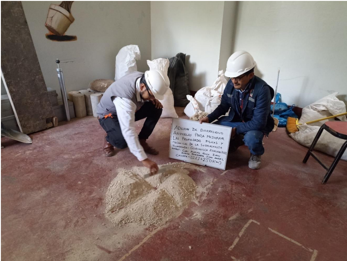
Fotografía N°05: Proceso de cuarteo de muestra extraída de la calicata 02 (Prog 3+250km).
