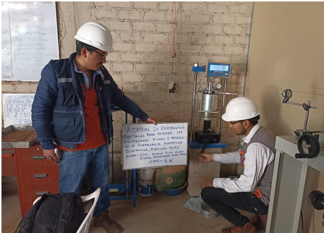
Fotografía N°19: Ensayo de CBR del terreno natural con Adición de Biorresiduos animal (BRA) al 6%.
