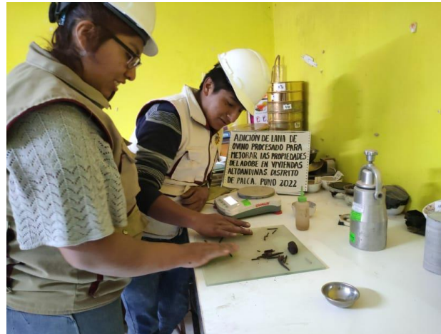
Figura 9. Ensayo de limite plástico
