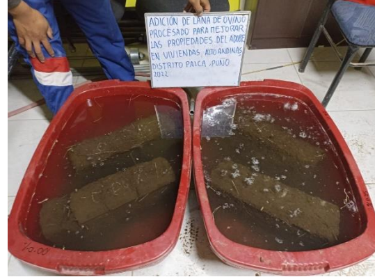
Fotografía 20. Ensayo de absorción
