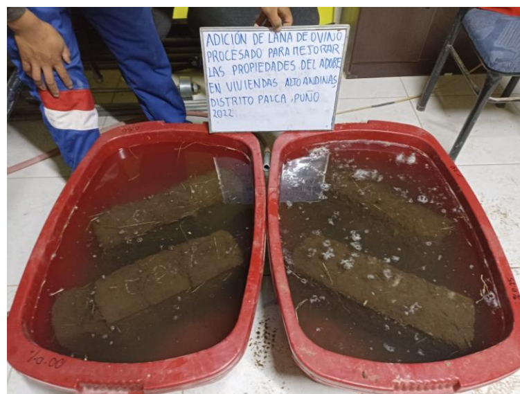
Figura 10. Ensayo de absorción
