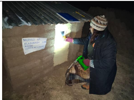
Fotografía 18. Medición de temperaturas
