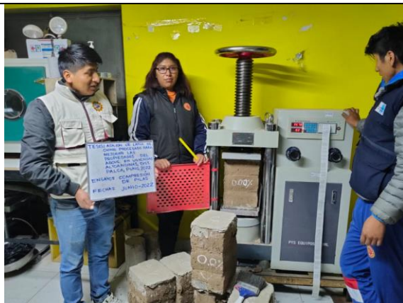
Fotografía 17. Rotura de prismas de adobe
