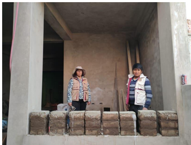
Figura 12. Prismas de adobe para la compresión axial
