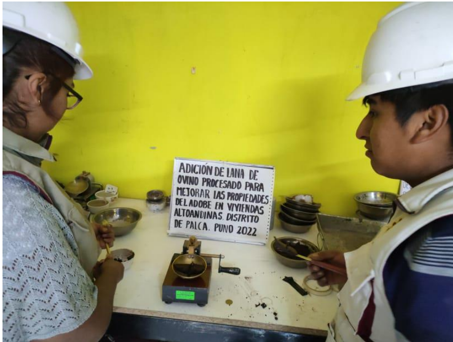
Figura 8. Ensayo de limite liquido
