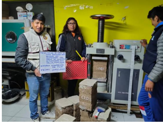
Fotografía 13. Rotura de prismas
