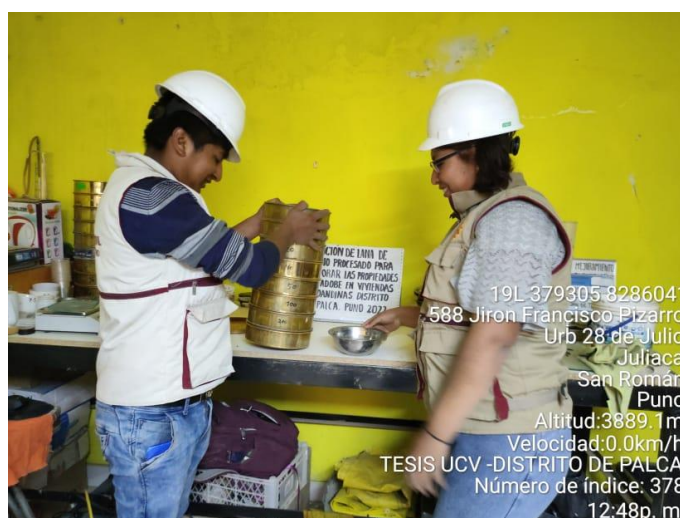
Figura 7. Ensayo de granulometría
