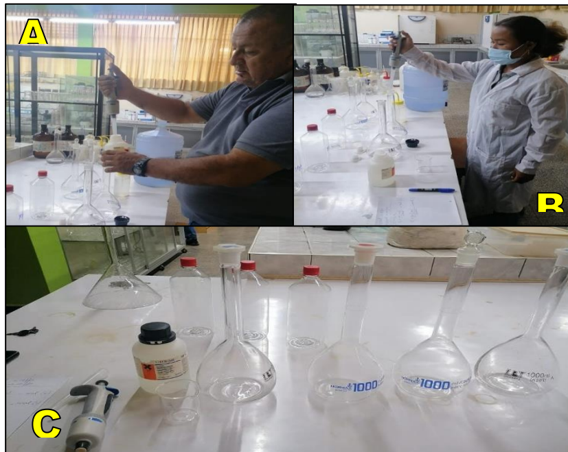
Figura 5. A) Preparación de la solución de plomo 10 mg/kg. B) preparación de la solución de 20 mg/kg. C) instrumentos para la elaboración de las soluciones del plomo(C)
