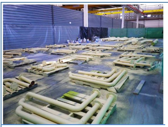
Figura 13. Acopio de Tuberías
