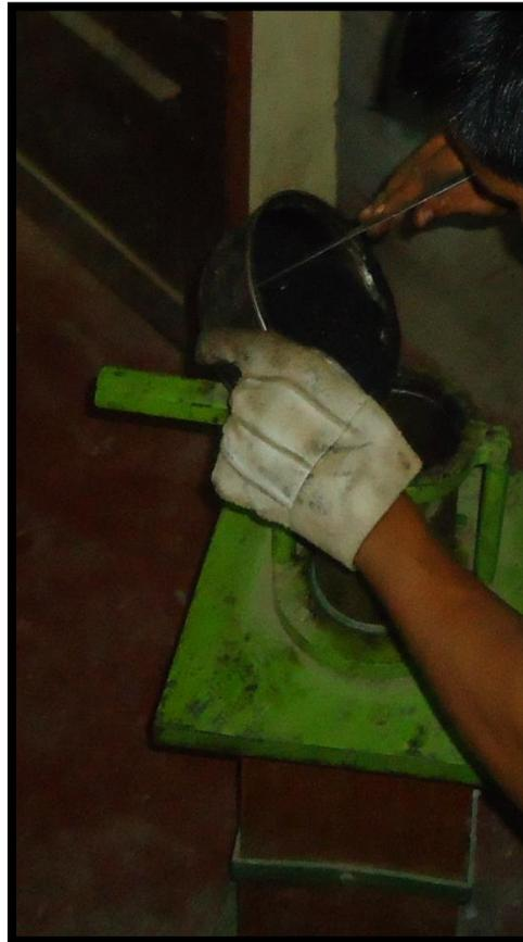
**Fotografía N° 35: Moldeo de la Briqueta**
