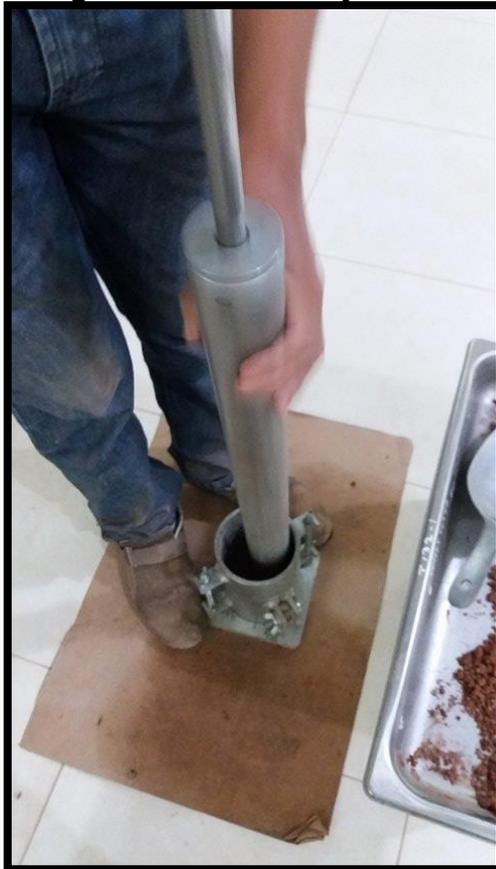
**Fotografía N° 23: Ensayo CBR**
