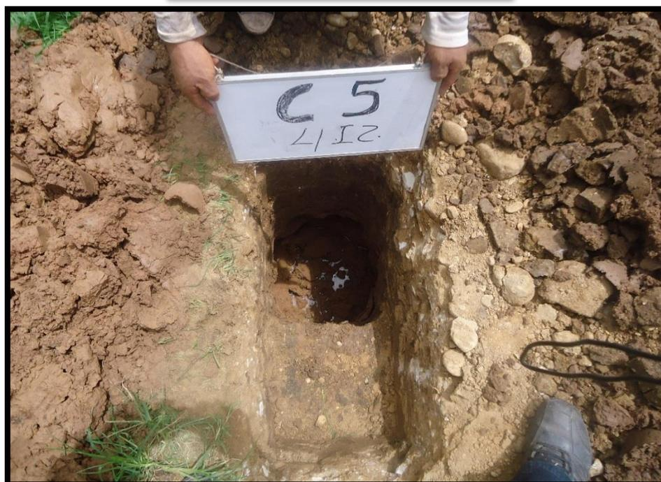
**Fotografía N° 16: Extracción de Muestra Calicata N° 09**
