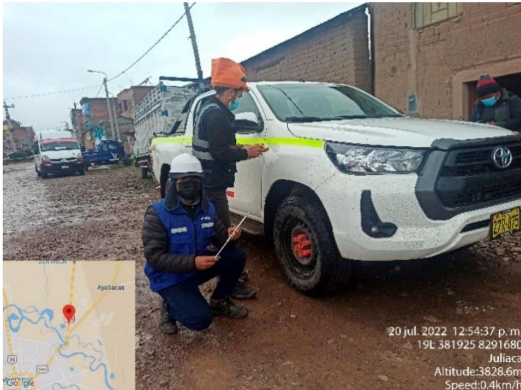
**Figura N° 48:** Medición de presión de llantas de Vehículo – IN SITU
