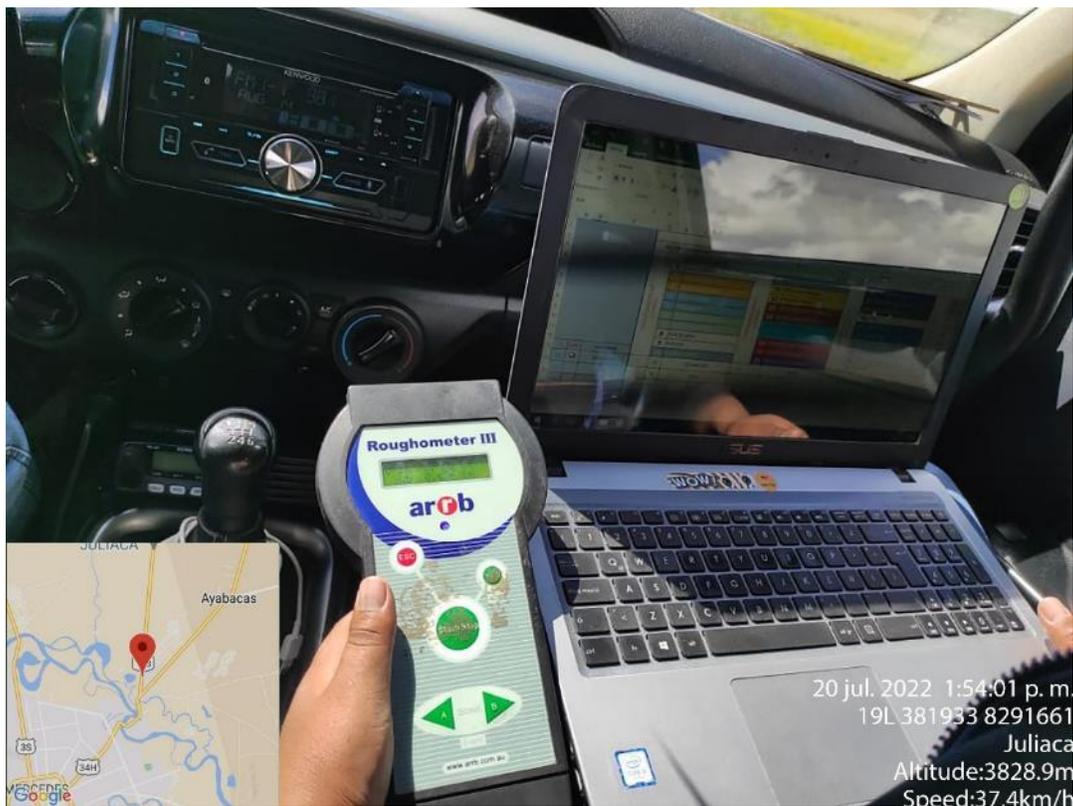
**Figura N° 47:** Toma de datos con el equipo de Rugosímetro III – IN SITU
