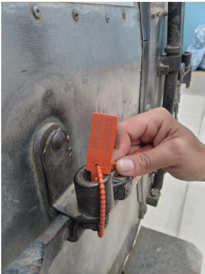
Figura 24. Cerrado de contenedor y colocación de precinto.
