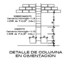
DETALLE DE COLUMNA EN CIMENTACION Escala 1:25
