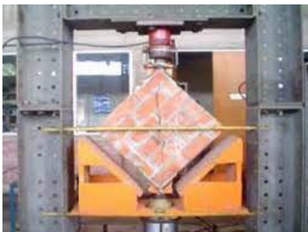
Figura 3. Ensayo de murete
