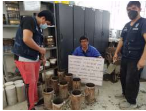
Imagen 22: Realización de las probetas de concreto.
