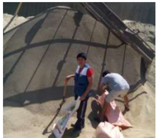
Imagen 42: Recolección de agregado fino de la cantera Santa Delfina.
