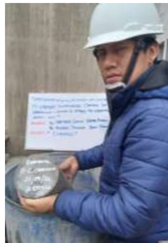
Imagen 24: Curado de probeta de concreto (cenizas de carricillo).
