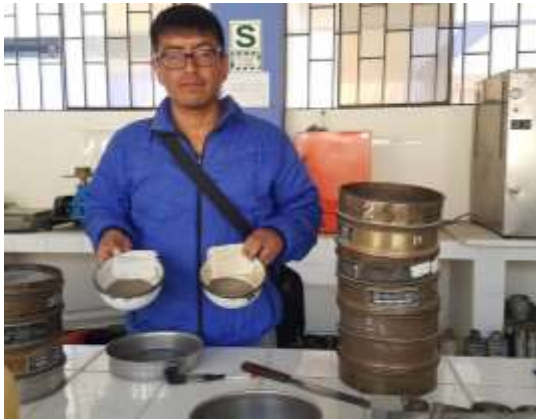
Imagen 45: Muestreo de las cenizas de CC y CHE.
