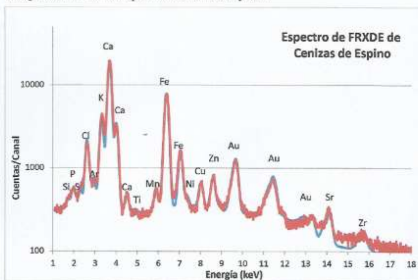
Figura 1. Espectro de FRXDE de la muestra de ceniza de espino en escala semilogarítmica. El espectro experimental se muestra en curva de color rojo y el calculado en curva de color azul. Se observan los picos de los rayos-X de argón del aire y de oro que provienen de la fuente de rayos-X.
