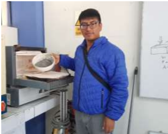
Imagen 47: Muestras llevadas a la mufla para activarlas.
