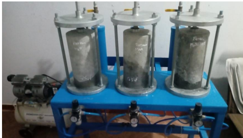
Realización del ensayo de permeabilidad del concreto
