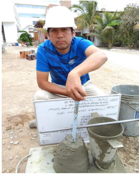
Medición de asentamiento de la mezcla de concreto
