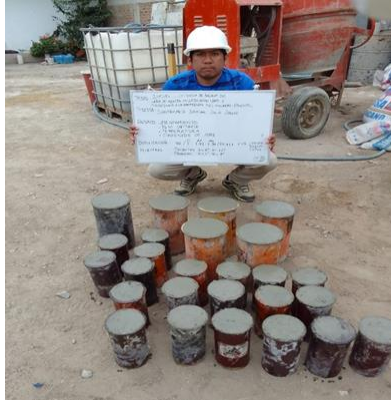
Colocación de la mezcla de concreto en moldes
