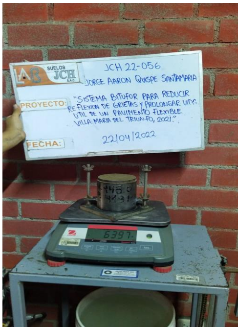
Figura n°16 ensayo de Proctor
