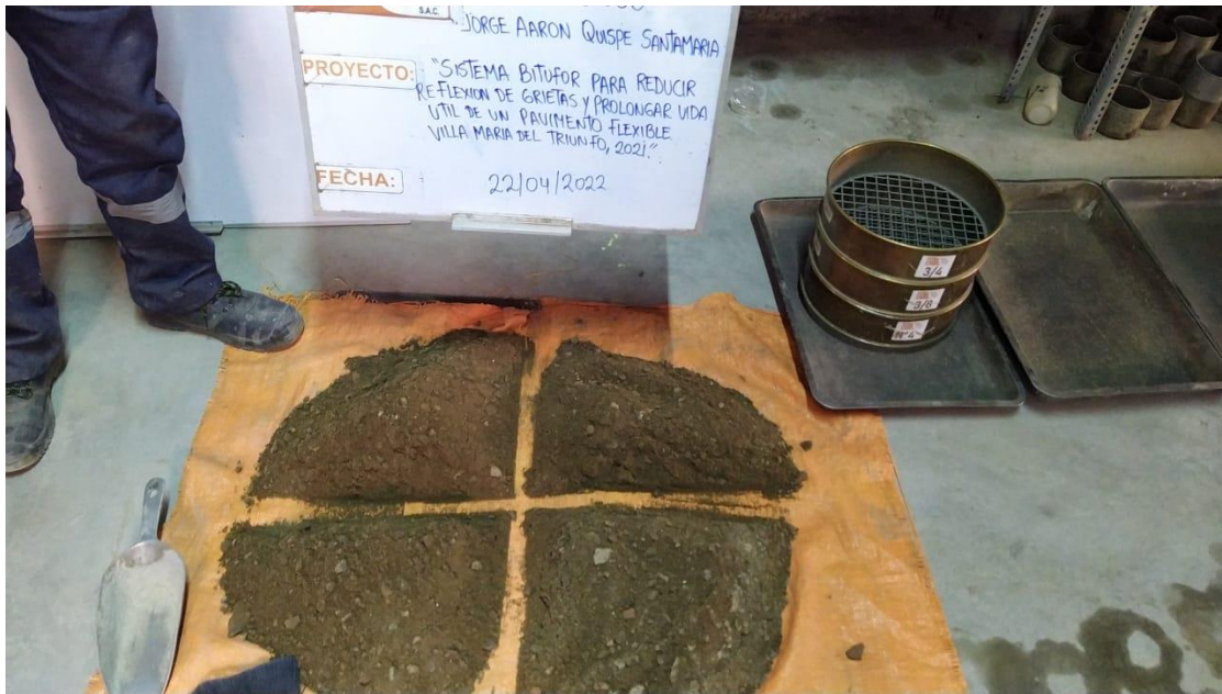
Figura n°14 cuarteo de muestra
