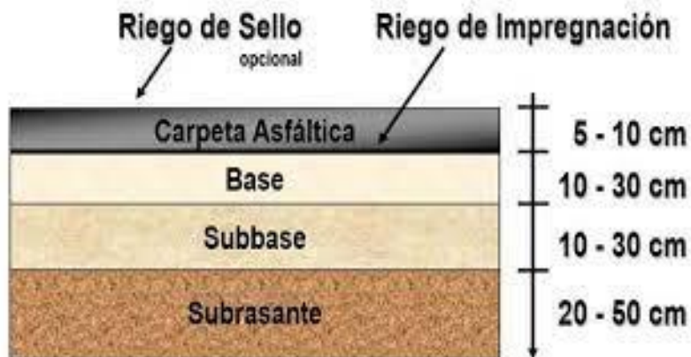
Figura n°10 composición de un pavimento flexible
