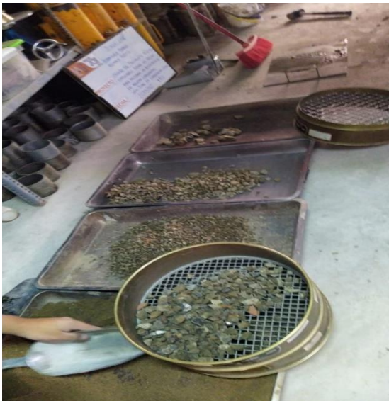
Figura n°15 separación por tamizado
