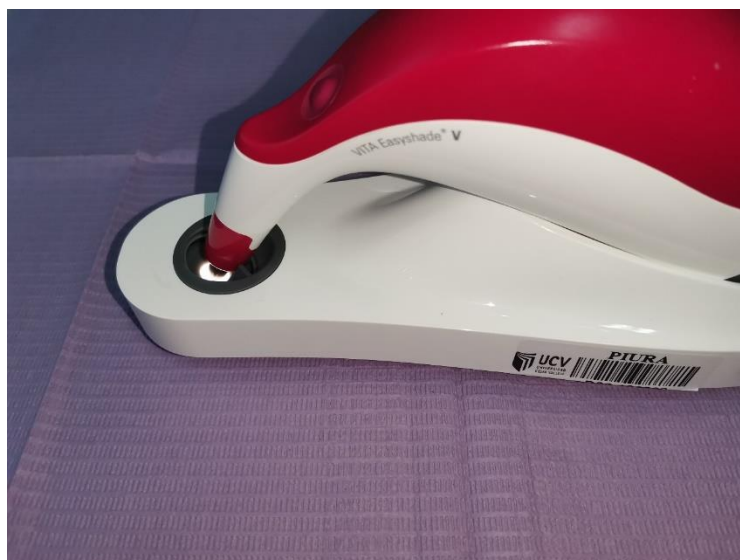
Figura 10. Calibración del espectrofotómetro
