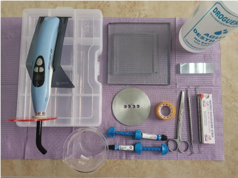
Figura 1. Materiales para fabricación de los discos de resina.
