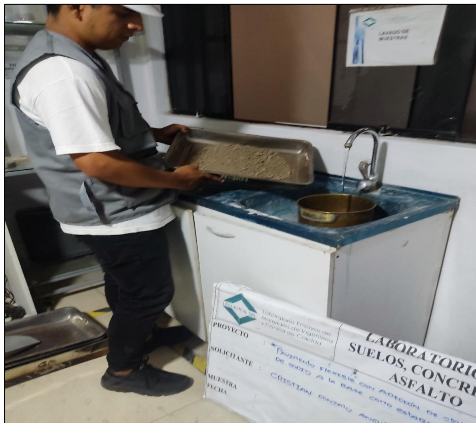
IMAGEN 4: Lavado del material por la malla #200
