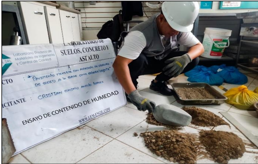
Figura 10. Cuarteo de material
