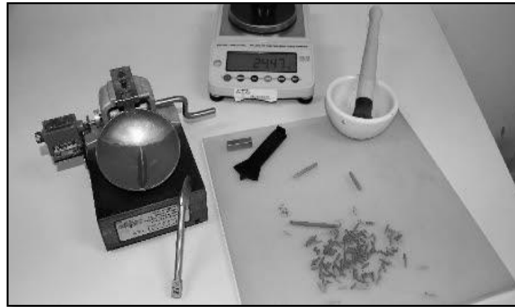
Figura 7. Ensayos de límites de atterberg
