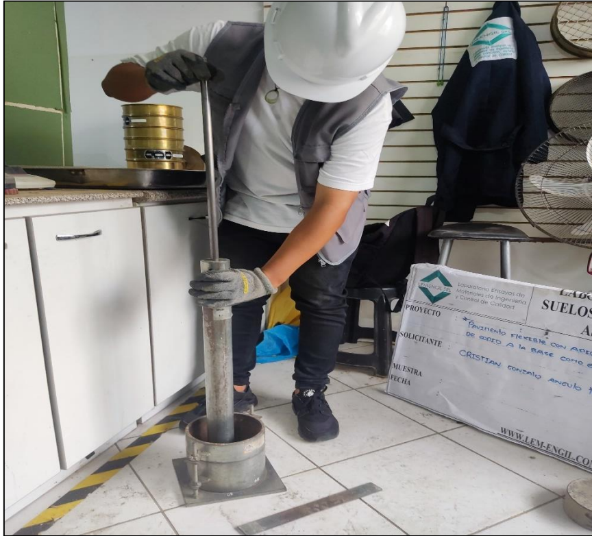
IMAGEN 9: Compactación con pisón para Proctor modificado
