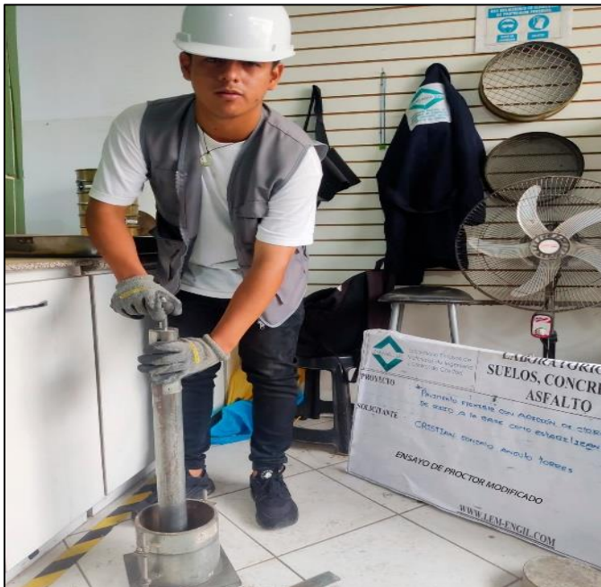
Figura 17. Compactación de a muestra
