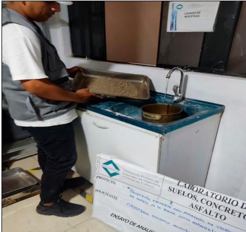
Figura 13. Lavado de la muestra
