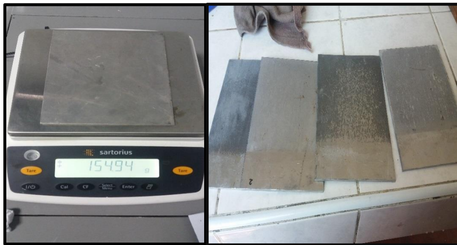
Figura 18. Pesado de los electrodos de Aluminio
