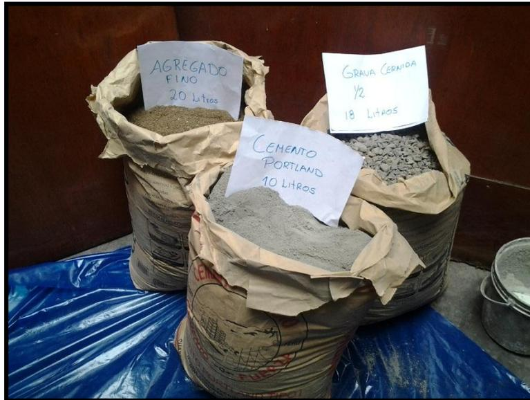
Figura 6. Material para preparación de mezcla para FBA
