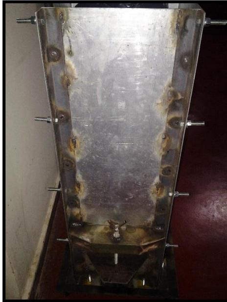
*Figura 5. Molde de acero galvanizado.*
