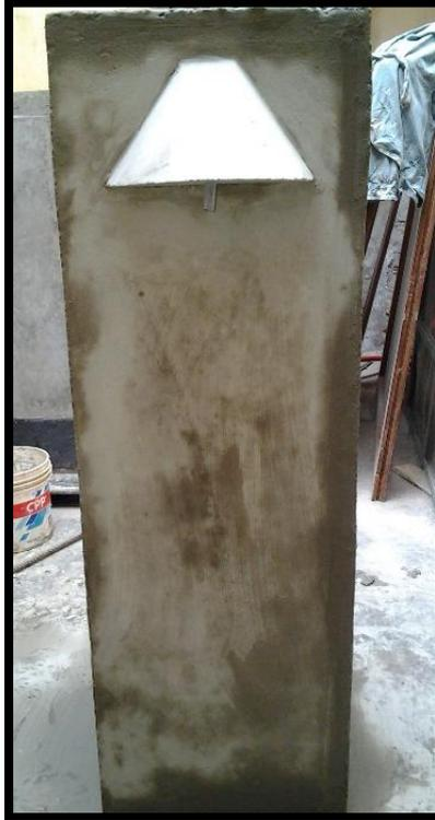
*Figura 13. Curado con Sika y cemento.*
