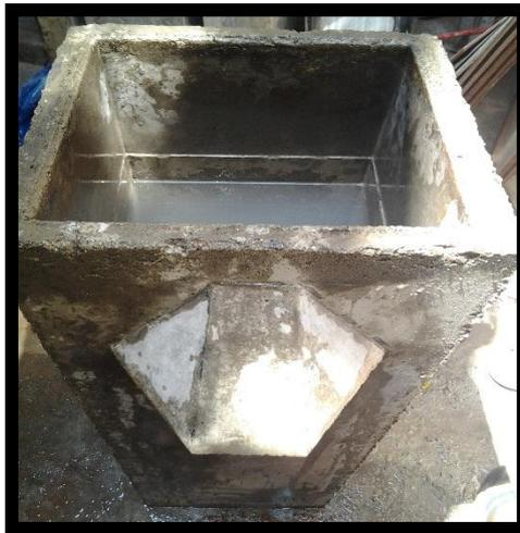
Prueba Hidráulica, curación del filtro con agua por 3 días
