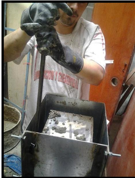
*Figura 11. Ayudo a mezclar el concreto para sacar el aire acumulado.*
