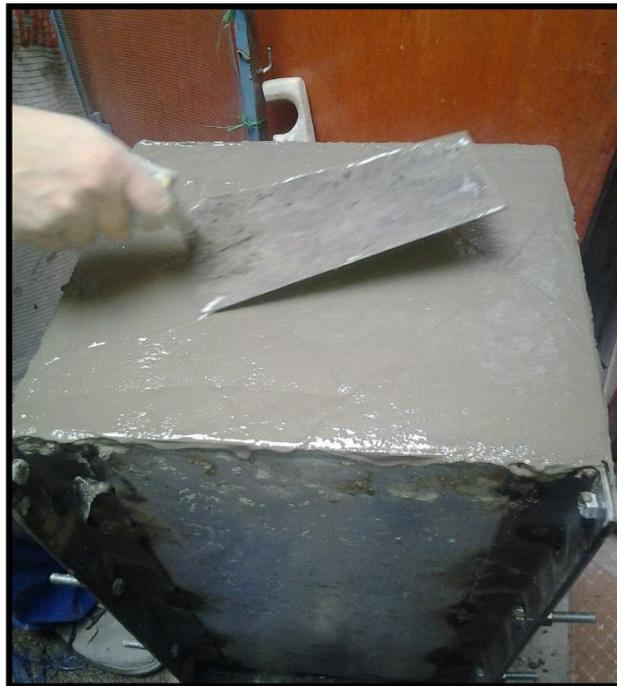
Termino de vaciado del hormigón en placa de acero
