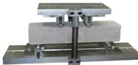
Figura 7: Esquema típico de instalación del espécimen, para el ensayo del concreto por flexión.
