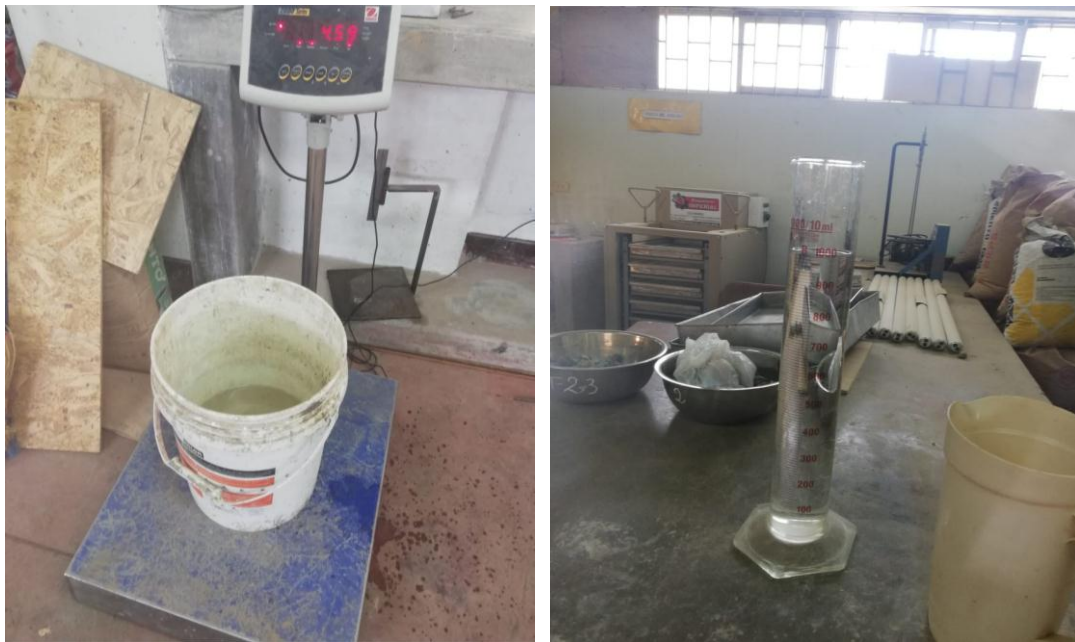
Figura 20: Peso y proporciónamiento de los componentes del concreto.
