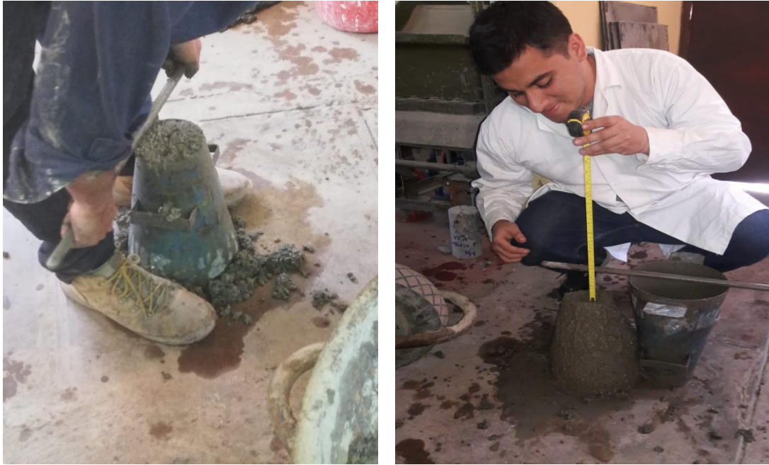
Figura 22: Medida del asentamiento o fluidez de la mezcla.
