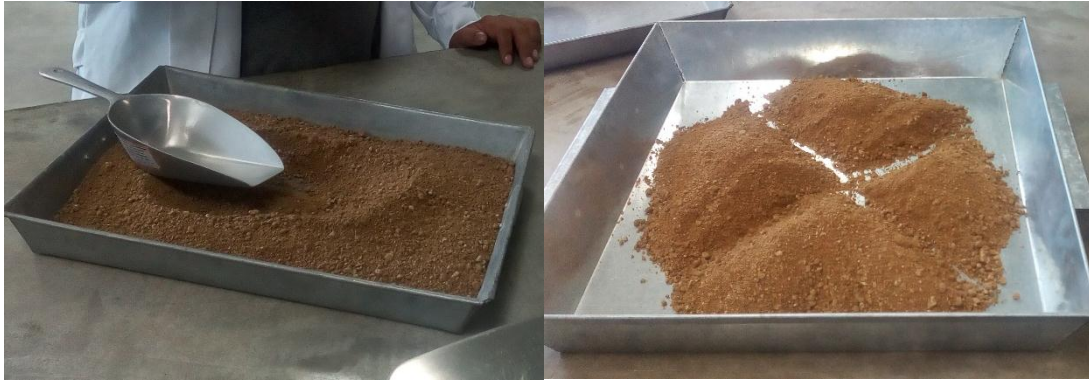
Figura 15: Agregado fino usado para el diseño de mezclas.
