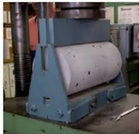
Figura 25: Curado de las muestras del concreto cilindros y ensayo a tracción.
