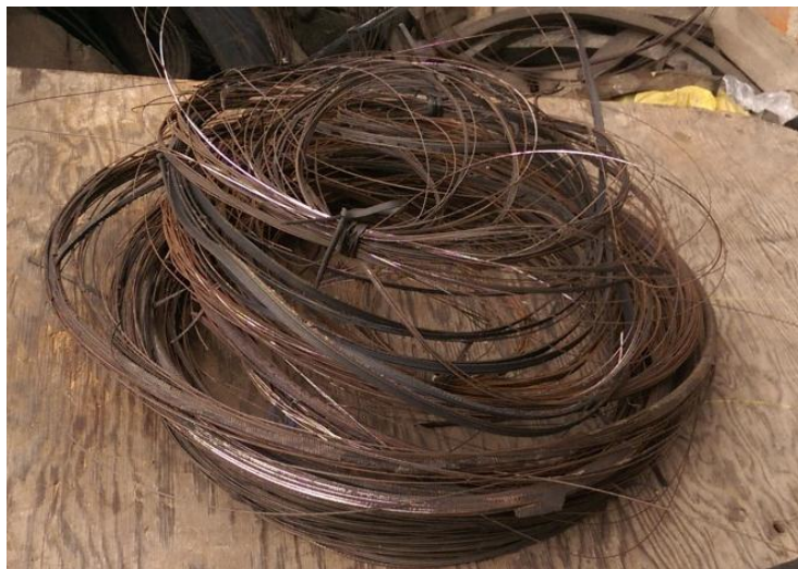
Figura 3: Grupo de fibras de acero removidas de los bordes interiores de un neumático reciclado.
