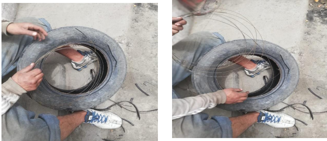
Figura 19: Extracción de las fibras de acero como alambres
