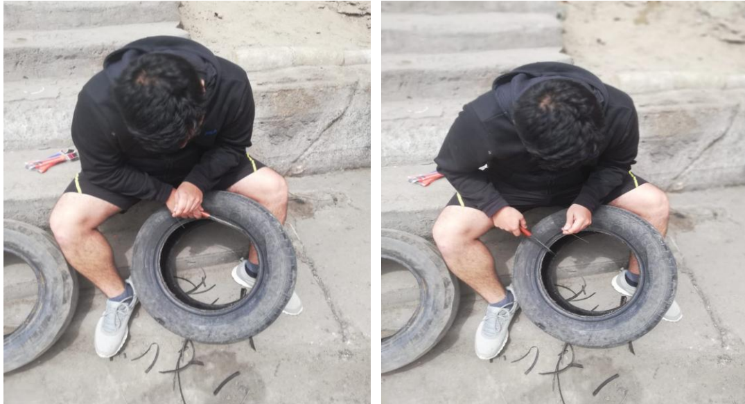
Figura 18: Método de extracción de las fibras de acero de neumáticos de desecho.
