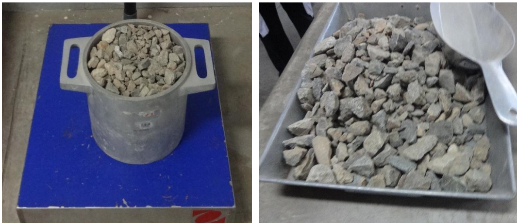
Figura 12: Agregado grueso usado en el diseño de mezclas
