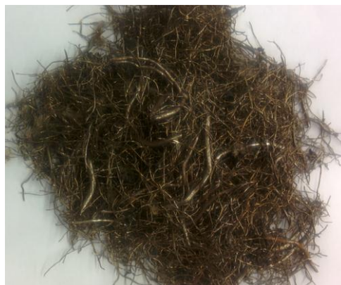
Figura 2: Fibras de acero obtenidas de neumáticos de desecho
