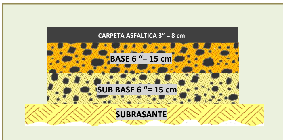
Figura 11. Sección del pavimento flexible.
