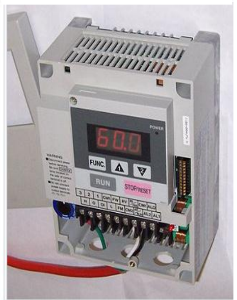
Tipo de variador de frecuencia
