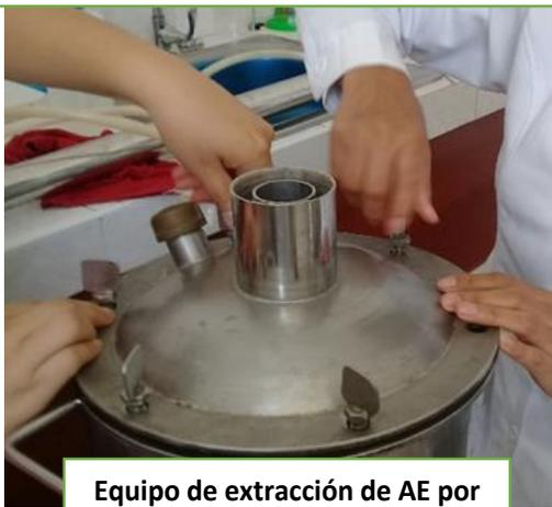
Equipo de extracción de AE por arrastre de vapor de agua
