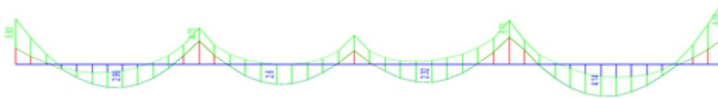
$$M_{t_1} := 2990 \text{ kgf} \cdot \text{m} \quad M_{t_2} := 2600 \text{ kgf} \cdot \text{m} \quad M_{t_3} := 2320 \text{ kgf} \cdot \text{m} \quad M_{t_4} := 4140 \text{ kgf} \cdot \text{m}$$
