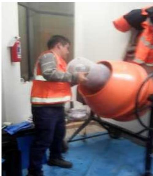
**Figura 31.** Incorporación del agregado grueso en el 2do Diseño
