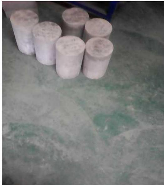
*Figura 39. Probetas para ensayar a los 14 días
