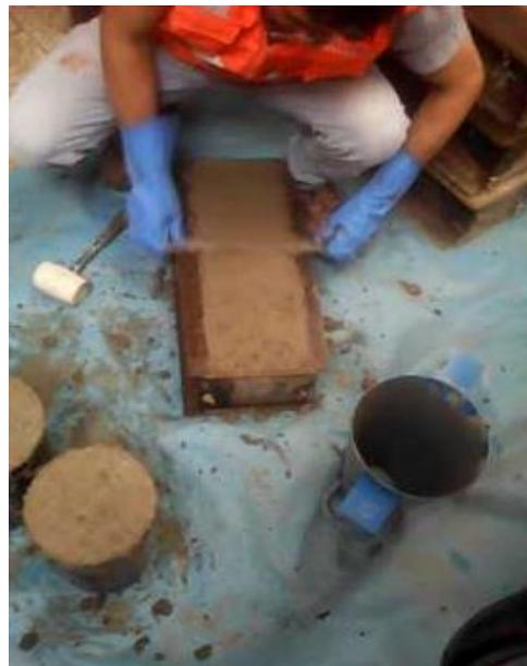
*Figura 30. enrazado de la probeta prismática del 1er diseño*
