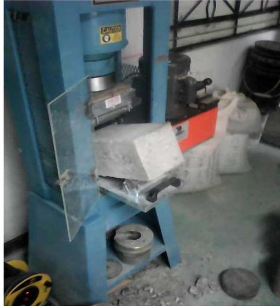
*Figura 49. Rotura a flexión 2da viga de Diseño 300 kg/cm<sup>2</sup>*
