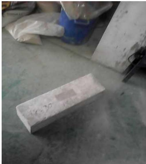
**Figura 46.** *Probeta Prismática de Diseño a 300 kg/cm<sup>2</sup>*
