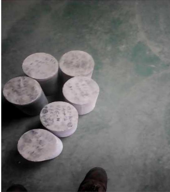
*Figura 42. Probetas a ensayar a los 28 días de los 2 Diseños*
