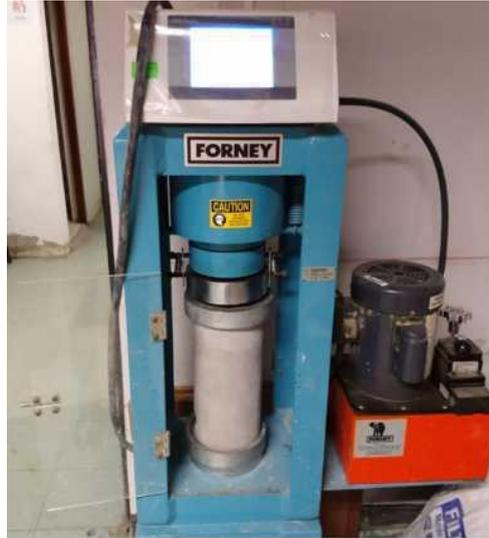
*Figura 38. Rotura a los 7 días probeta cilíndrica,
