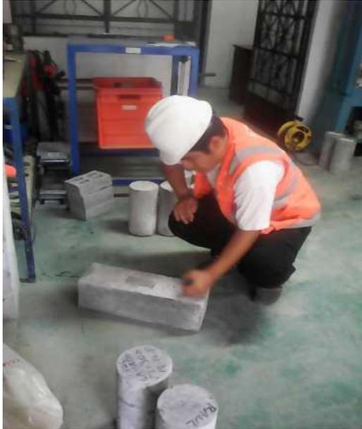
**Figura 45.** *Probeta Prismática de Diseño a 280 Kg/cm<sup>2</sup>*
