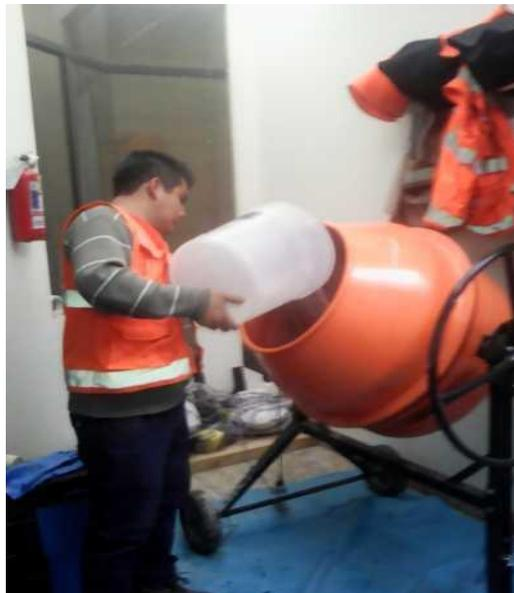
*Figura 33. Incorporación del agua en el 2do Diseño*
