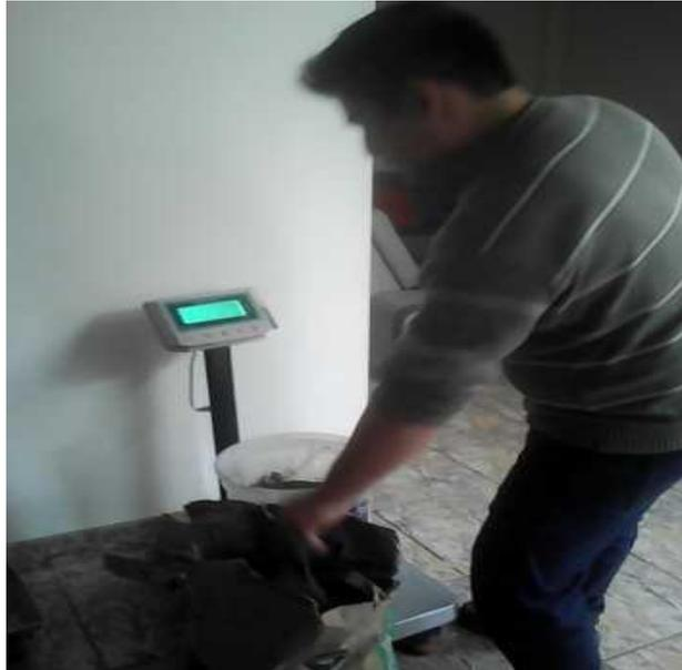
*Figura 23. Dosificación de Cemento en el 1er Diseño*
