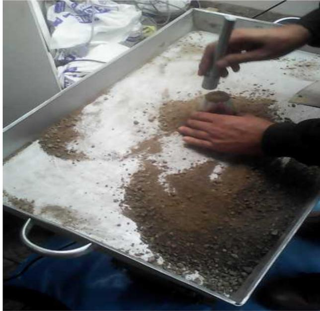
*Figura 18. Ensayo de Absorción del agregado Fino*
