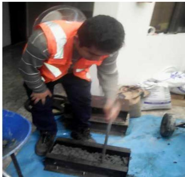
*Figura 35. Varillar 25 golpes por cada capa ,2do Diseño*
