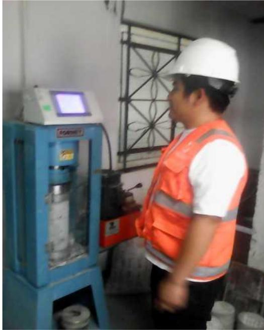
*Figura 44. Rotura a compresión a los 28 días del
