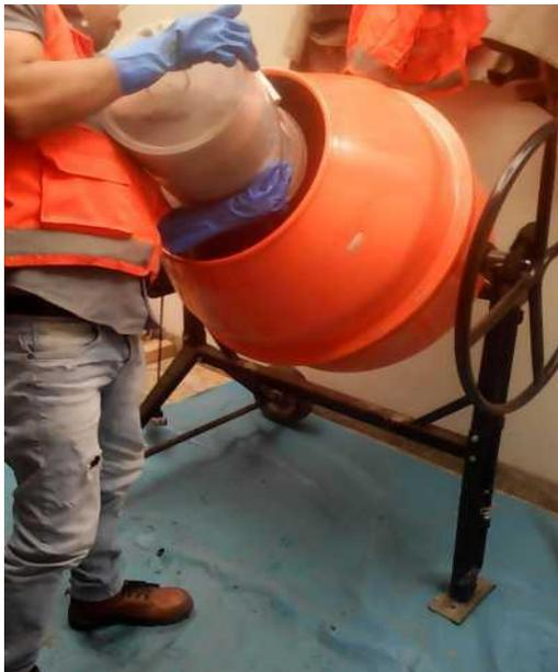
*Figura 28. Incorporación del agregado Fino*
