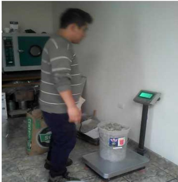
**Figura 20.** Dosificación del agregado grueso en el 1er Diseño
