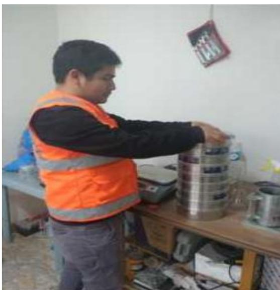
*Figura 14. Ensayo de Granulometría del agregado Grueso*
