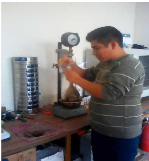
*Figura 19. Peso Específico del Agregado fino*
