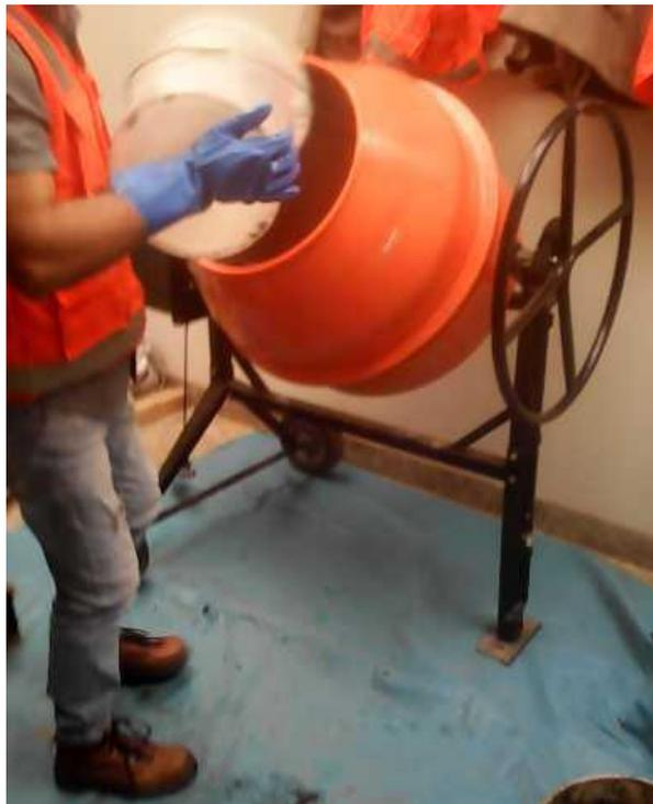
*Figura 26. Incorporación del cemento*
