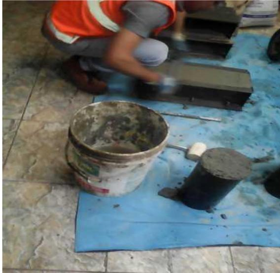
*Figura 36. Enrazada probeta prismática, 2do Diseño*
