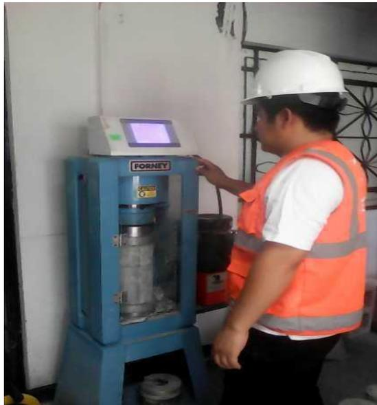
*Figura 43. Rotura a compresión a los 28 días del Diseño a 280 kg/cm<sup>2</sup>*
