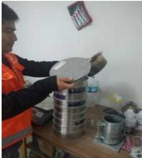
**Figura 16. Tamizado del Agregado Fino**
