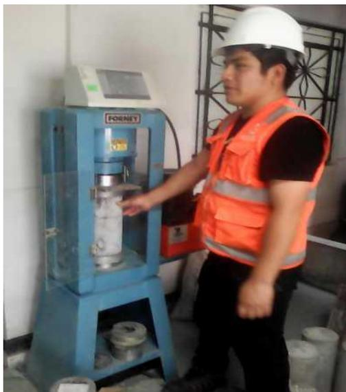
*Figura 40. rotura a compresión a los 14 días del
