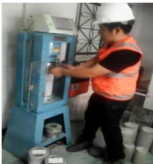
*Figura 41. Rotura a compresión a los 14 días del
