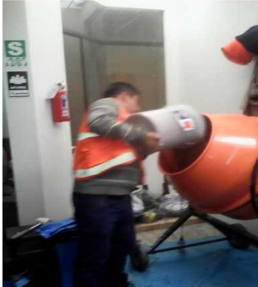
*Figura 34. Incorporación del Agregado Fino en el 2 do Diseño*
