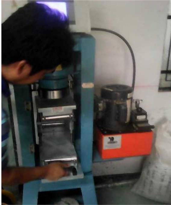
*Figura 47. Incorporación de la pieza para el ensayo a flexotracción*
