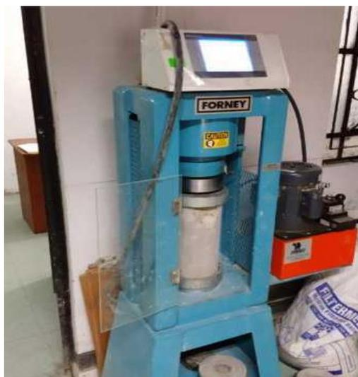
*Figura 37. Rotura a los 7 días probeta cilíndrica, 1er Diseño*
