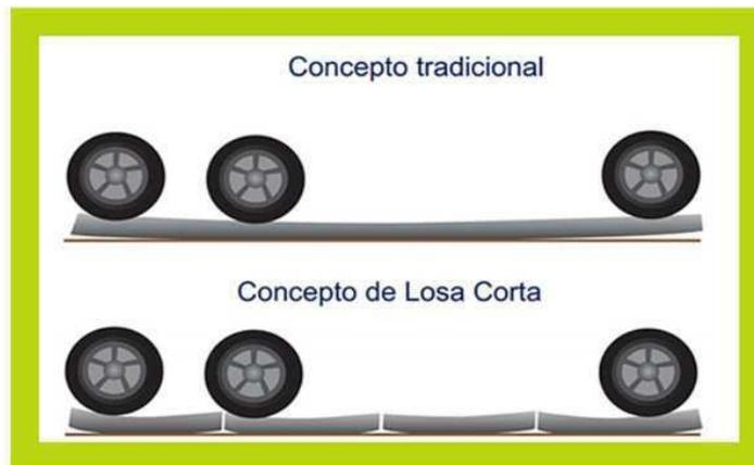
**Figura 8.** Método Constructivo de losas Cortas
