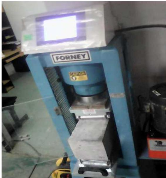
*Figura 48. Rotura a flexión de 1 era viga de Diseño 280 kg/cm<sup>2</sup>*
