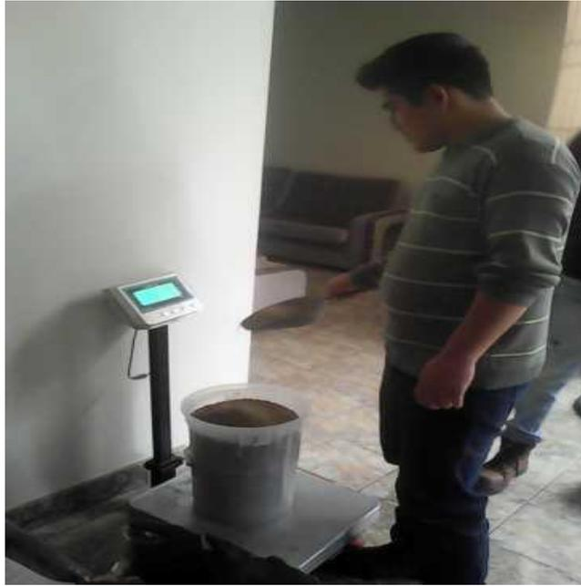
*Figura 21. Dosificación del agregado fino en el 1er Diseño*
