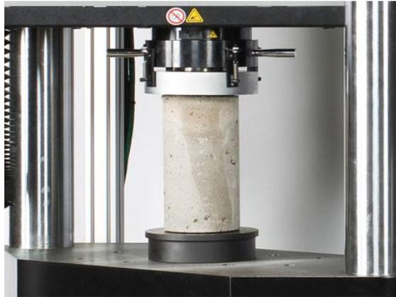
*Figura 1.5.* Estudio de resistencia a compresión (fuente personal)
