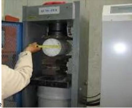
*Figural.6.* Experimento de fuerzas a la tracción por compresión diametral (f. p.)
