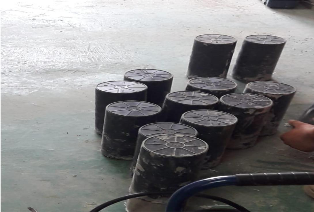
FOTO C.8 colocando la muestra para el experimento de resistencia a compresión.
