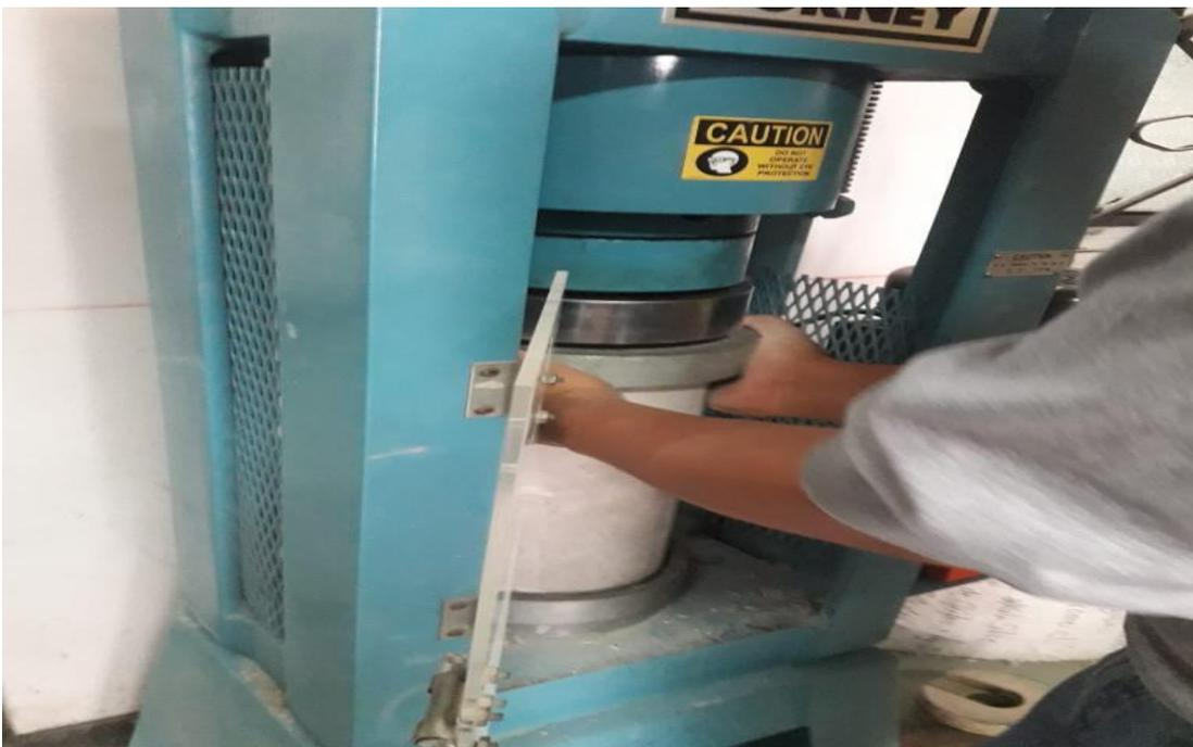
FOTO C.9 Ensayando las probetas quemadas a resistencia a tracción por compresión diametral.
