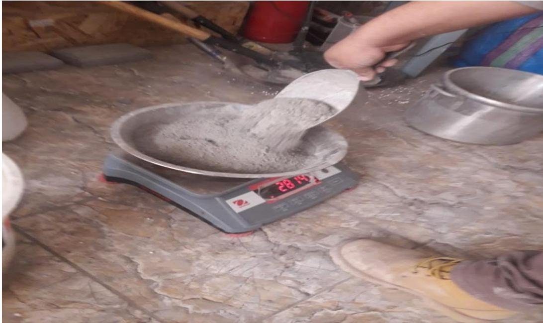
FOTO C.6 Pesando el agregado fino.
