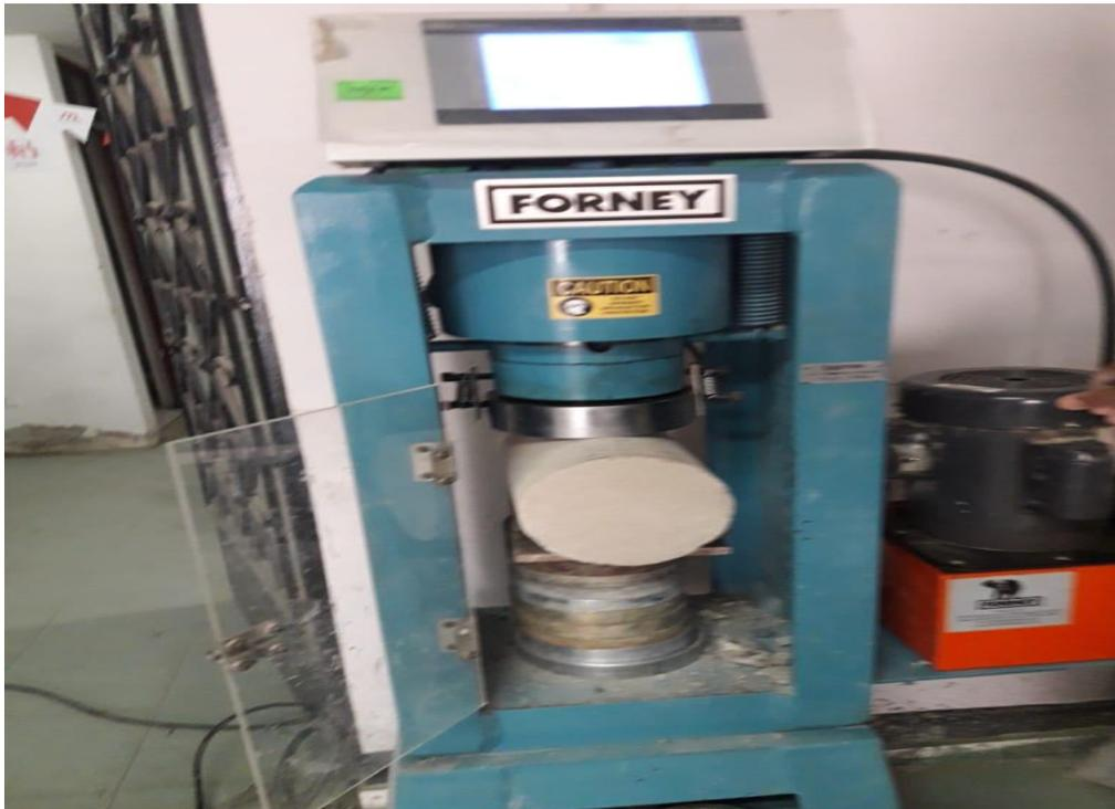
FOTO C.4 Ensayando las muestras patron para la resistencia a compresion.
