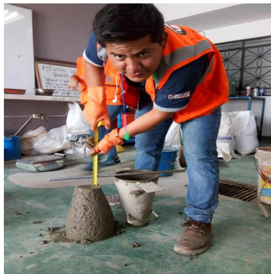
Figura 16: Asentamiento del concreto patrón Fuente: propia elaboración
