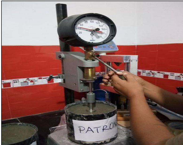
Figura 31: Ensayo del tiempo de fraguado, concreto patrón Fuente: propia elaboración
