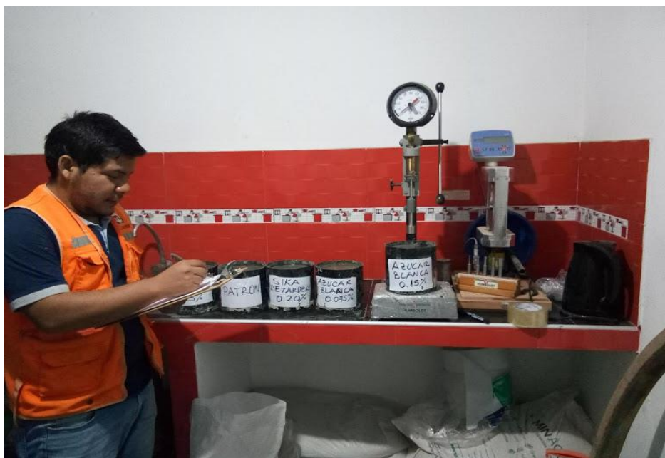
Figura 30: Finalización de llenado de moldes por cada dosificación Fuente: elaboración propia
