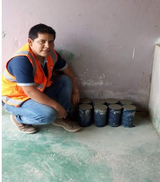
Figura 17: Llenado de probetas del concreto patrón
