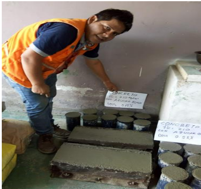
Figura 26: LLenado de probetas de concreto con azúcar Fuente: propia elaboración
