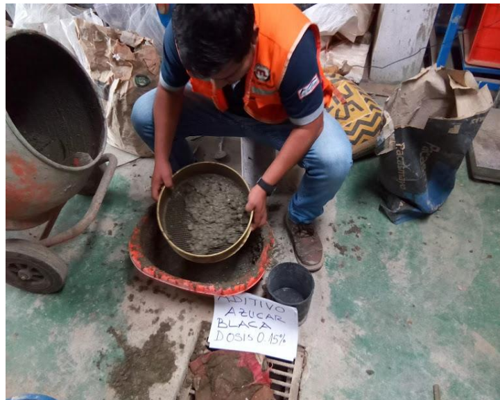
Figura 29: Tamizado del concreto con azúcar blanca 0.15% sobre la malla #4 Fuente: propia elaboración
