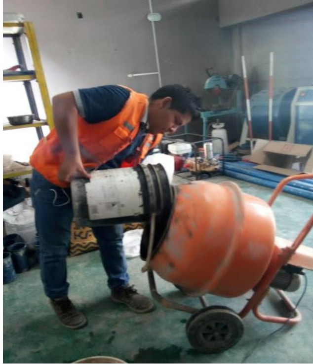
Figura 25: Mezcla del concreto con azúcar Fuente: propia elaboración
