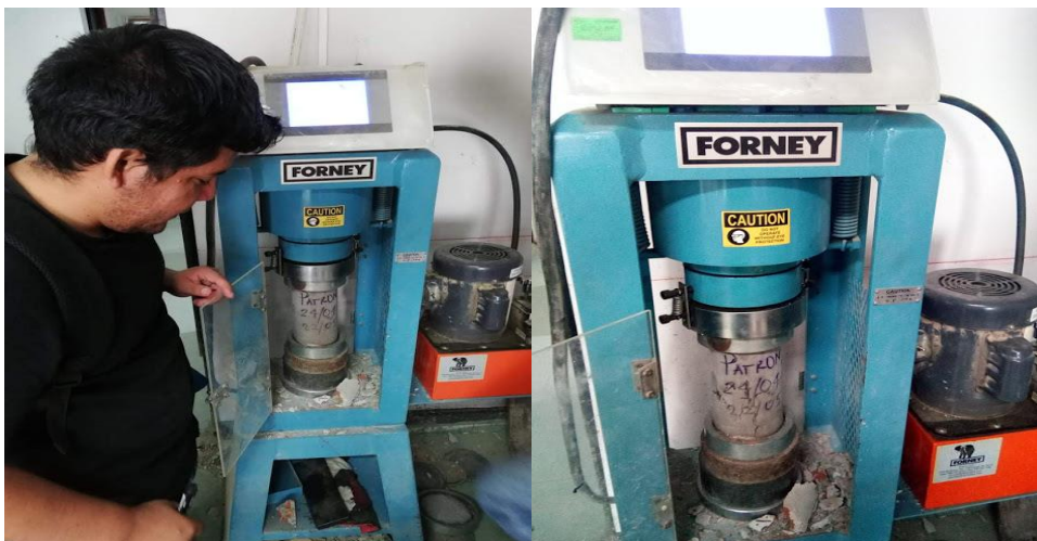
Figura 35: Rotura del concreto patrón Fuente: propia elaboración
