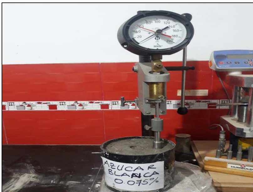
Figura 32: Ensayo del tiempo de fraguado, con azúcar blanca 0.075% Fuente: propia elaboración
