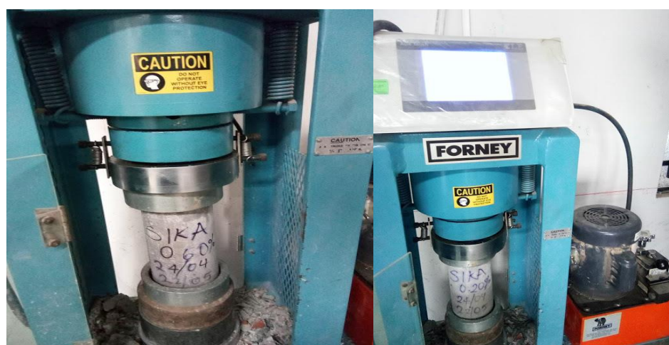
Figura 37: Roturas de probetas con aditivo sika retarder pe Fuente: propia elaboración
