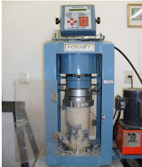
Figura 5: Prensa hidráulica para la resistencia a compresión. Fuente: (Google/Imágenes)
