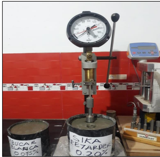
Figura 33: Ensayo del tiempo de fraguado, con sika retarder pe 0.20% Fuente: propia elaboración
