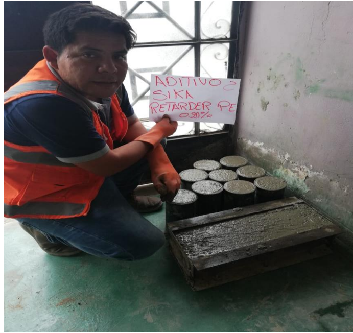
Figura 21: Vaciada de probetas sika retarder pe 0.20% Fuente: propia elaboración
