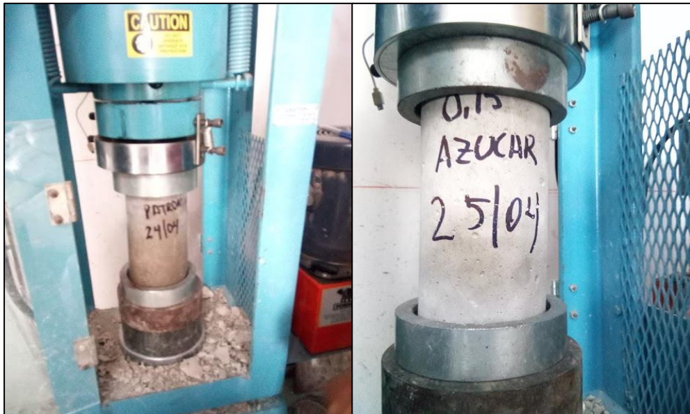
Figura 34: Roturas de probetas para determinar su resistencia Fuente: propia elaboración
