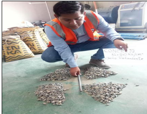
Figura 8: Agregado grueso, cuarteo de la muestra
