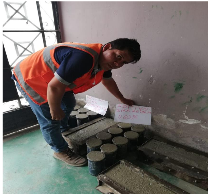
Figura 22: Vaciada de probetas sika retarder pe 0.60% Fuente: propia elaboración
