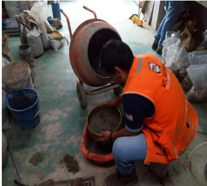
Figura 27: Tamizado del concreto patrón sobre la malla #4
