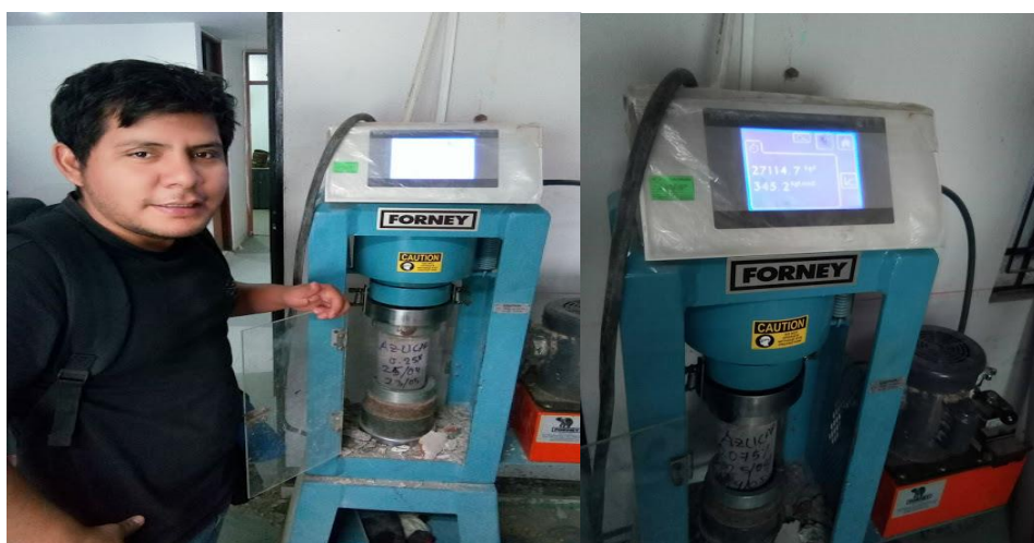
Figura 36: Roturas de probetas del concreto con azúcar Fuente: propia elaboración
