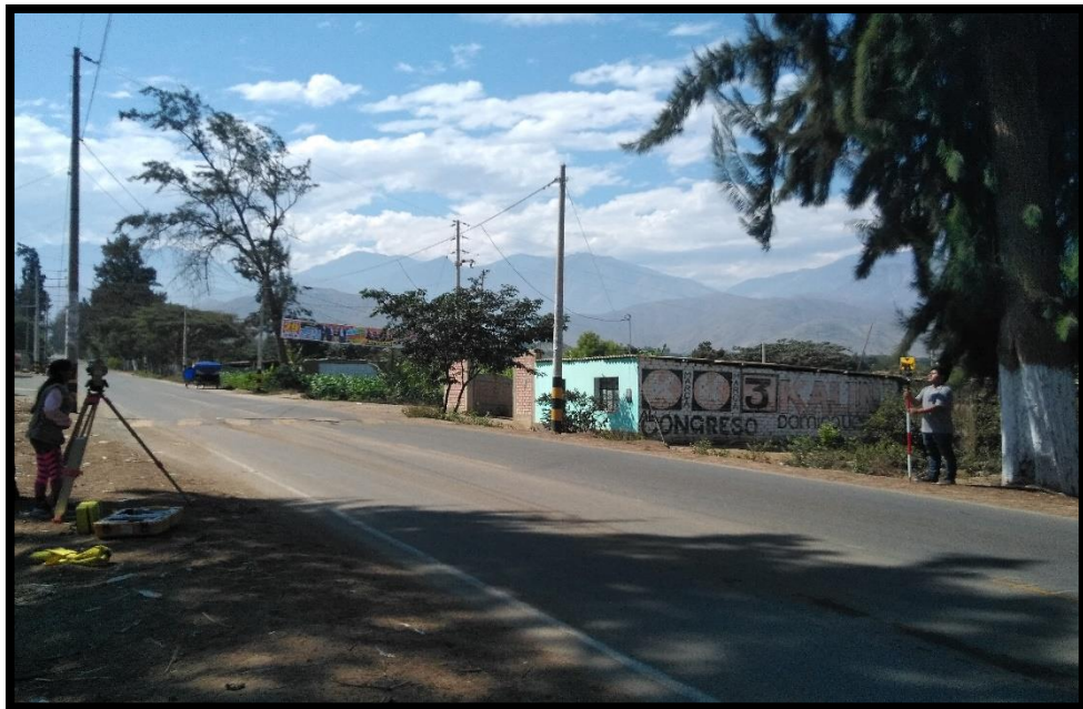
Ilustración N°04: Se observa la toma de punto BM.
