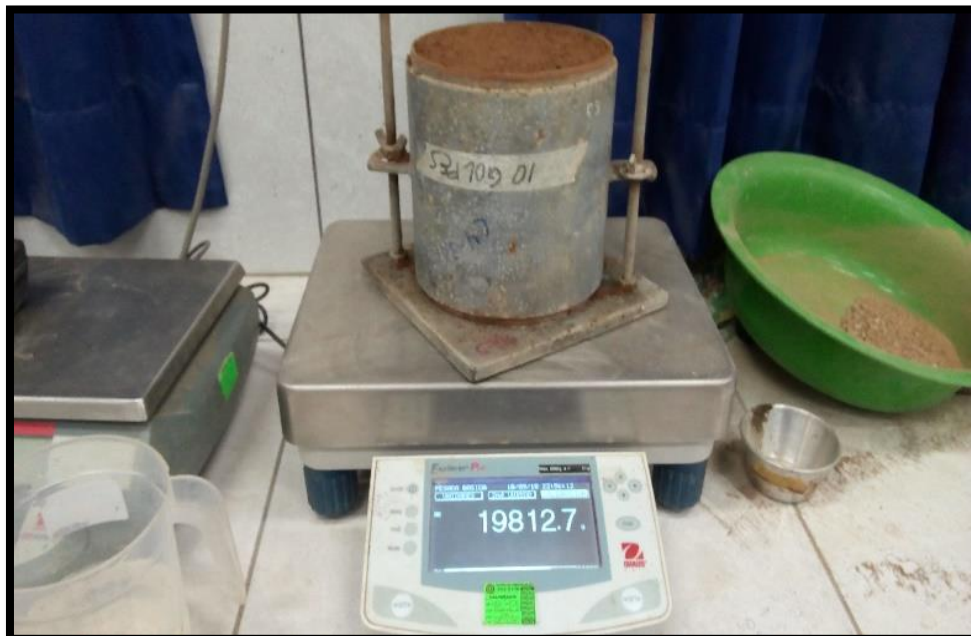
Ilustración N°28: Peso del molde con muestra compactada.
