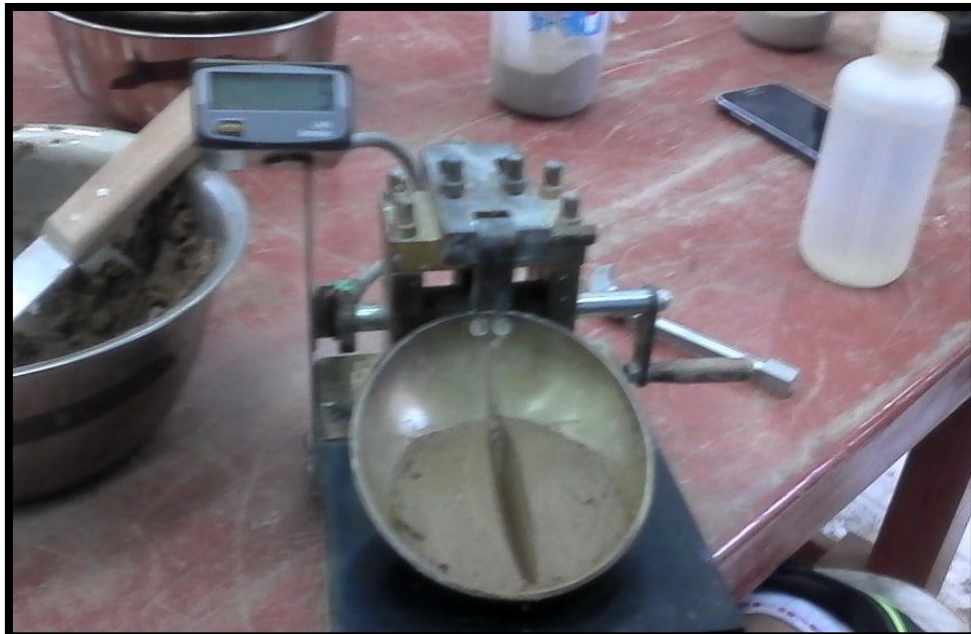
Ilustración N°16: Se agrego 200ml de agua cerrándose en 8 golpes.
