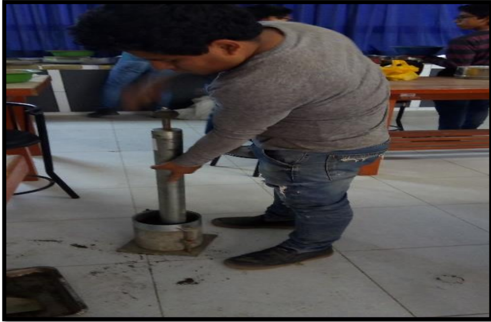
Ilustración N°27: Compactación de la muestra con pistón 10 golpes para la primera muestra.
