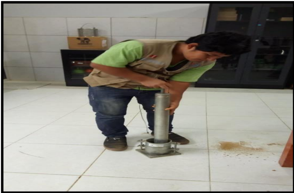
Ilustración N°20: Compactación con el pistón 10 golpes.
