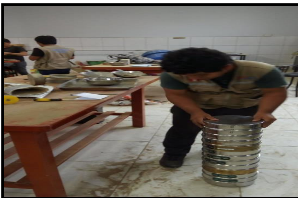
Ilustración N°12: Se tamizó la muestra en las mallas N°1 3/4 1/2 3/8 1/4 N°4 N°10 N°16 N°40 N° 100 N° 200 y fondo
