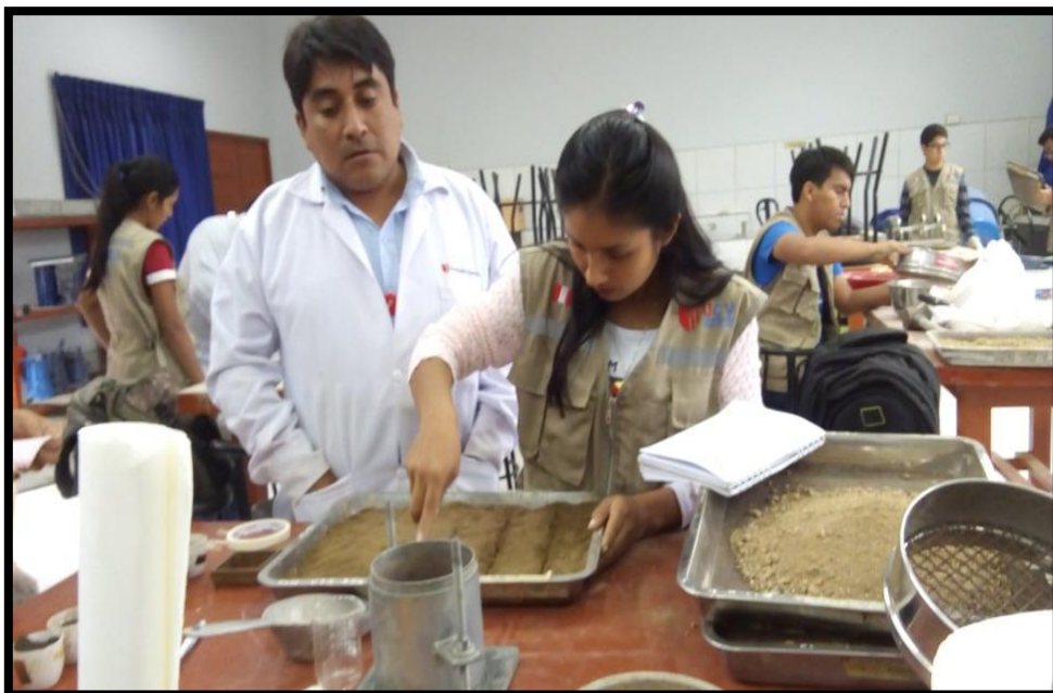
Ilustración N°18: Se parte en 5 dimensiones iguales luego de haber proporcionado 180ml de agua.
