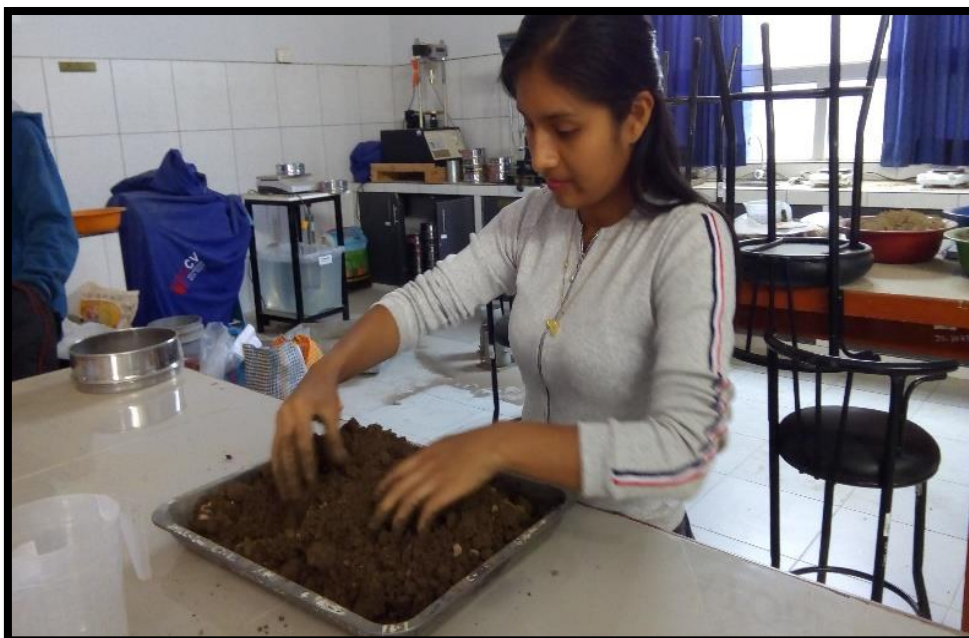
Ilustración N°24: Mezclado de la muestra con agua para la división en 5 partes.
