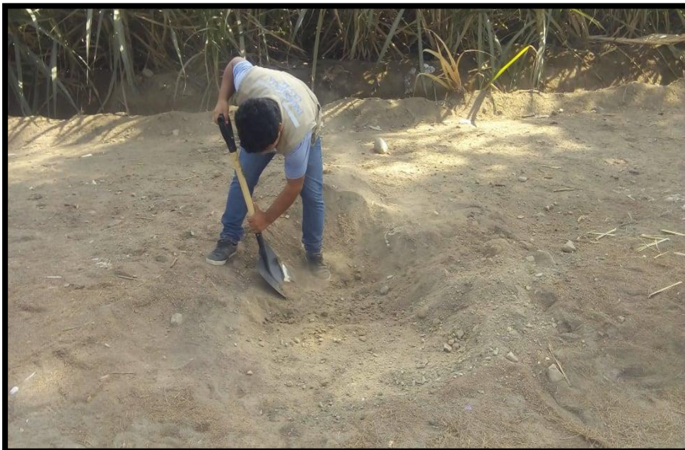
Ilustración N°06: Comienzo de la primera calicata a una profundidad de 1.50m
