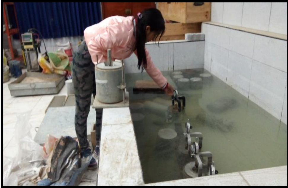
Ilustración N°29: Colocación de los moldes CBR puestos en agua por 4 días.
