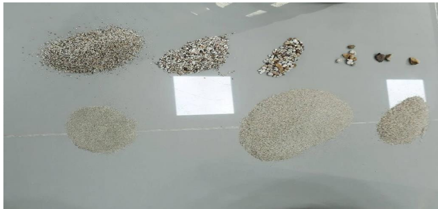
Figura N° 13: Laboratorio de ingeniería civil de la universidad cesar vallejo, Muestras separadas por tamices, 2018.
