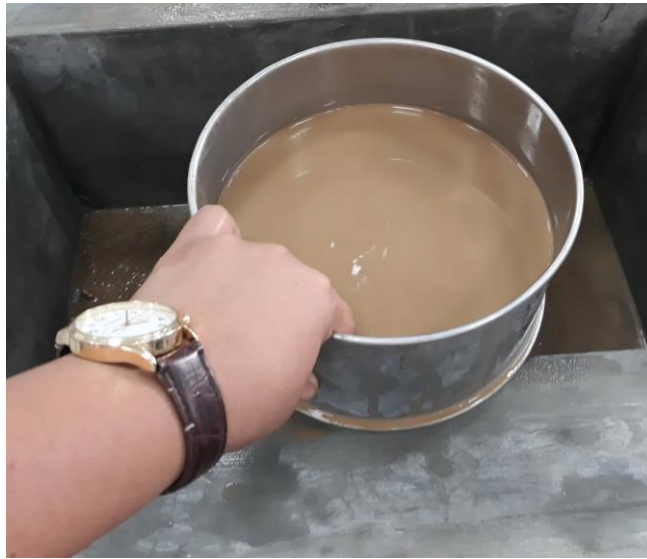
Figura N° 11: Laboratorio de ingeniería civil de la universidad cesar vallejo, Lavado de muestra, 2018.
