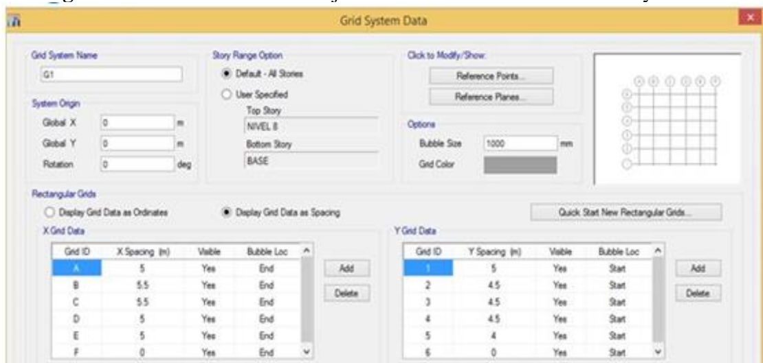
Figura N° 104: Edición de los Ejes del modelo en la dirección “X” y “Y”.
