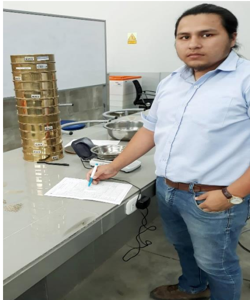
Figura N° 12: Laboratorio de ingeniería civil de la universidad cesar vallejo, Granulometría por tamices, 2018.
