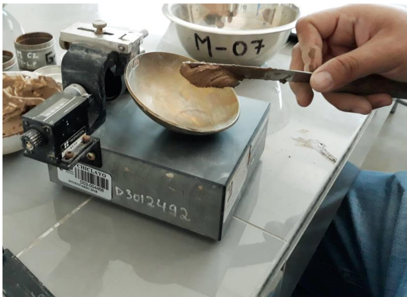
Figura N° 16: Laboratorio de ingeniería civil de la universidad cesar vallejo, Empastado de muestra en copa de casagrande, 2018.
