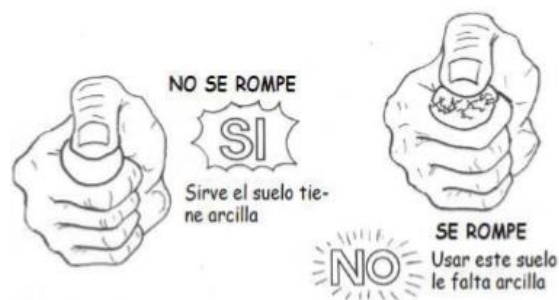
FIGURA 44: Prueba de resistencia seca
