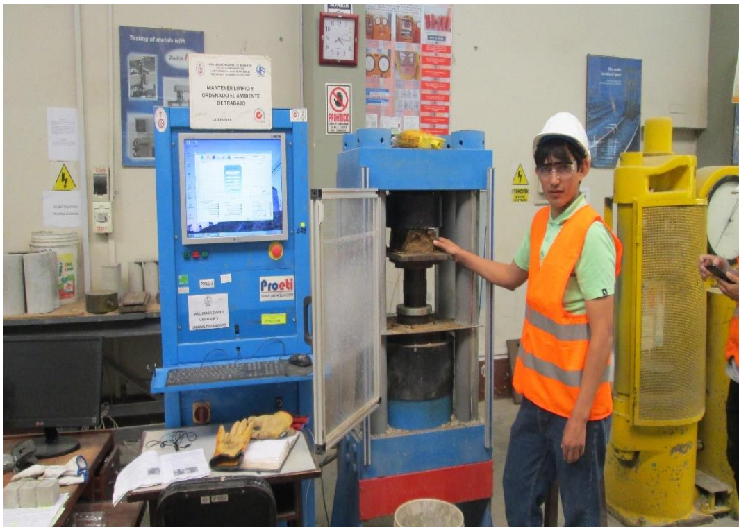
FIGURA 66: Ensayo a la resistencia a la compresión
