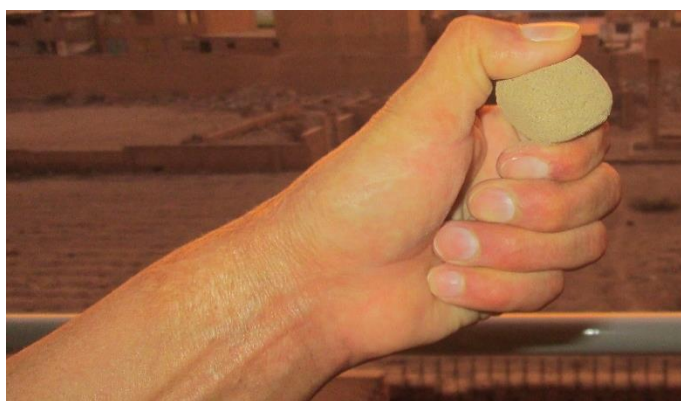
FIGURA 40: Prueba de resistencia seca
