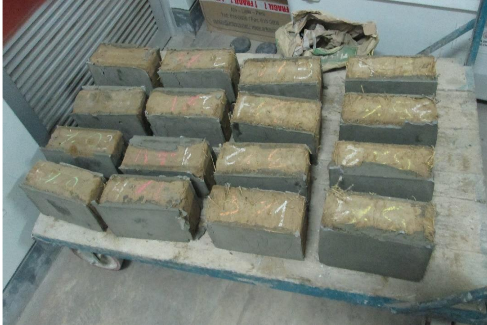
FIGURA 65: Adobe capeado para el ensayo a la resistencia a la compresión
