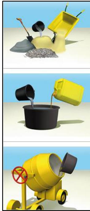
Figura 09. Pasos para agregar aditivos a la mezcla Fuente: Sika
