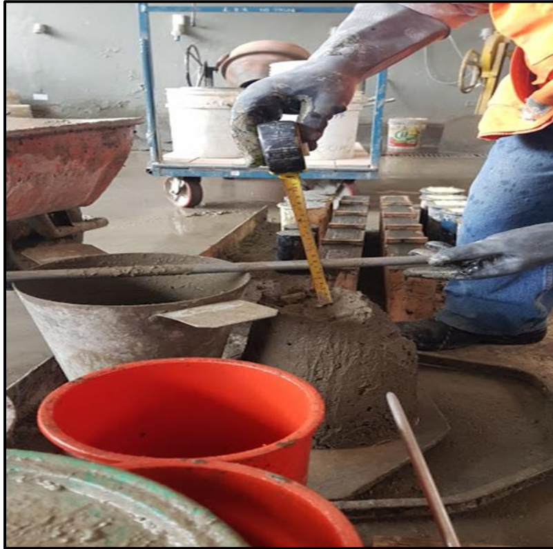
Anexo 24. Medición del slump
