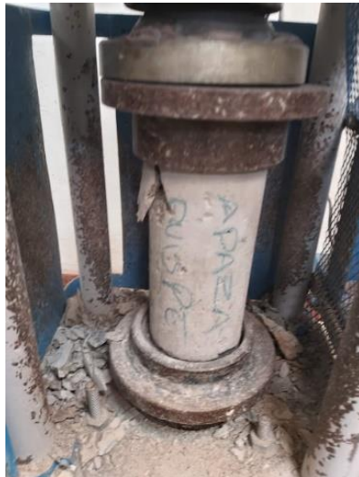
Figura 19. Rotura de la probeta a compresión Fuente: Universidad Nacional de Ingeniería - LEM
