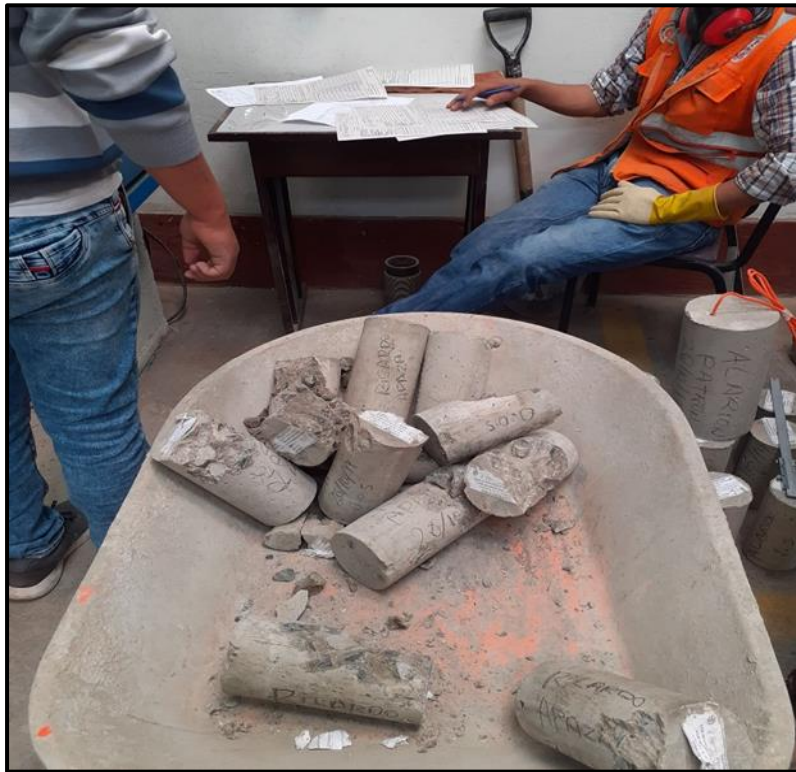
Restos de rotura de probetas
