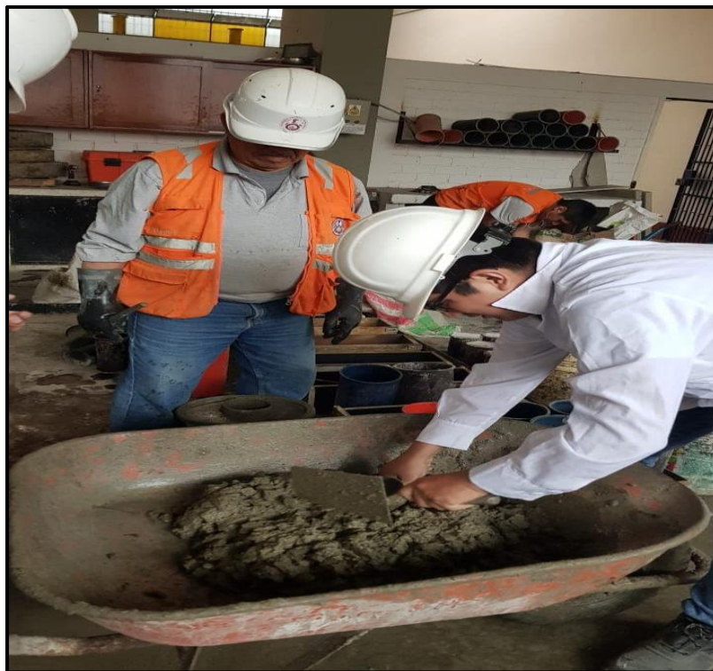
Anexo 21. Colocación de la mezcla de concreto patrón
