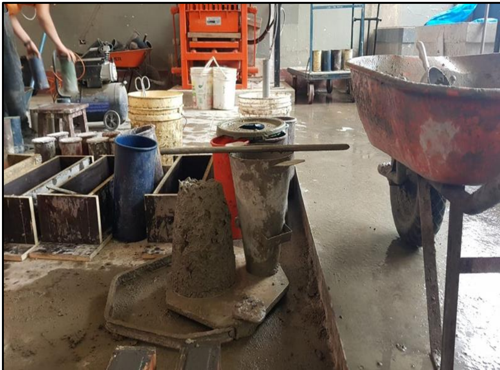
Anexo 25. Slump Concreto patrón
