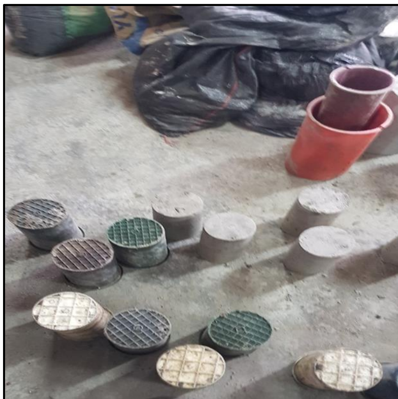
Anexo 27. Desencofrado de probetas
