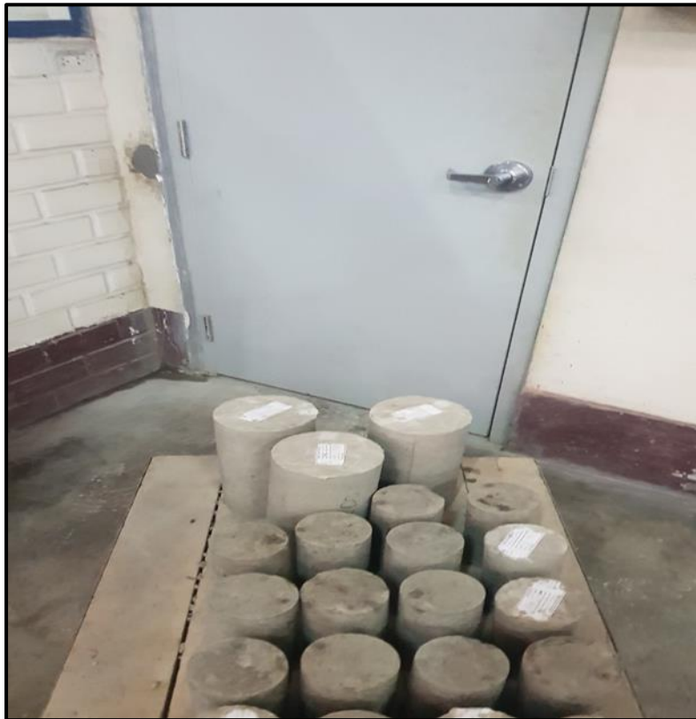
Anexo 30. Traslado de las probetas a las cámaras de curado
