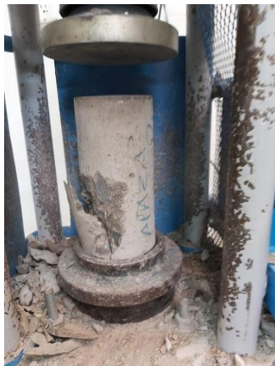
Figura 20. Probeta luego de rotura - falla Fuente: Universidad Nacional de Ingeniería - LEM
