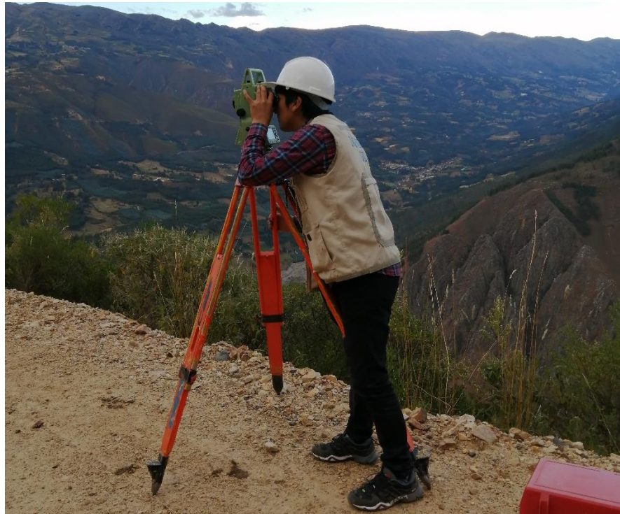
Figura 62. Levantamiento topografico de los taludes estudiados
