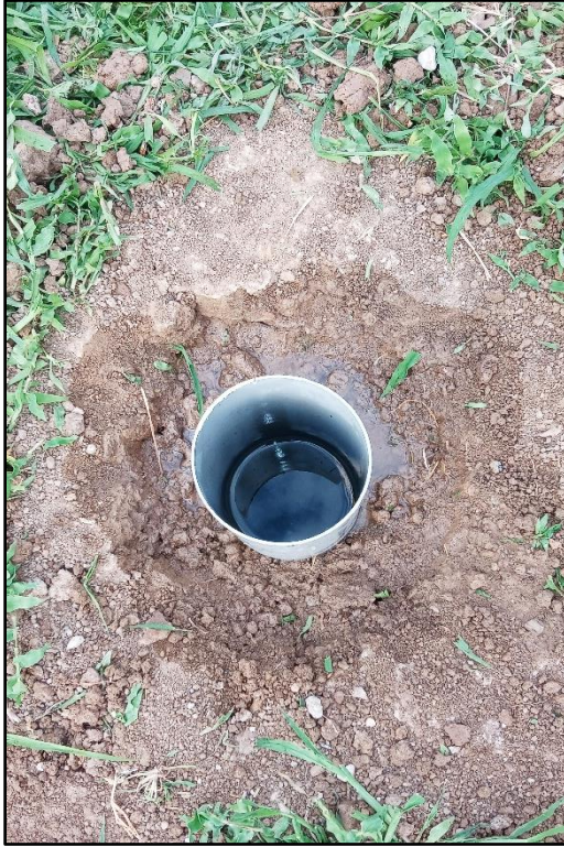
Figura 48. Llenado con agua tubo de 4" para ensayo de permeabilidad
