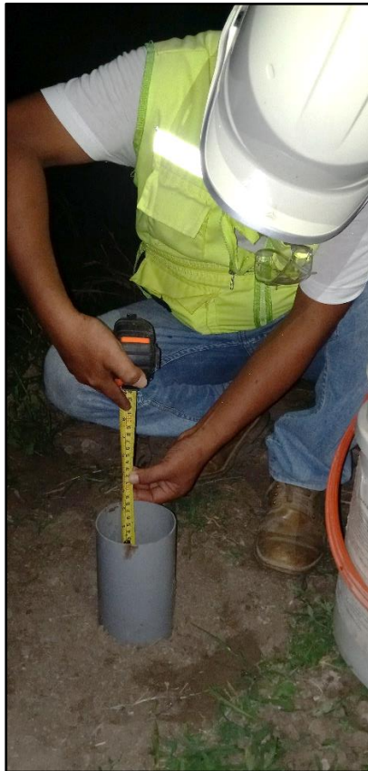
Figura 47. Medición altura de agua para ensayo de Lefranc
