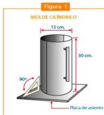
Figura 1. Probeta de concreto
