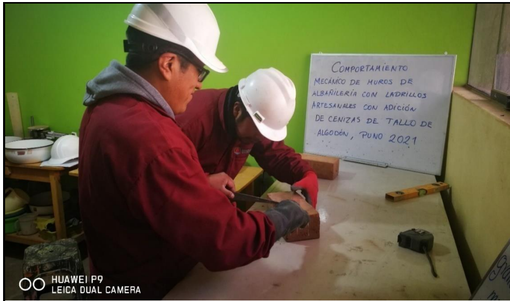
Fig. 17. Realizando Ensayo de Alabeo
