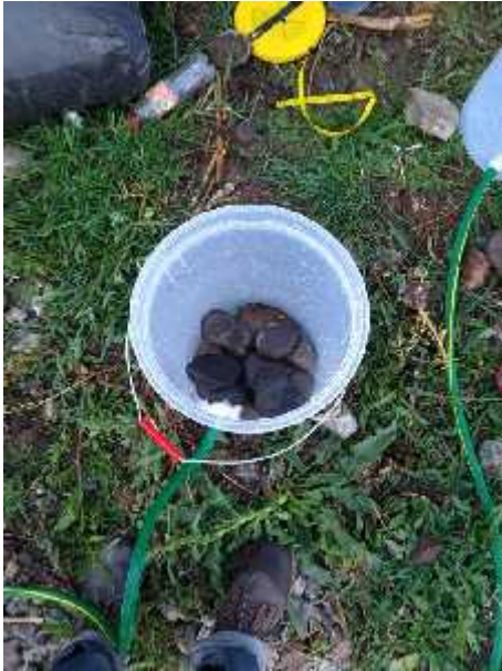
Foto de estrato de piedra de río al 25 % volumen del envase del 20 Litros Fuente: Elaboración propia
