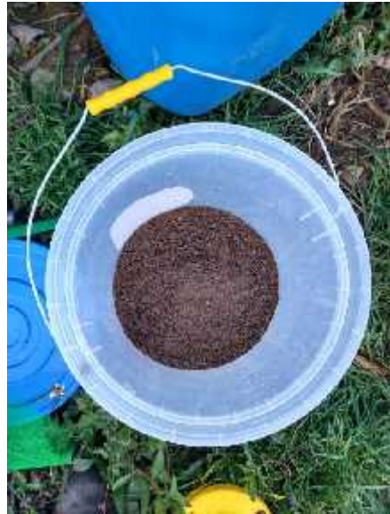
Foto de estrato de arena gruesa de al 25 % del envase de 20 Litros. Fuente: elaboración propia.
