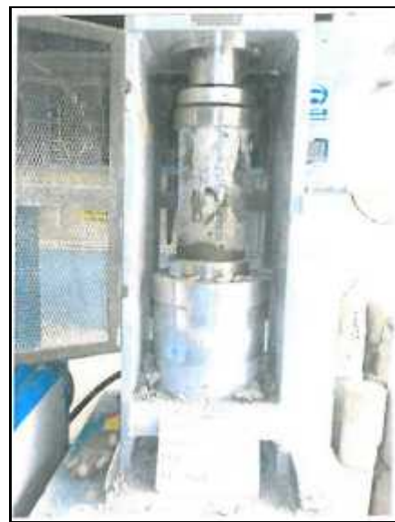
Foto de rotura de probeta del Filtro A (31.91%) Fuente: Elaboración propia.
