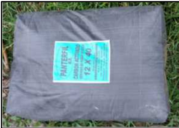
Foto de carbón activado de malla 12x40 mm. Fuente: Elaboración propia.
