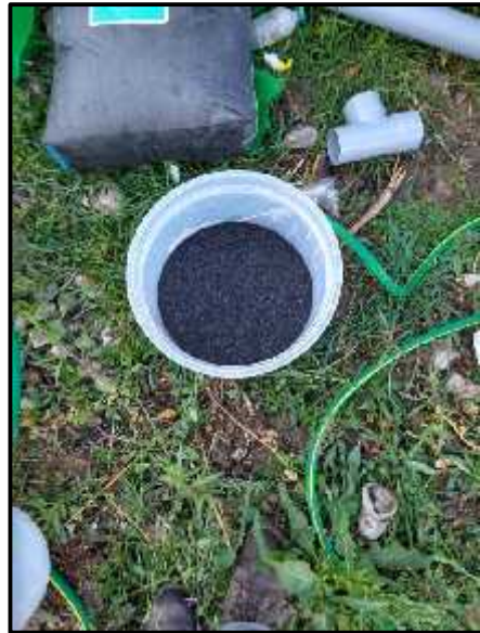
Foto de estrato de carbón activado Para los 3 filtros: Filtro A (31.91 %), Filtro B (37.25%) y Filtro C (42.55%). Fuente: Elaboración propia.
