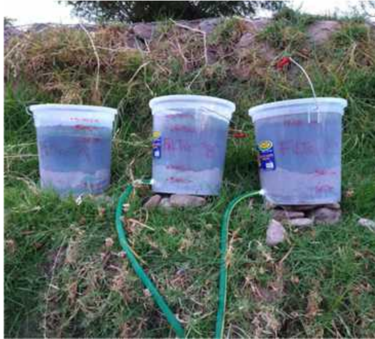
Foto de los 3 Filtros con carbón activado: Filtro A=31.91%, Filtro B=37.25% y Filtro C=42.55% Fuente: Elaboración propia.
