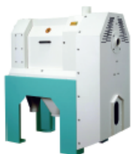
Desgerminador de maíz: desgerminación intensa
