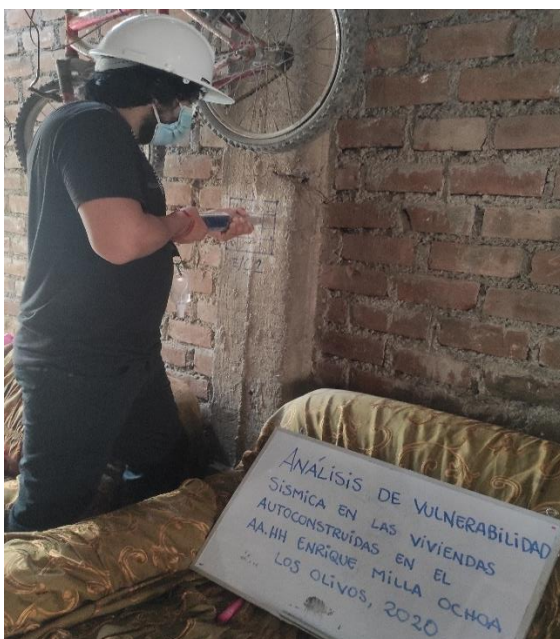
Figura N°5: Ensayo de esclerometría.
