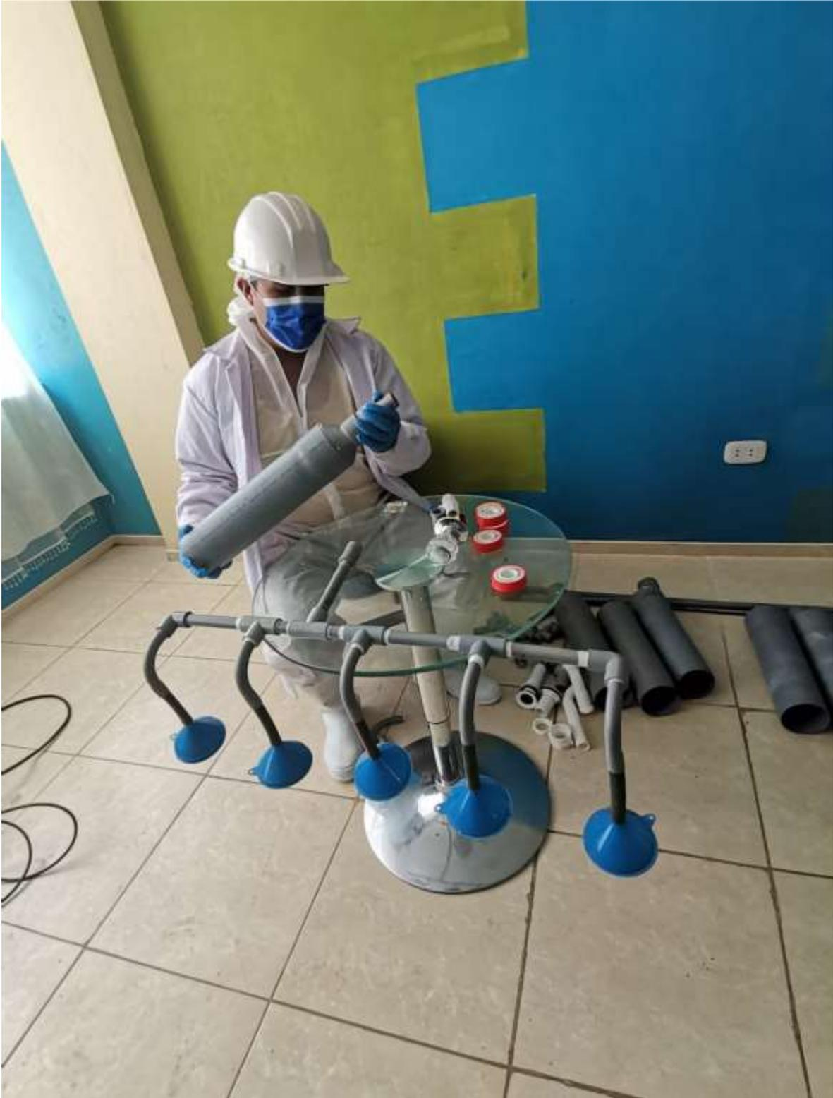
Figura 23. Armado del biofiltro.
