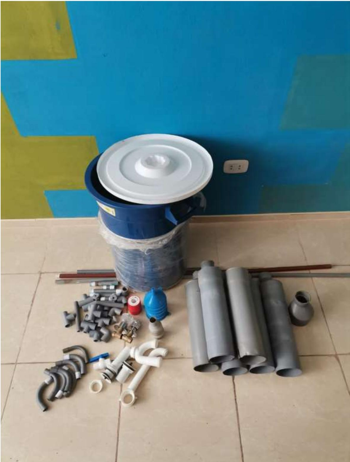
Figura 19. Materiales del sistema de biofiltración.
