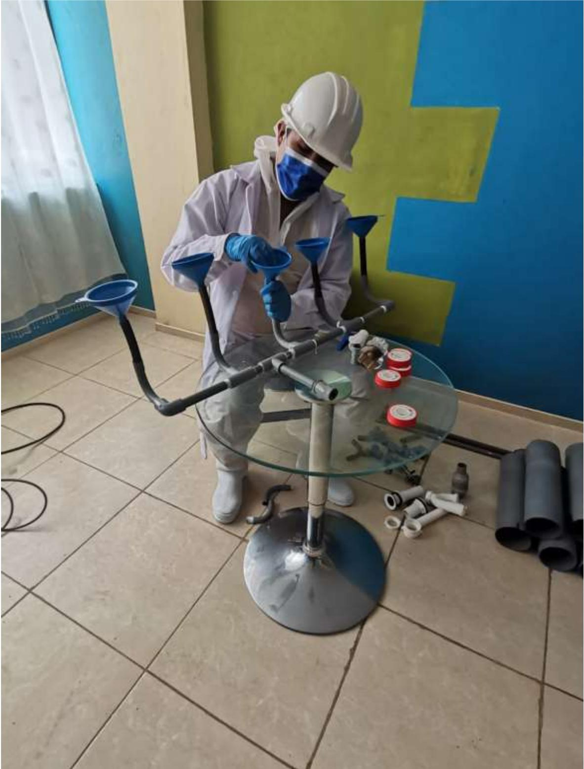
Figura 22. Proceso de armado del sistema de biofiltración.
