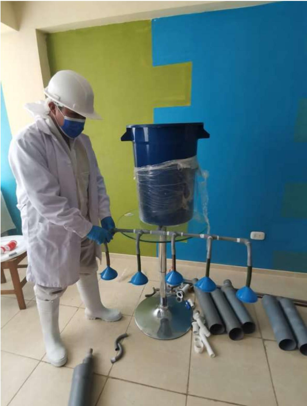
Figura 24. Conexión final del sistema de biofiltración.
