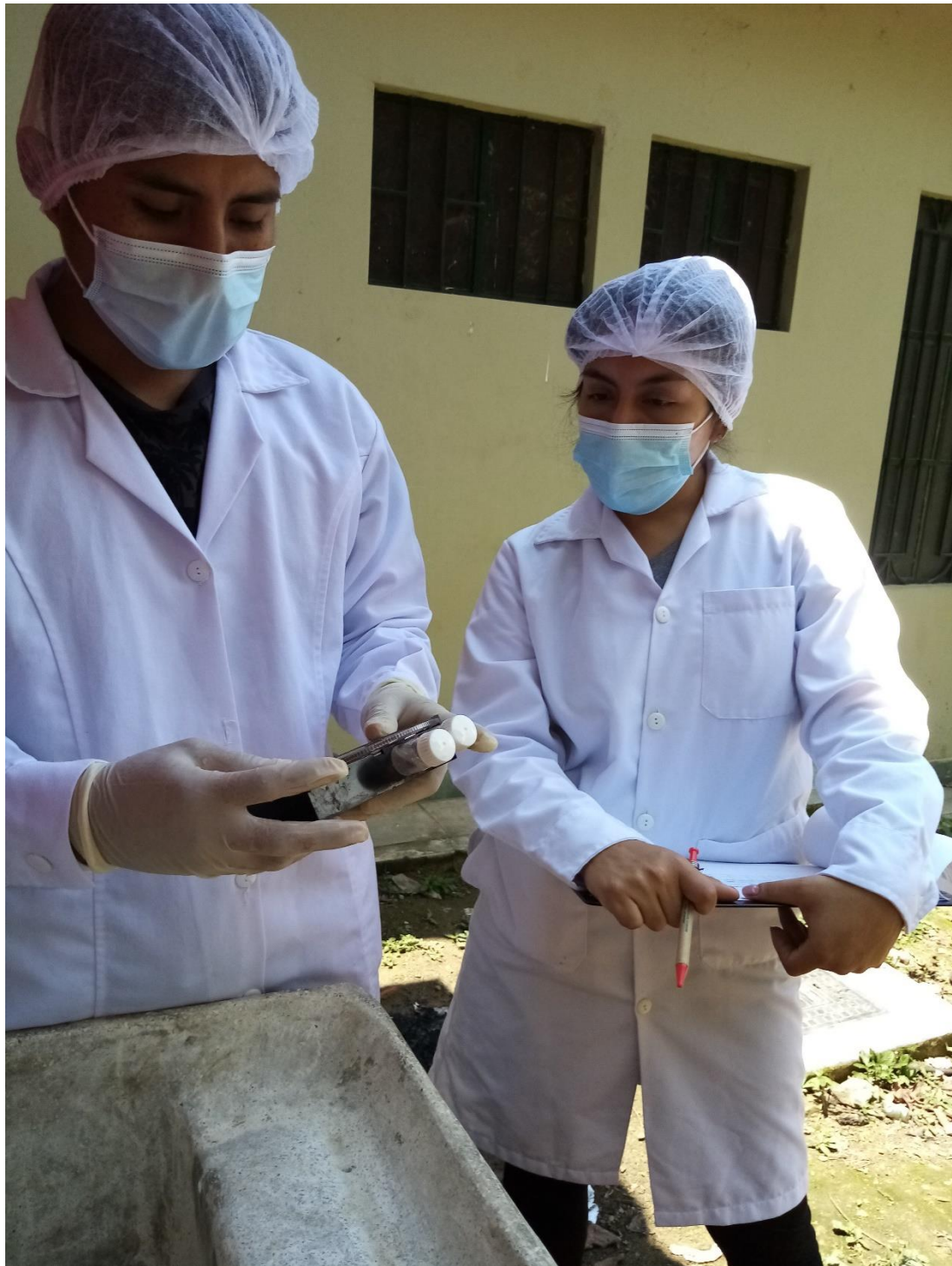
Imagen 7. Medición de cloro y toma de muestras de agua en la red domiciliaria 1.
