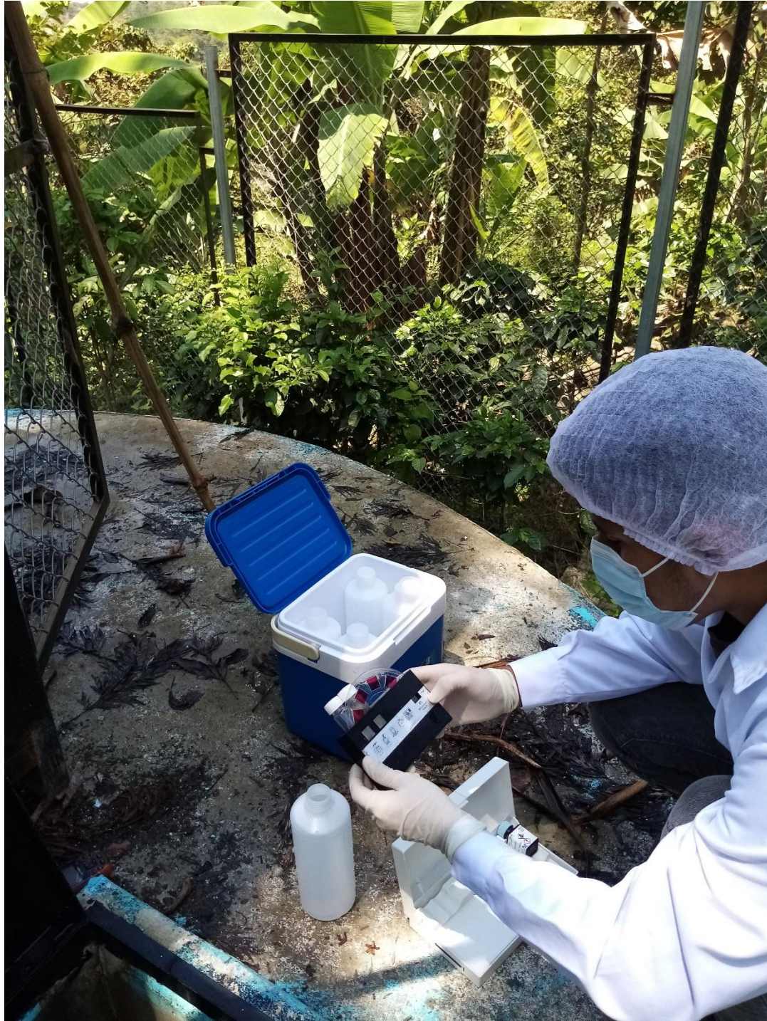
Imagen 4. Medición de cloro residual en el tanque de almacenamiento
