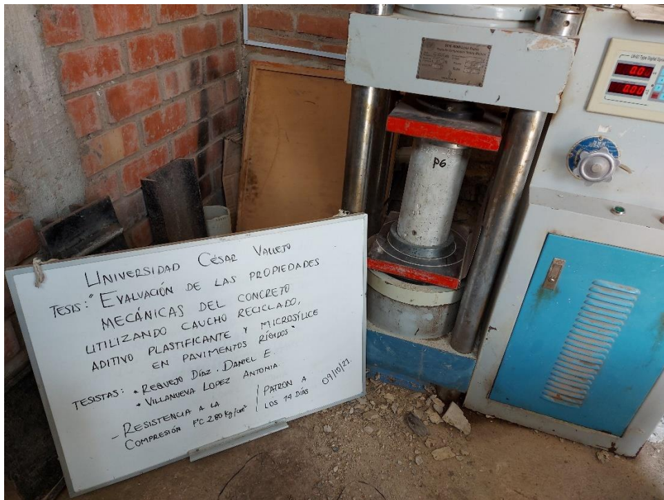
Rotura de muestra P6 del concreto patrón 280 kg/cm 2 (14 días)
