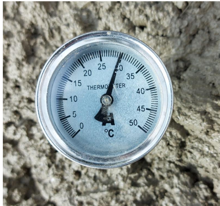
Control de temperatura del concreto
