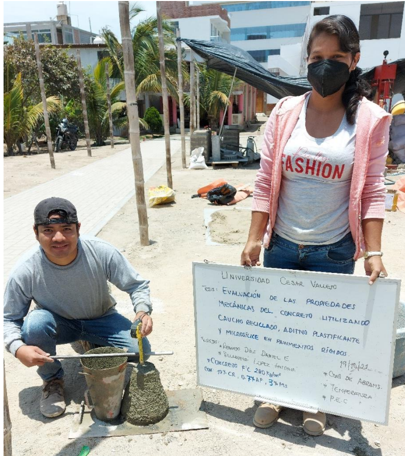
F'c 280 kg/cm 2 con 10%CR- 0.7% Ap –3% Ms (Ensayo de revenimiento)
