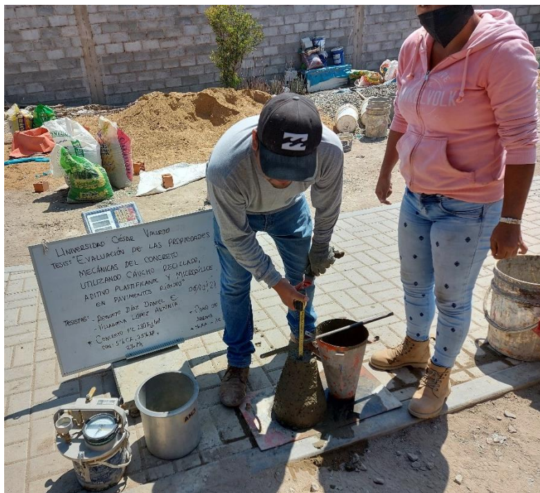
F'c 280 kg/cm 2 con 5%CR- 0.5% Ap – 2% Ms (Ensayo de revenimiento)
