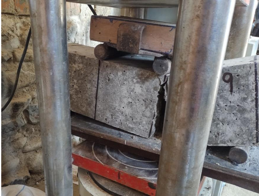
Ensayo de flexión de viga V9 concreto patrón 280 kg/cm 2 (28 días)
