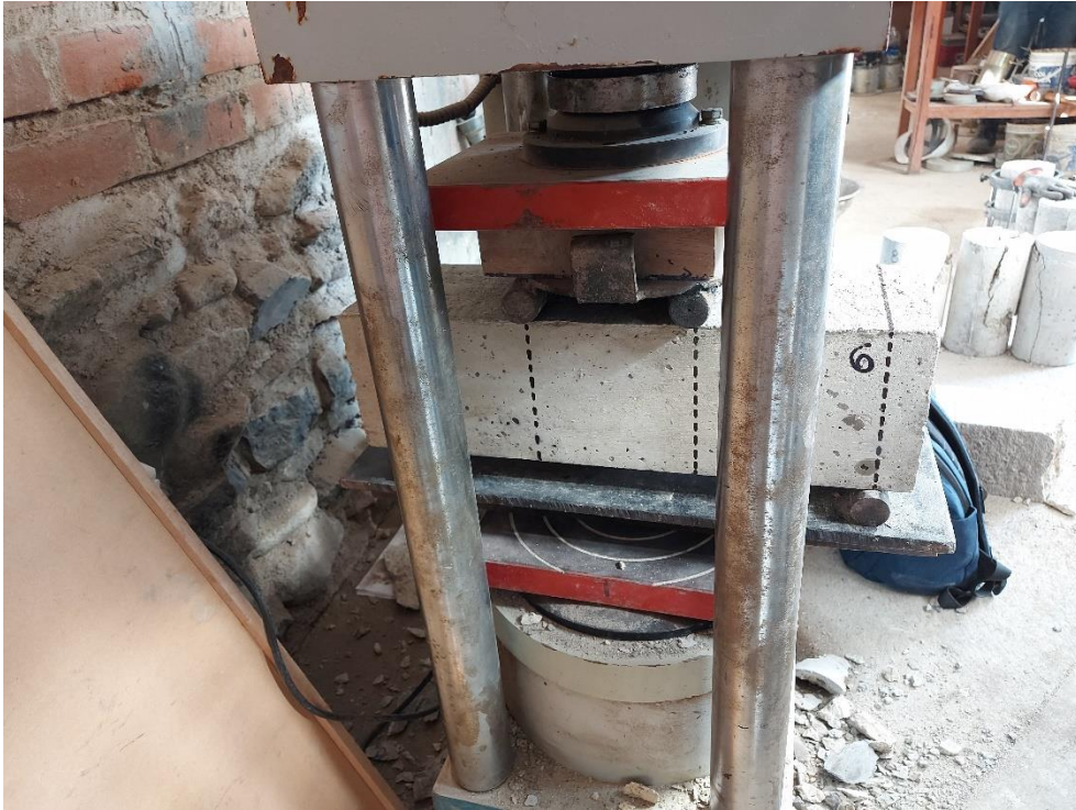
Foto: Prensa Electro-hidráulica
