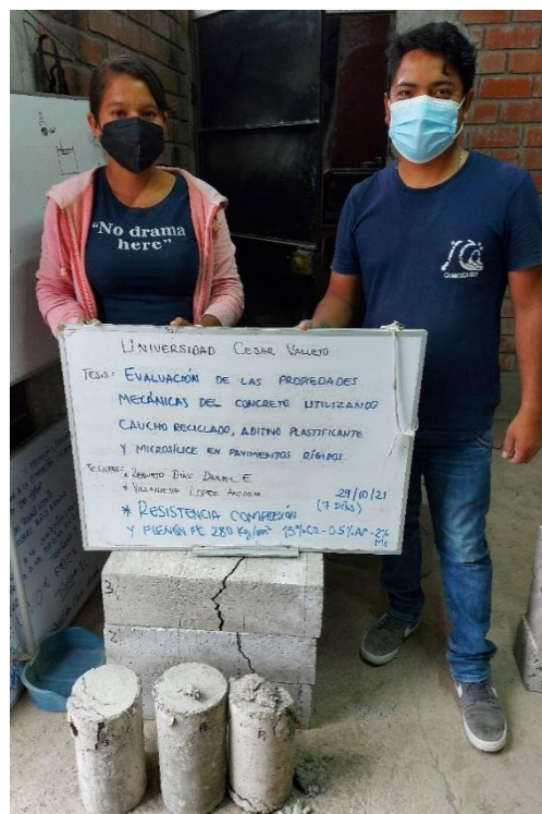
RESISTENCIA A LA COMPRESIÓN Y FLEXIÓN F'C 280 kg/cm 2 CON 15% CR, 0.5% Ap, 2% Ms (07 días)
