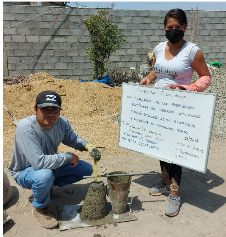
F'c 280 kg/cm 2 con 15%CR- 0.5% Ap –2% Ms (Ensayo de revenimiento)
