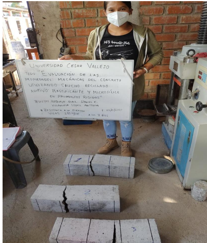
Rotura de 03 especímenes de vigas del concreto patrón 280 kg/cm 2 (07 días)
