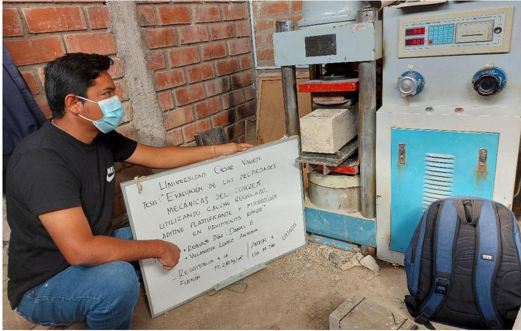
Rotura de espécimen Viga concreto patrón 280 kg/cm 2 (14 días)
