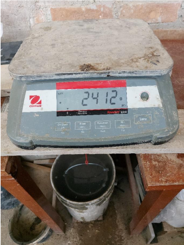
Foto: Equipos ensayo de Densidad relativa y Absorción del agregado grueso
