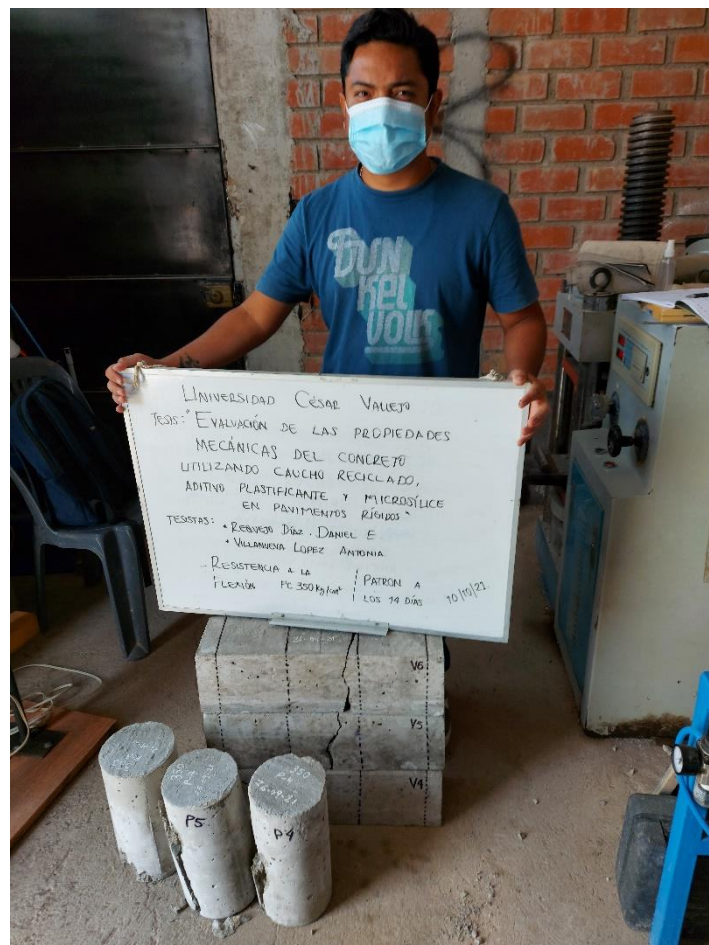
Ensayo de flexión de viga V6 concreto patrón 350 kg/cm 2 (14 días)
