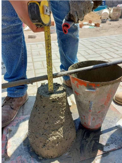
Ensayo de Revenimiento = 2"
