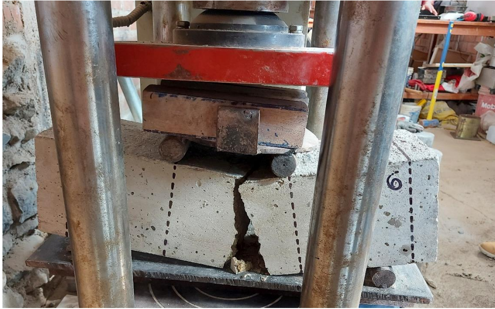
Ensayo de flexión de viga V6 concreto patrón 280 kg/cm 2 (14 días)
