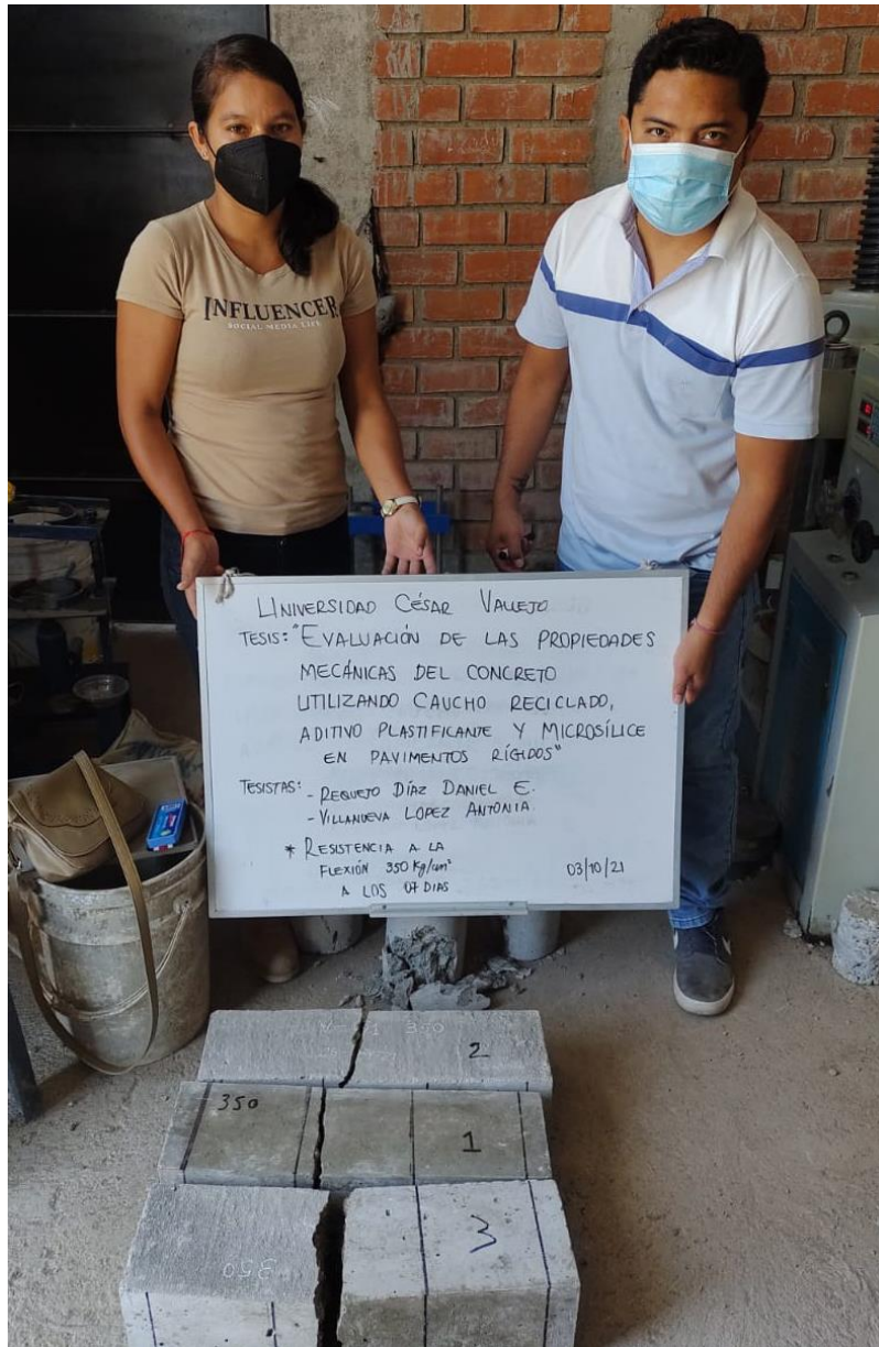
Rotura de 03 especímenes de vigas del concreto patrón 350 kg/cm 2 (07 días)
