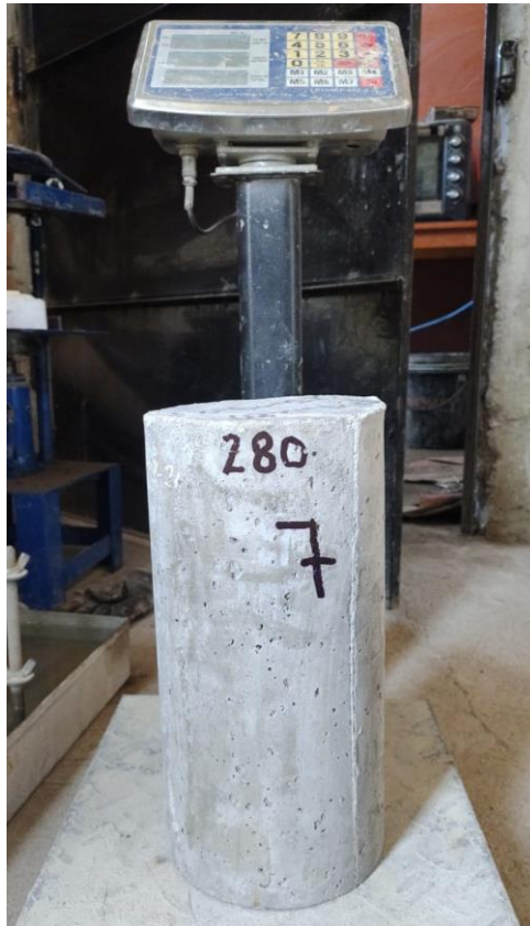
Rotura de muestra P7 del concreto patrón 280 kg/cm 2 (28 días)
