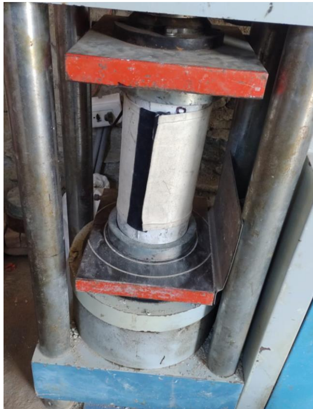
Rotura de muestra P8 del concreto patrón 280 kg/cm 2 (28 días)
