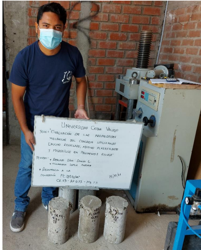
RESISTENCIA A LA COMPRESIÓN F'C 280 kg/cm 2 CON 5% CR, 0.3% Ap, 1% Ms (7 días)
