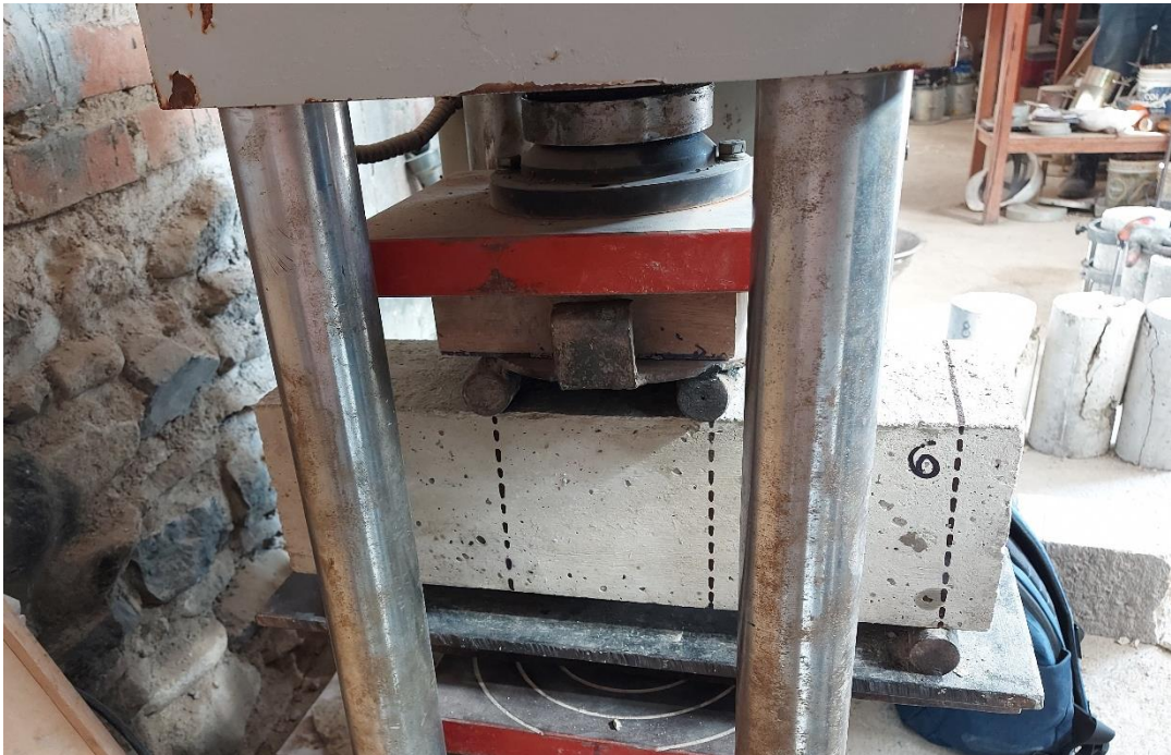
Rotura de espécimen Viga V6 concreto patrón 280 kg/cm 2 (14 días)
