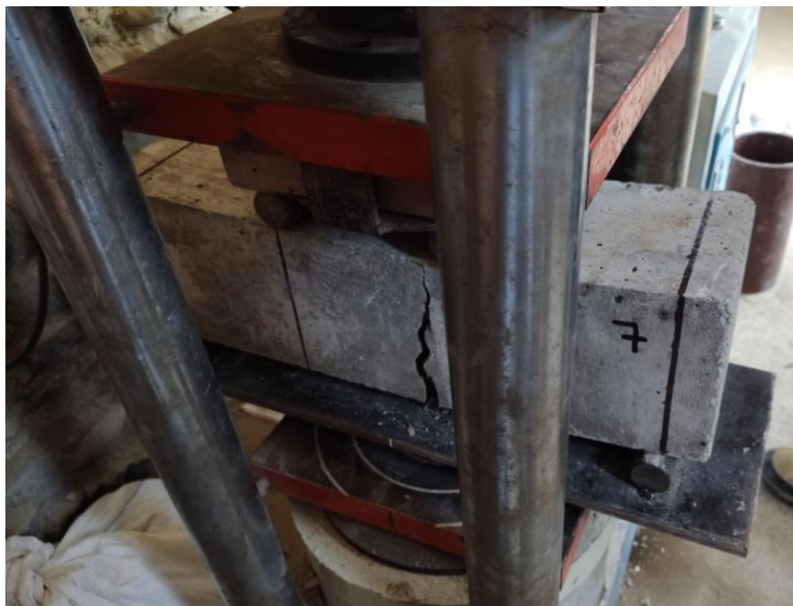
Rotura de 03 probetas del concreto patrón 280 kg/cm 2 (28 días)
