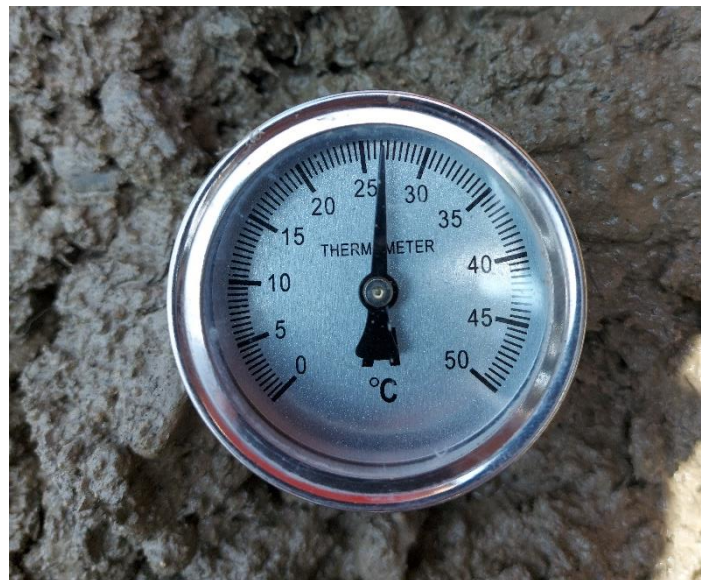
Control de temperatura del concreto
