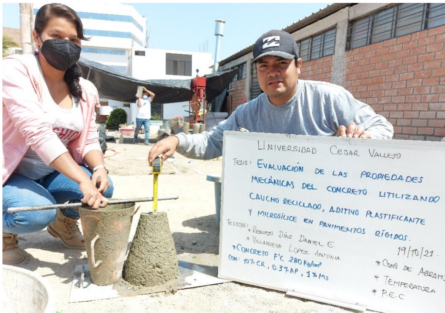
F'c 280 kg/cm 2 con 10%CR- 0.3% Ap –1% Ms (Ensayo de revenimiento)
