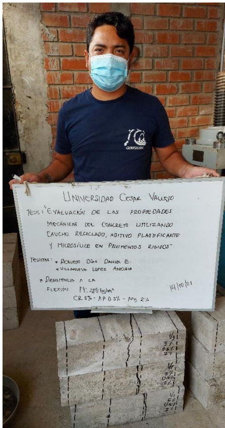
RESISTENCIA A LA FLEXIÓN F'c 280 kg/cm 2 CON 5% CR, 0.5% Ap, 2% Ms (7 días)
