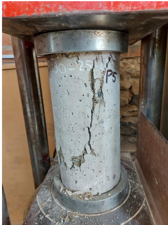
Rotura de muestra P4 del concreto patrón 280 kg/cm 2 (14 días)
