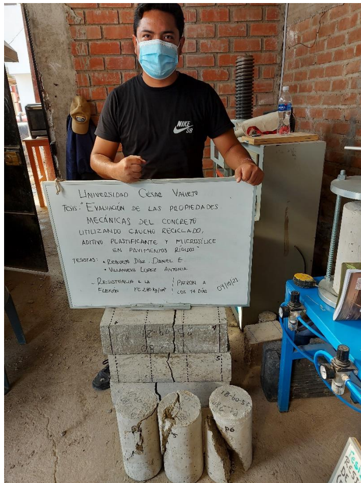
Ensayo de flexión de viga V6 concreto patrón 280 kg/cm 2 (14 días)
