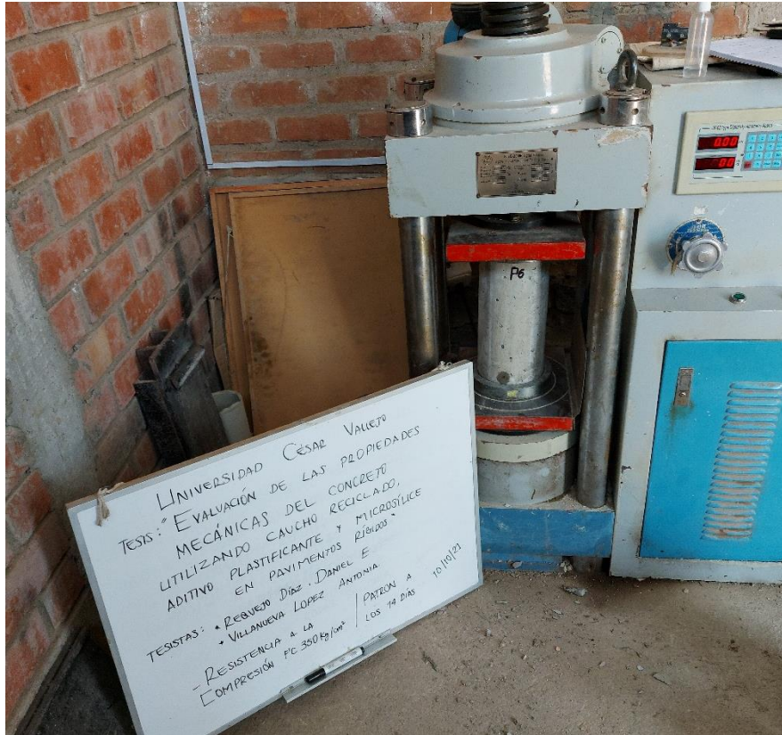
Rotura de muestra P4 del concreto patrón 350 kg/cm 2 (14 días)
