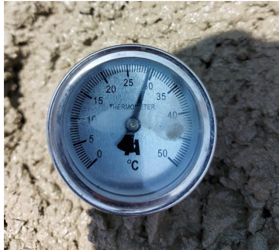
Control de temperatura del concreto
