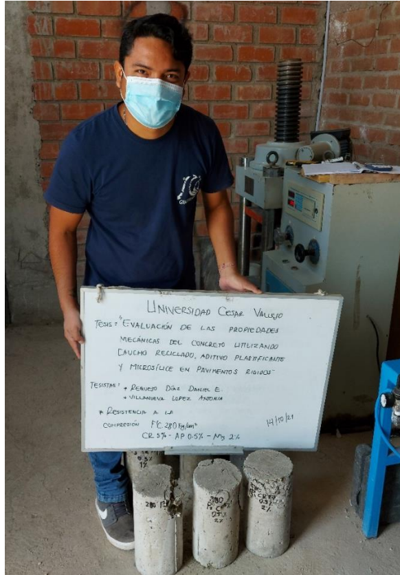
RESISTENCIA A LA COMPRESIÓN F'c 280 kg/cm 2 CON 5% CR, 0.5% Ap, 2% Ms (7 días)
