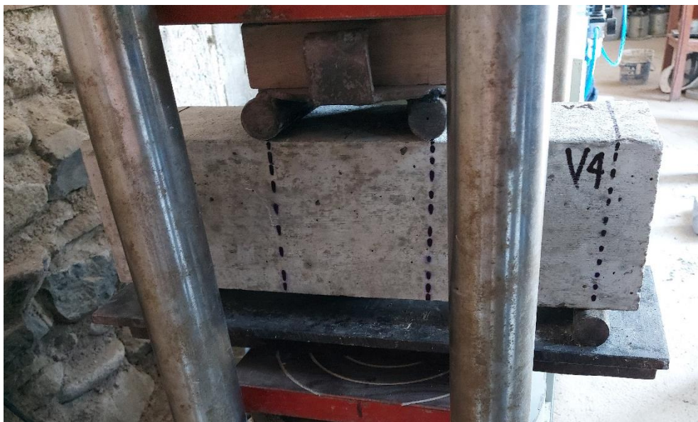
Rotura de espécimen Viga V4 concreto patrón 350 kg/cm 2 (14 días)
