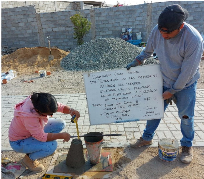
F'c 280 kg/cm 2 con 5%CR- 0.7% Ap –3% Ms (Ensayo de revenimiento)
