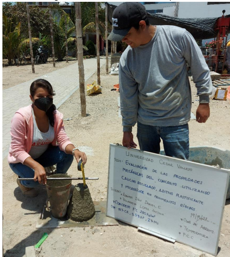
F'c 280 kg/cm 2 con 10%CR- 0.5% Ap –2% Ms (Ensayo de revenimiento)
