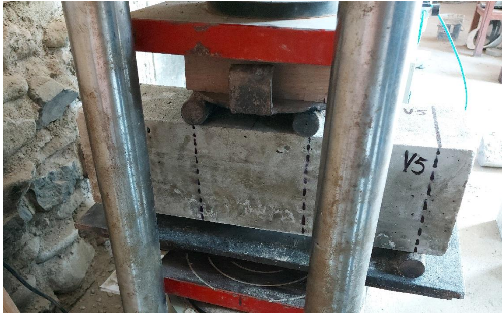
Rotura de espécimen Viga V5 concreto patrón 350 kg/cm 2 (14 días)
