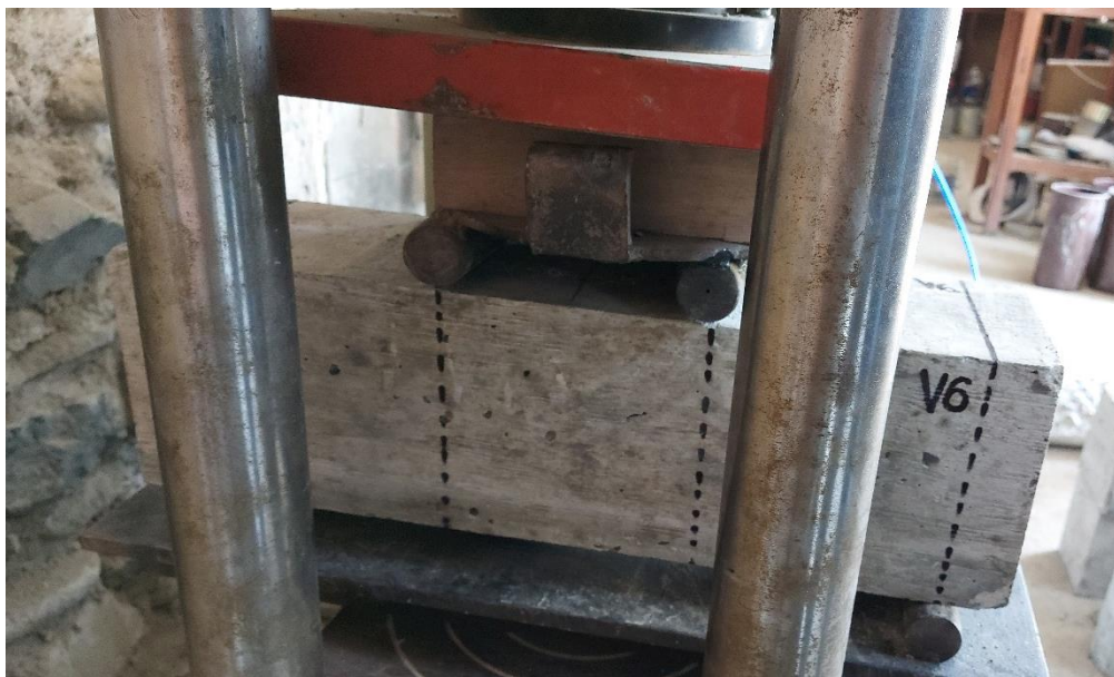
Rotura de espécimen Viga V6 concreto patrón 350 kg/cm 2 (14 días)
