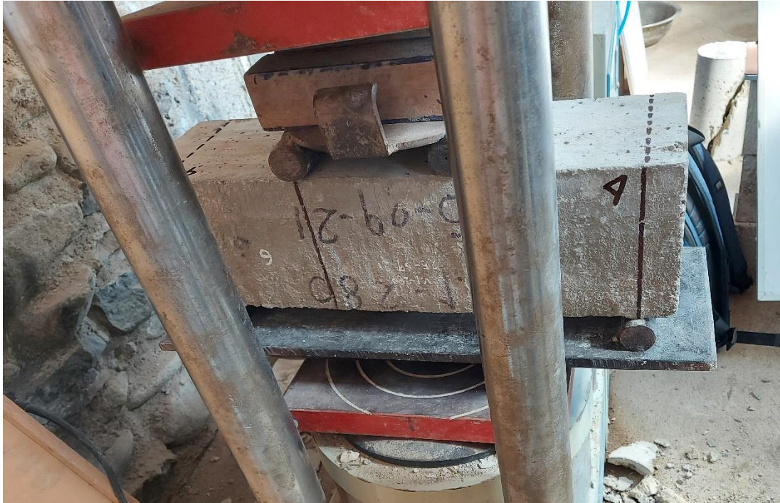
Rotura de espécimen Viga V4 concreto patrón 280 kg/cm 2 (14 días)
