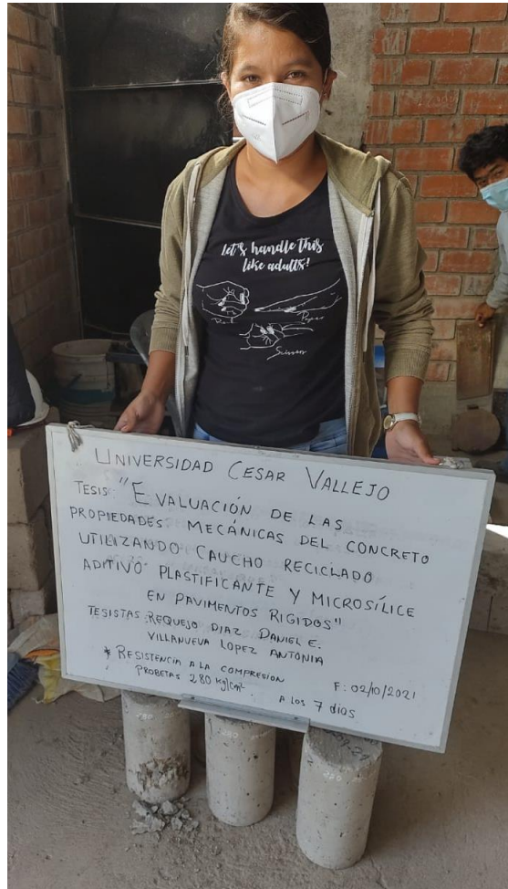
Rotura de 03 probetas del concreto patrón 280 kg/cm 2 (07 días)
