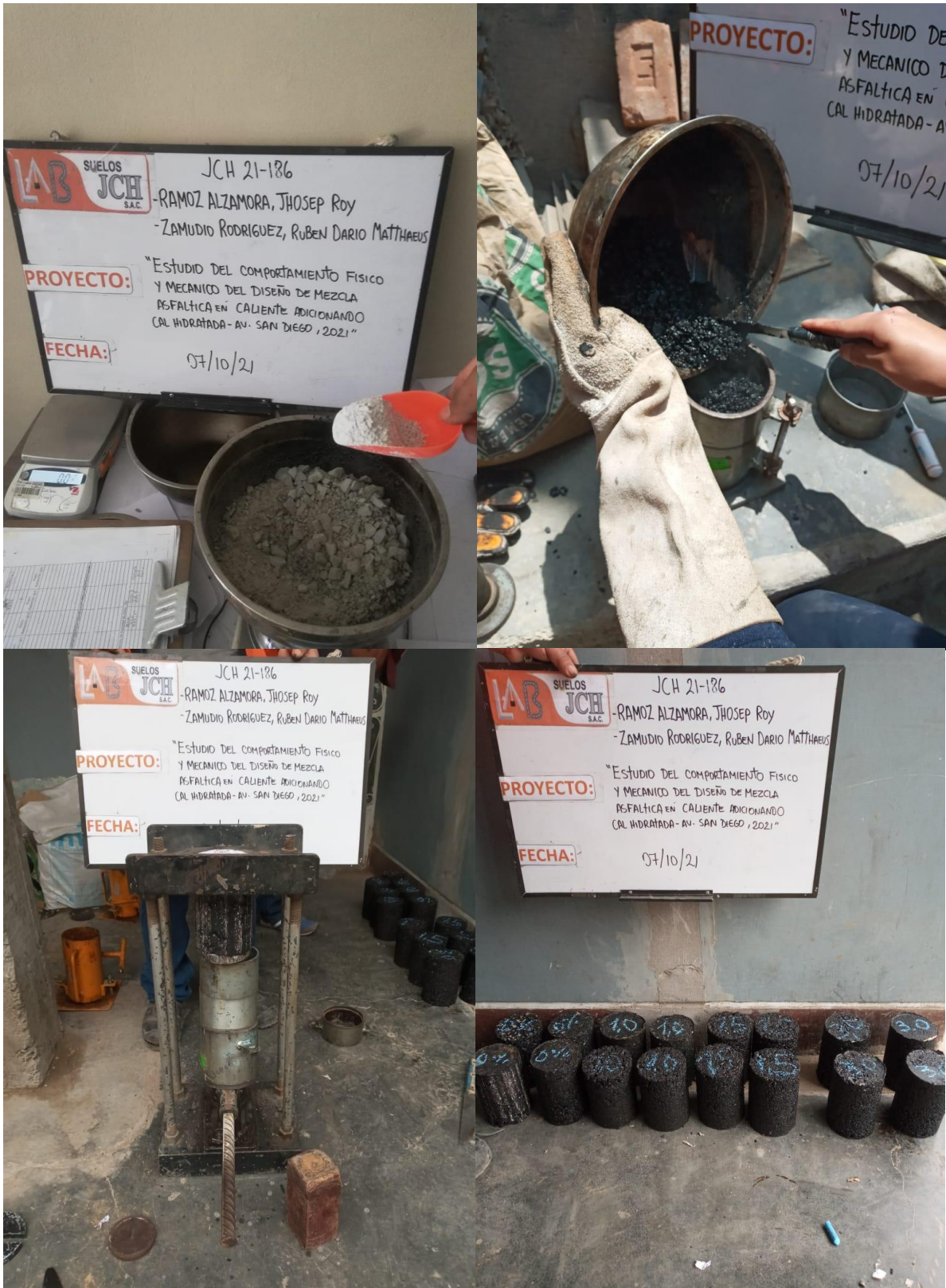
Fotografía 15: Preparación de las briquetas para ser compactadas, proceso de extracción de las briquetas.
