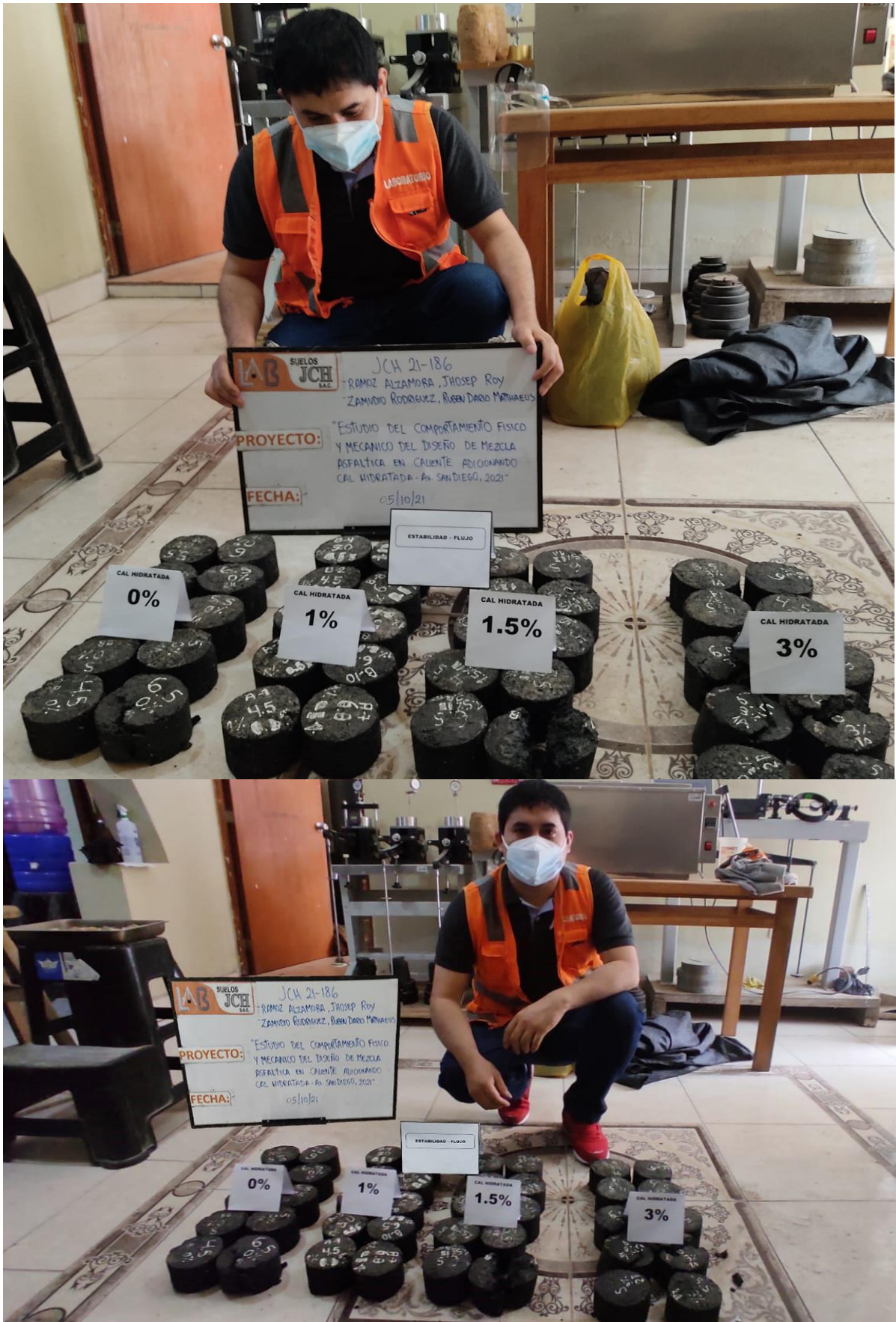
Fotografía 12: Presentación del total del diseño de mezcla asfáltica en 0%; 1%; 1.5% y 3%.
