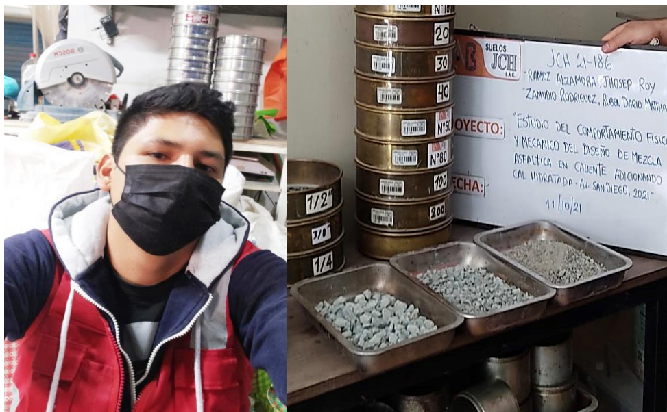
Figura 25. Ensayos iniciales para el diseño de mezcla asfáltica.
