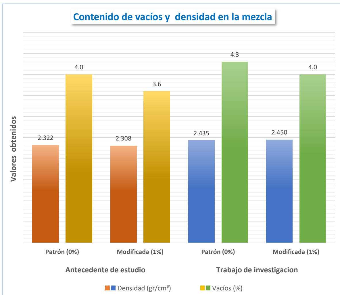
Figura 75. Barras comparativas para el contenido de vacíos y densidad en la mezcla, antecedente vs. Trabajo de investigación.
