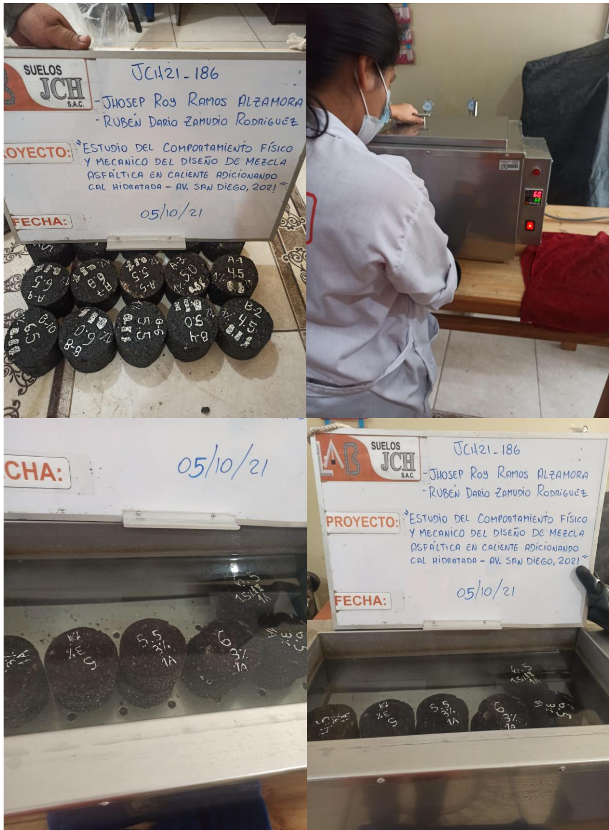
Fotografía 7: Baño de agua en el recipiente a unos 60 \pm 1 °C antes de ser ensayado en el aparato Marshall.
