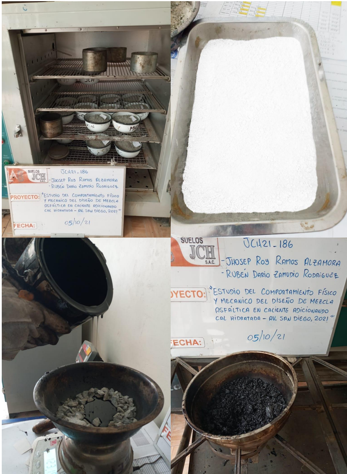
Fotografía 3: Procesamiento del agregado, cal hidratada, cuantificación del cemento asfáltico y proceso de mezclado.
