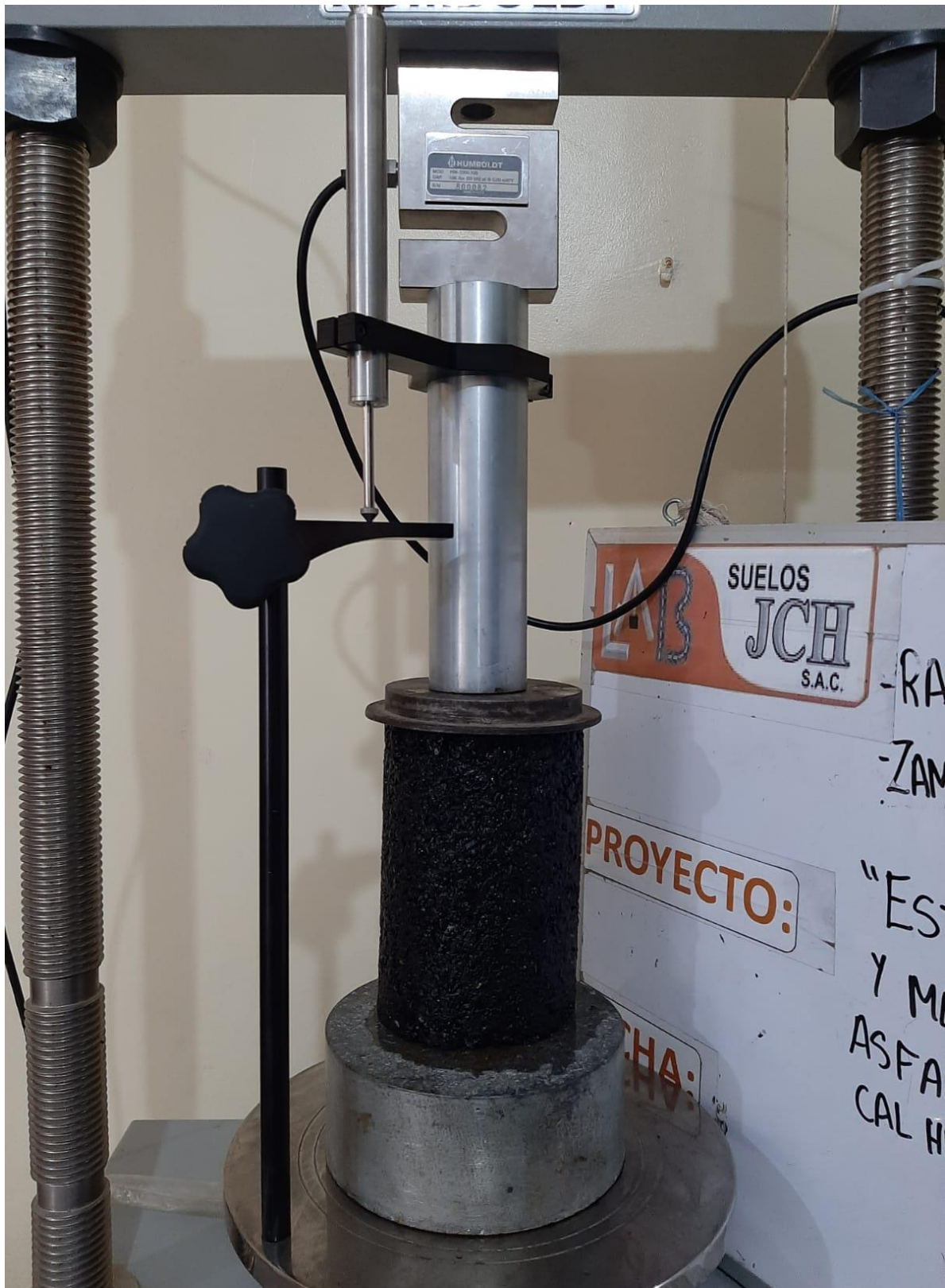
Fotografía 20: Ensayo de resistencia inmersión – compresión.
