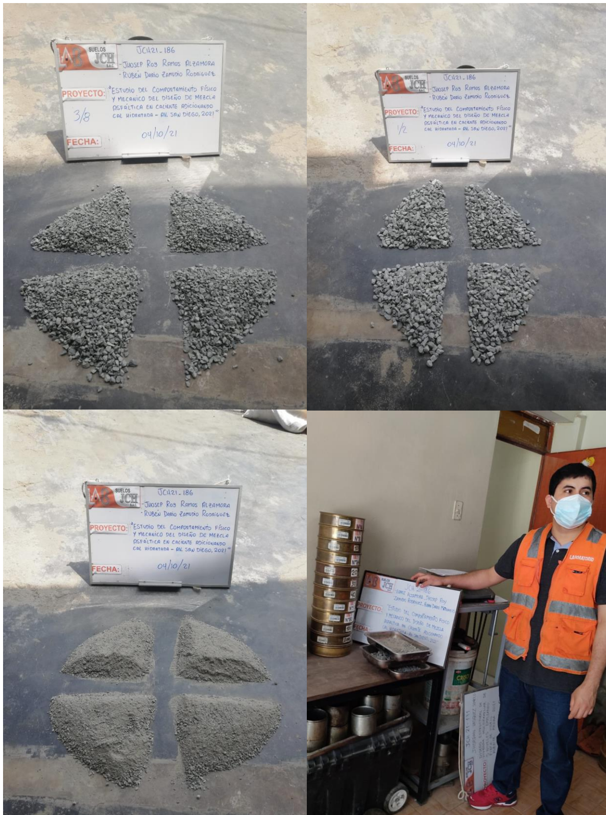
Fotografía 1: Cuarteo del árido y preparación de los tamices para el ensayo.
