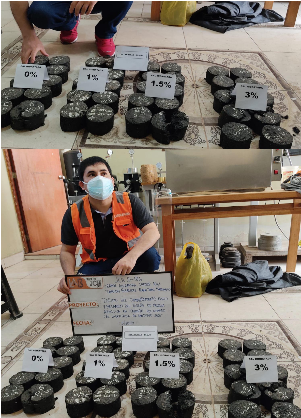
Fotografía 11: Ensayo de rotura para estabilidad y flujo en cada porcentaje de cal hidratada.
