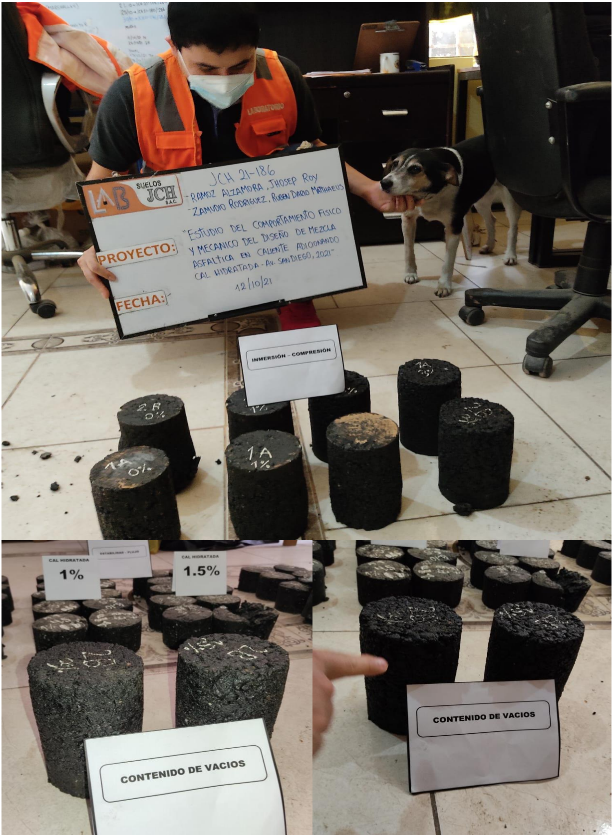
Fotografía 21: Presentación de ensayo de Inmersión – compresión, contenido de vacíos en el diseño de mezcla asfáltica.
