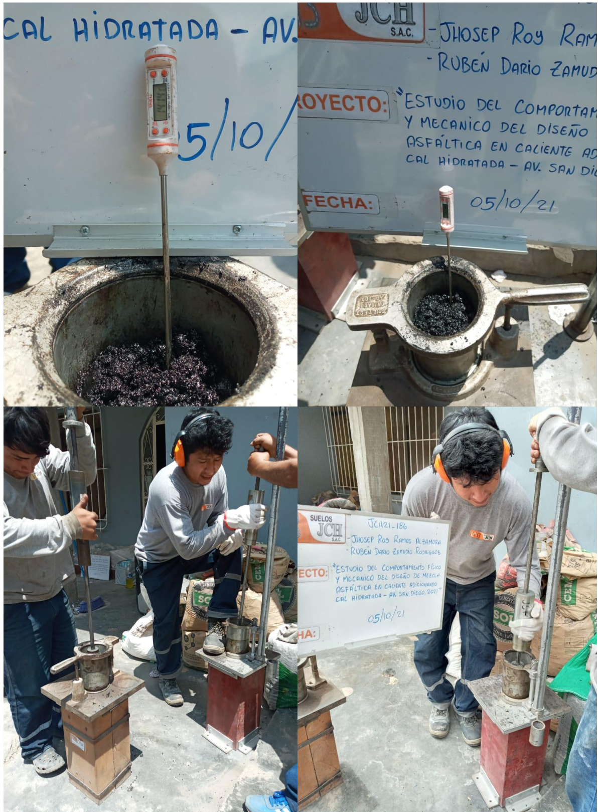
Fotografía 5: Temperatura, Mezclado y compactación con el martillo.
