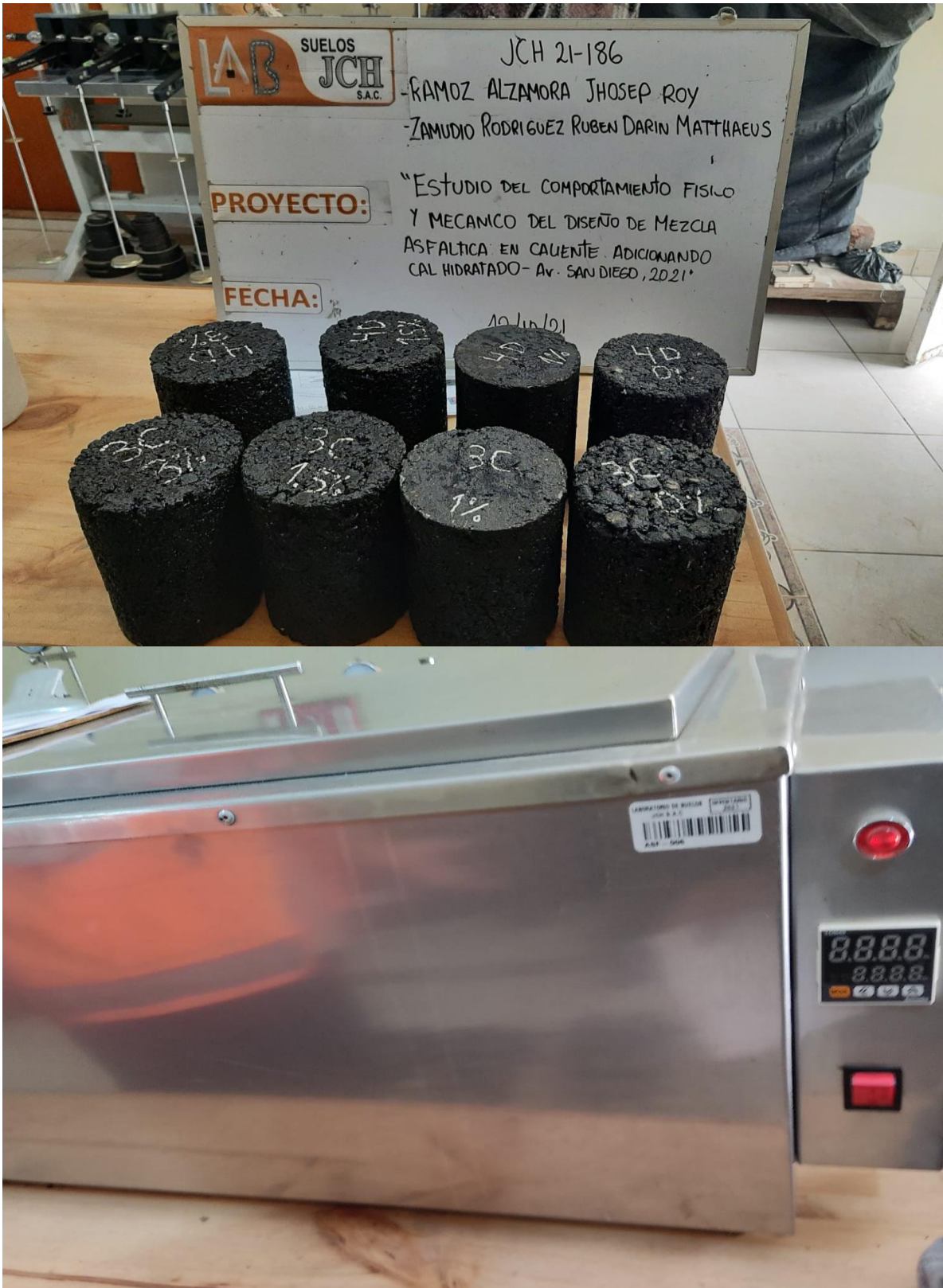
Fotografía 16: Presentación de los especímenes y calibración del recipiente para baño de agua.
