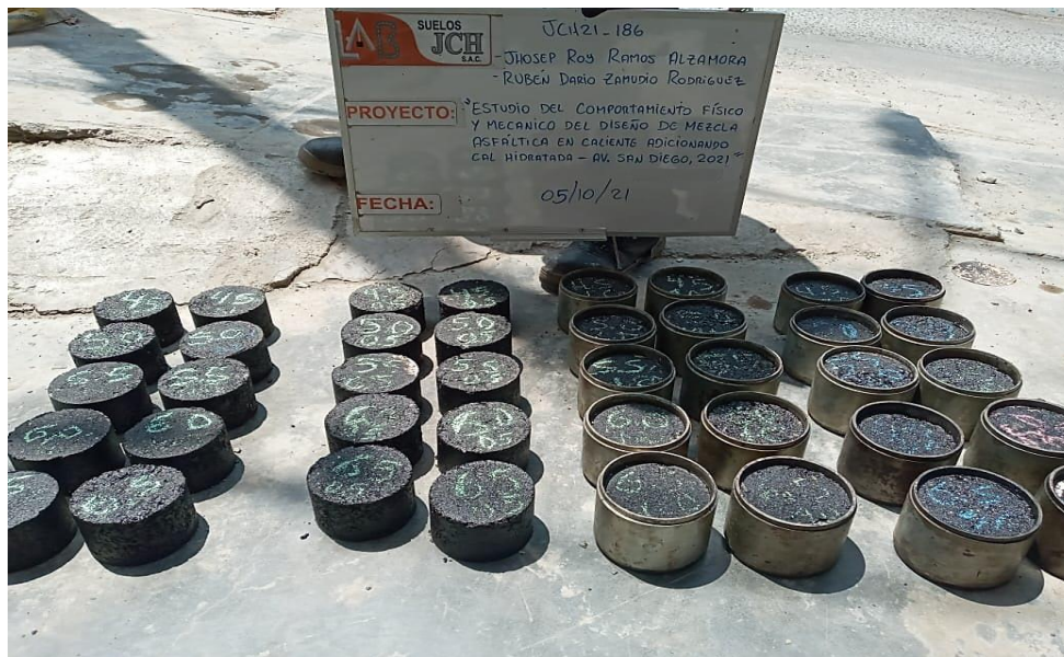
Figura 26. Briquetas con 0%; 1%; 1.5% y 3% de cal hidratada.
