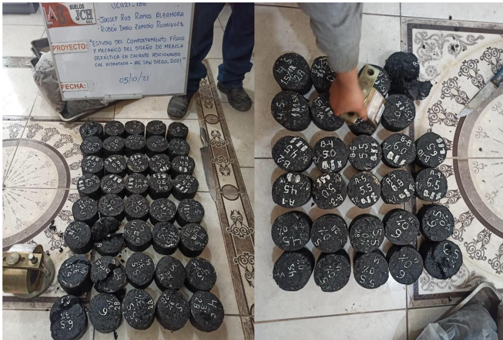
Figura 34. Briquetas de forma cilíndrica, diámetro de (4") y (2") de altura.
