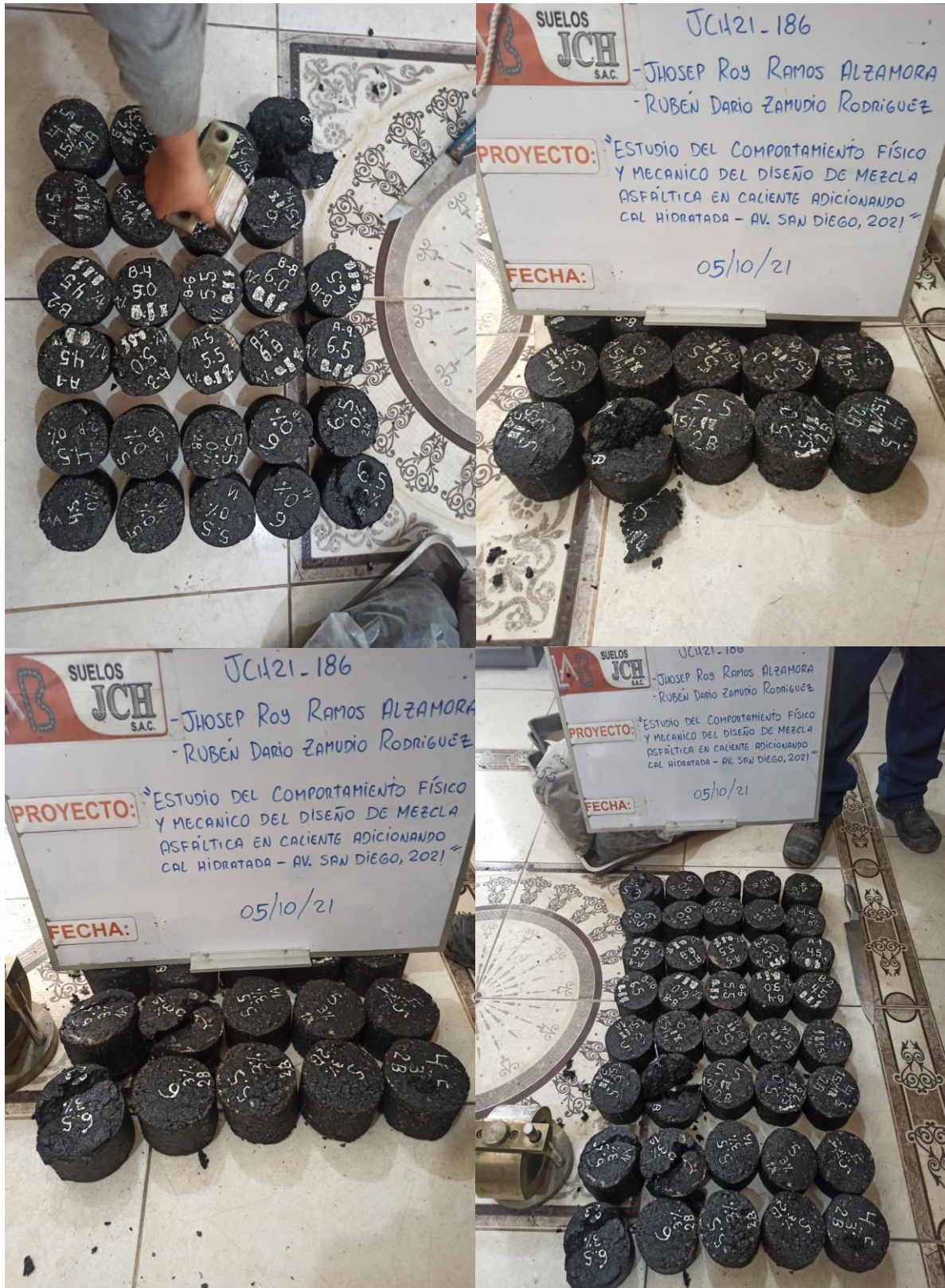
Fotografía 9: Ensayo de rotura para estabilidad y flujo para las briquetas en cada porcentaje.
