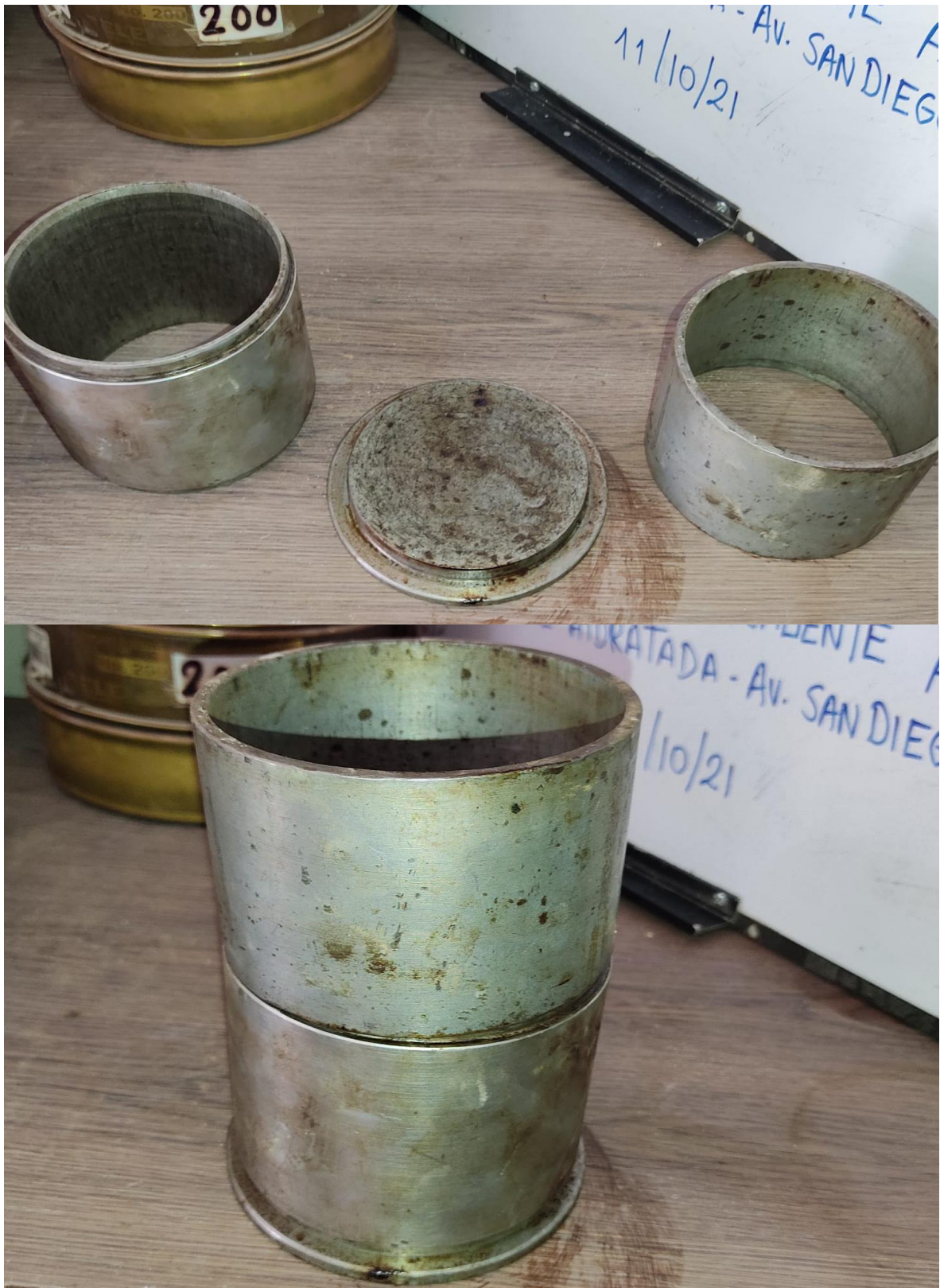
Fotografía 4: Ensamble del molde de compactación (4") 101.6 mm con una altura aprox. de (3") 76.2 mm.
