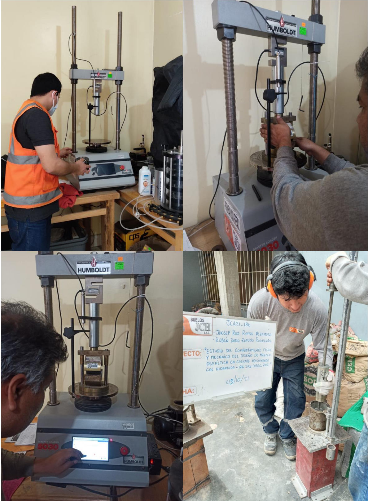
Fotografía 8: Secado de la briqueta; colocación en la mordaza o cabezal Marshall para determinar la estabilidad y la fluencia.
