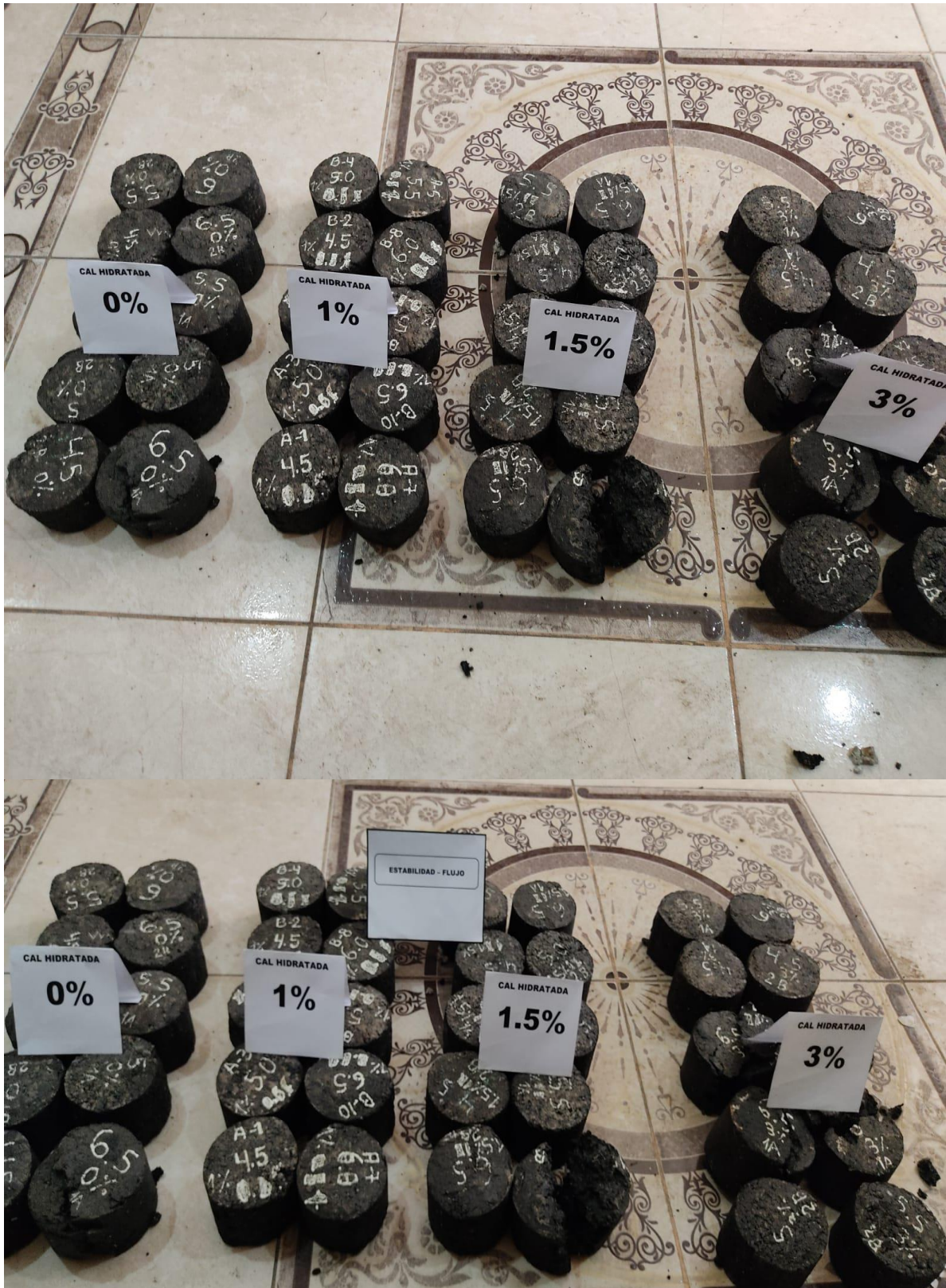
Fotografía 10: Ensayo de rotura para estabilidad y flujo para las briquetas en cada porcentaje.
