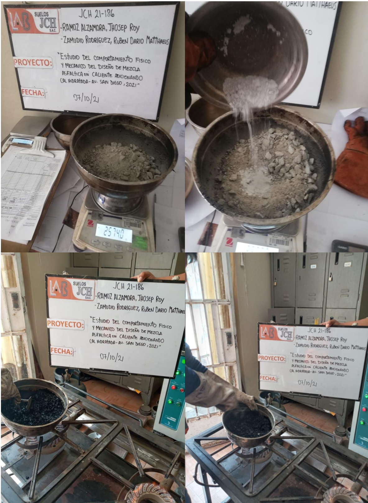
Fotografía 14: Cuantificación del agregado, cemento asfáltico, cal hidratada y proceso de mezclado.
