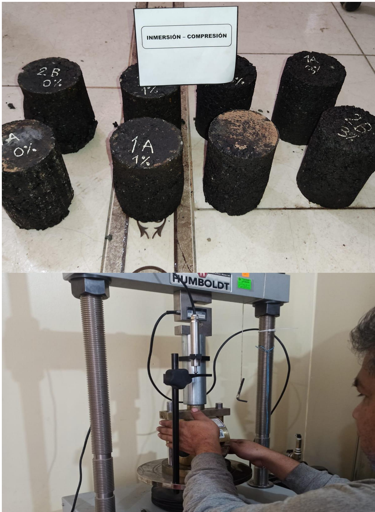
Fotografía 22: Segundo grupo de briquetas de mezclas asfáltica para el ensayo de resistencia inmersión – compresión.
