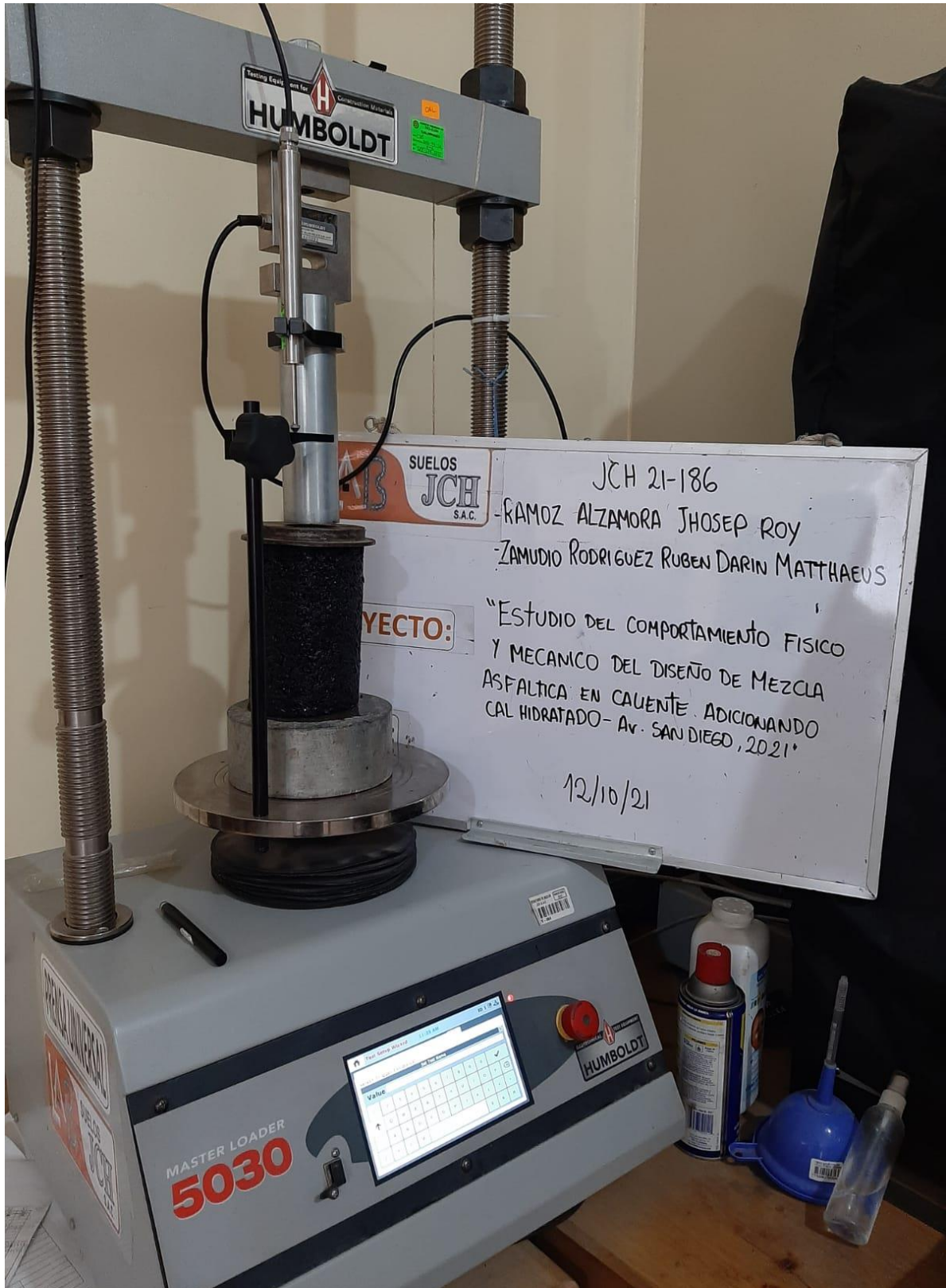
Fotografía 19: Briqueta de mezclas asfáltica en ensayo de resistencia inmersión – compresión.
