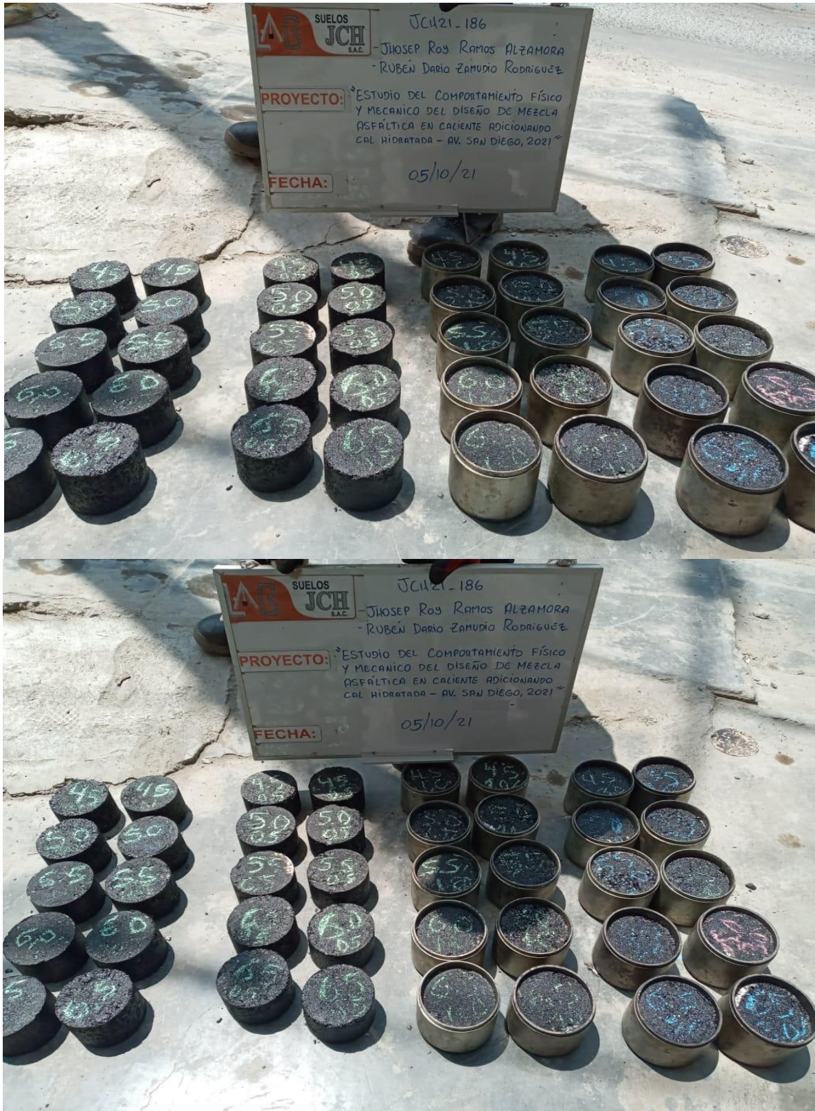
Fotografía 6: Elaboración de 40 briquetas Marshall con los diferentes porcentajes de cal hidratada.
