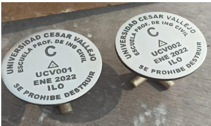
Figura 3: Placas de Bronce para Puntos Geodésicos de Orden C.
