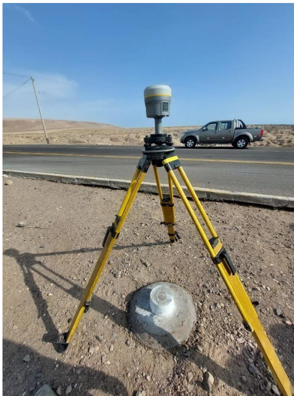
Figura 5: Medición de punto geodésico de orden "C" con GNSS Diferencial Trimble R10.
