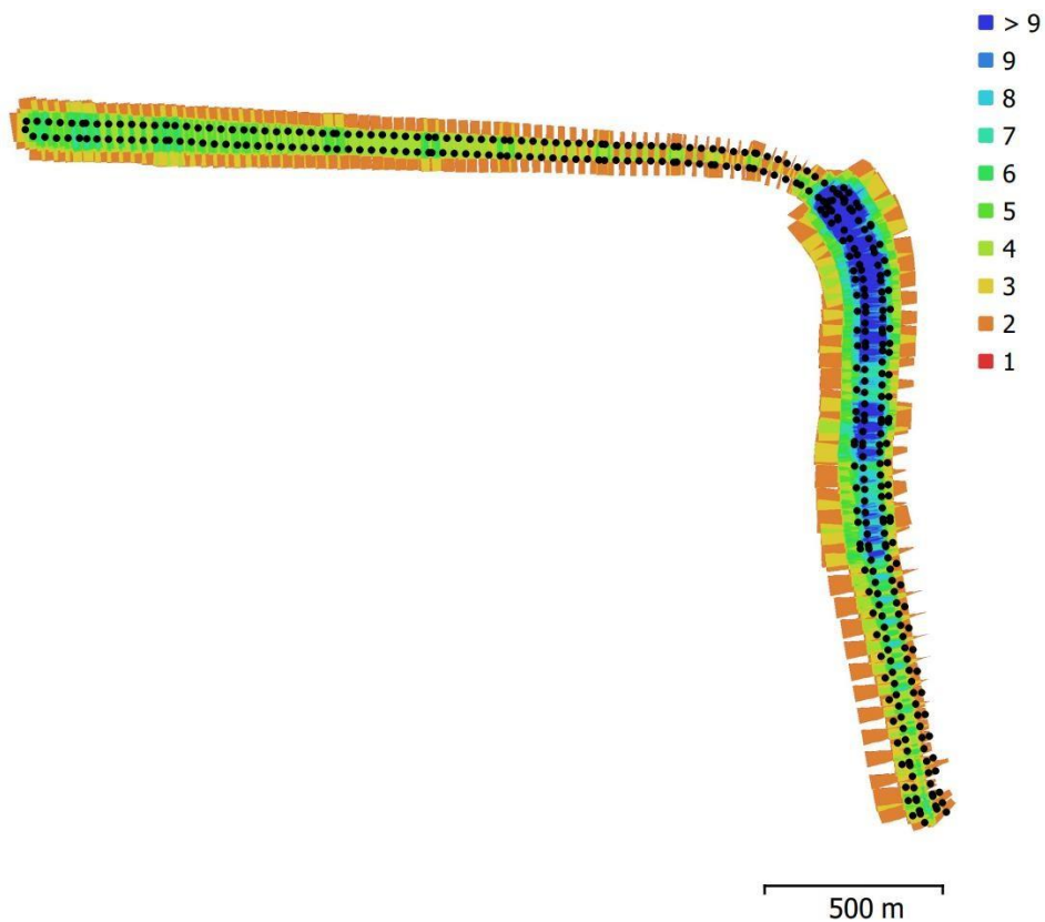
Figura 25: Posiciones de cámara y solapamiento de imágenes.
