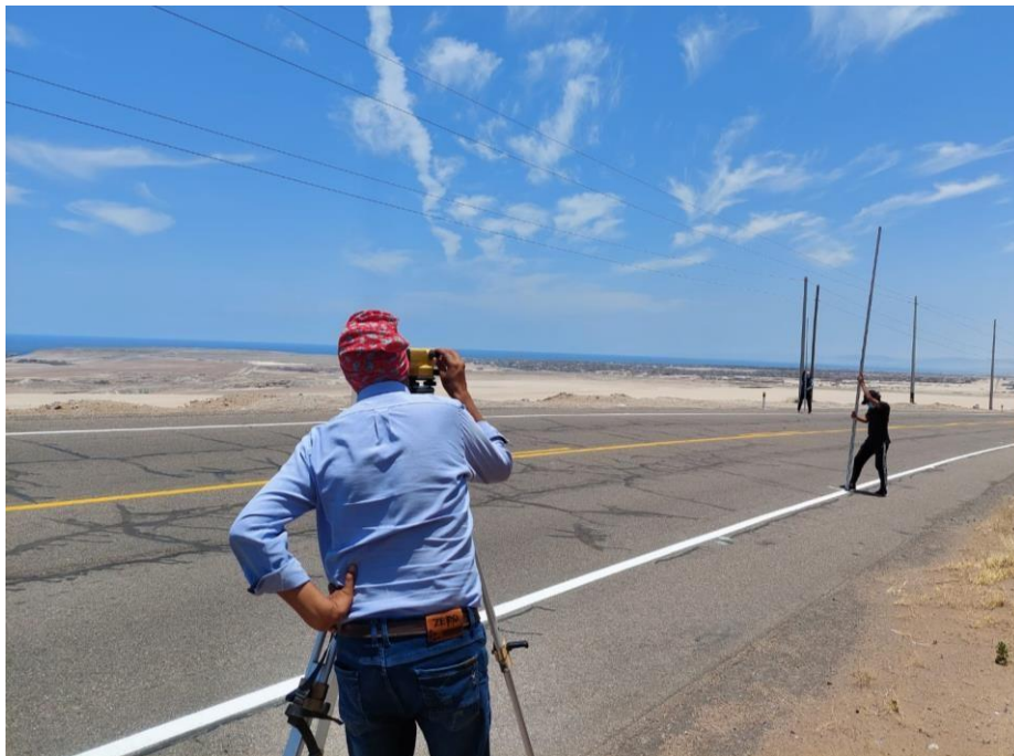
Figura 11: Recolección de data en campo con Nivel de Ingeniero.
