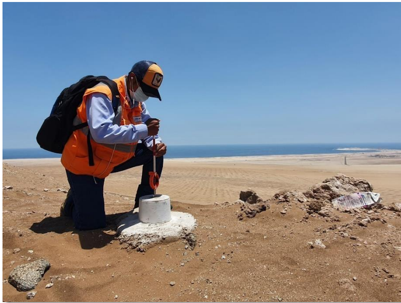
Figura 15: Medición de las coordenadas del punto de Control Geodésico de Orden C con Estación Total.
