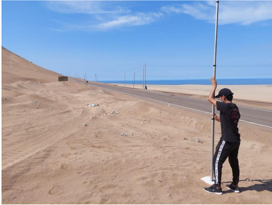
Figura 10: Medición de Elevación de Punto de control Auxiliar en el KM 37+000.
