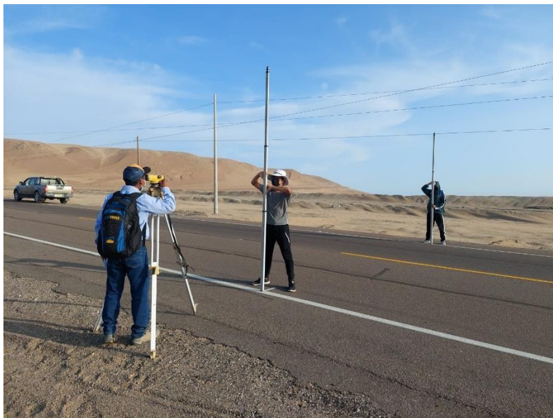
Figura 9: Jomada en campo de levantamiento altimétrico con Nivel de Ingeniero en la Carretera Interoceánica Sur.
