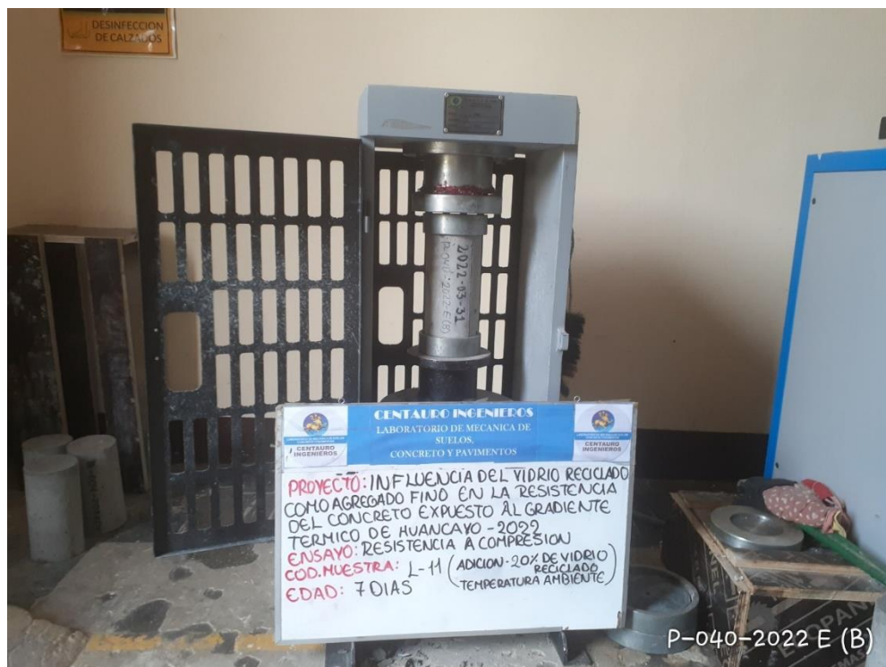
FOTOGRAFÍA N° 21: Rotura de testigo con 20 % de vidrio en la máquina de compresión uniaxial
