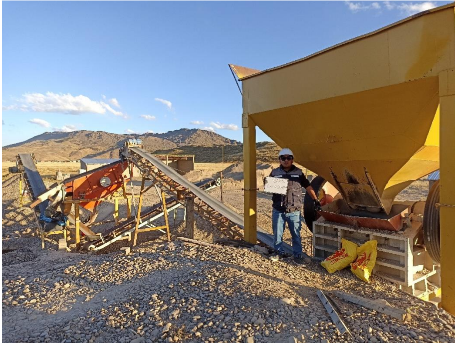
FOTOGRAFÍA N°5 Colocación de vidrio reciclado en la planta chancadora de agregados
