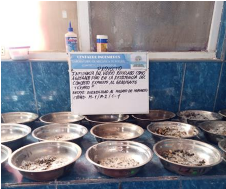
FOTOGRAFÍA N° 13: Ensayo de durabilidad al sulfato
