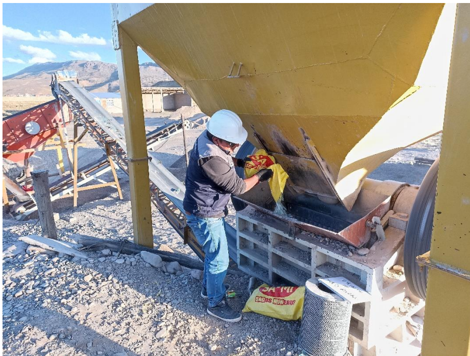
FOTOGRAFÍA N°5 Colocación de vidrio reciclado en la planta chancadora de agregados
