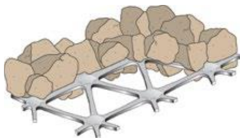
Figura 8: Estructura geomalla Tensar TriAx. Fuente: (Tensar, 2016).
