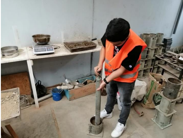
Figura 44: Compactación por capas para el ensayo CBR.
