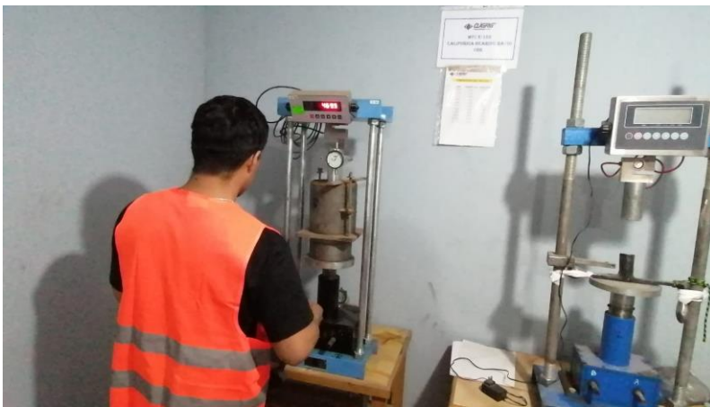
Figura 45: Ensayo de CBR.
