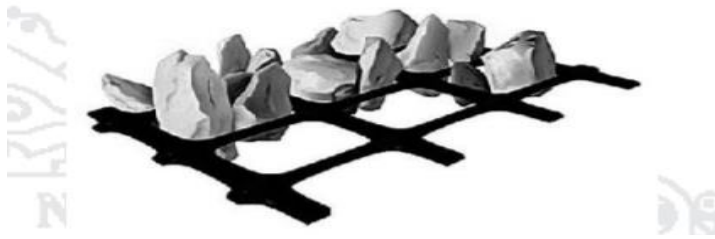
Figura 7: Geomalla biaxial o biorientadas. Fuente: (GEOSISTEMAS PAVCO DE MEXICHEM, 2009).
