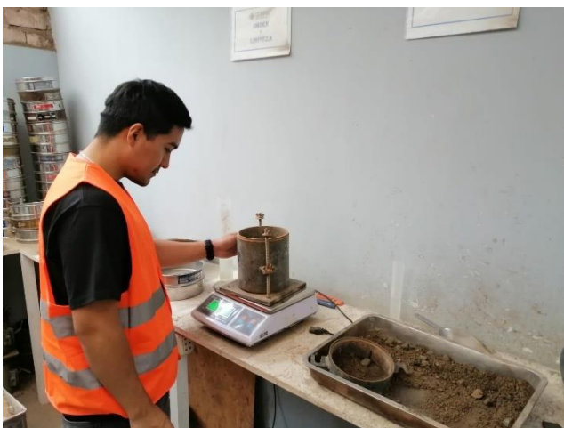
Figura 43: Ensayo de CBR.
