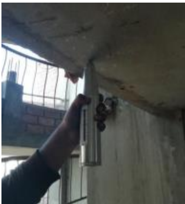
FOTO 11: Procedimiento para ensayo de esclerometría en Col. 02 de la vivienda ubicada en Psje. Alfonso Ugarte Mz. 18 Lt. 28.
