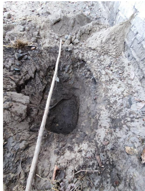
FOTO 5 y 6: Medición y extracción de muestra de la calicata C – 3.
