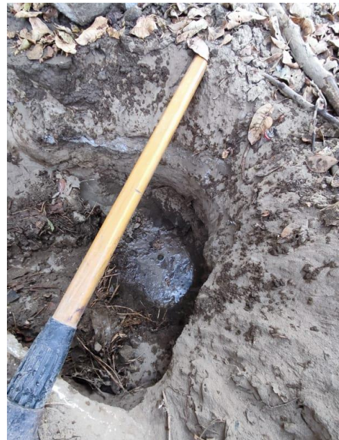
FOTO 3 y 4: Medición y extracción de muestra de la C – 2 con N.F. = 0.70 m.
