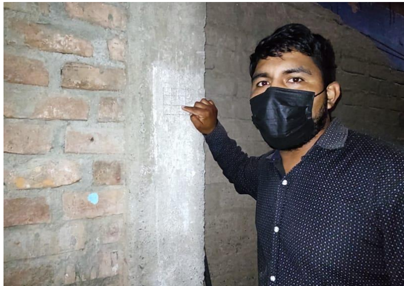
FOTO 10: Procedimiento para ensayo de esclerometría en Col. 01 de la vivienda ubicada en Psje. Mariscal Ureta Mz. 15 Lt. 27.
