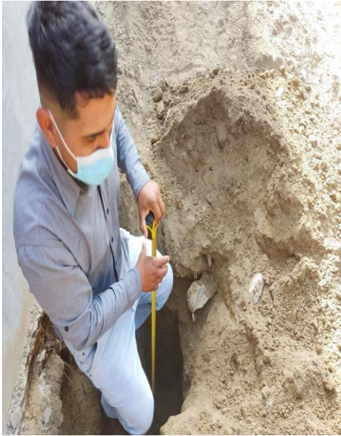
FOTO N°1 y 2: Medición y extracción de muestra de la calicata C – 1.
