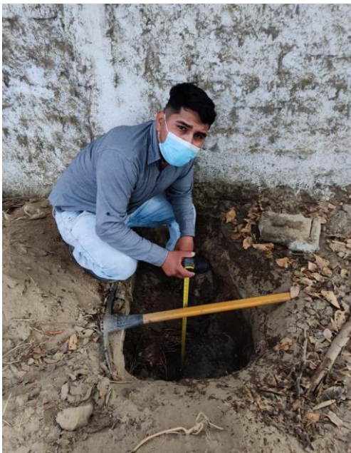
FOTO 3 y 4: Medición y extracción de muestra de la C – 2 con N.F. = 0.70 m.
