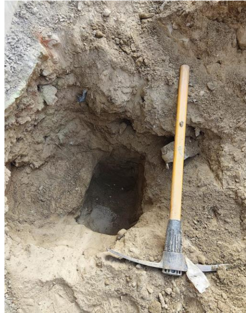
FOTO N°1 y 2: Medición y extracción de muestra de la calicata C – 1.
