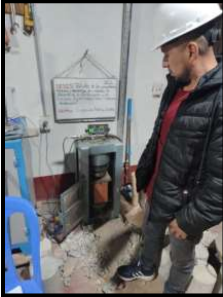
Figura 9. Compresión axial por unidad del Bloquer de arcilla
