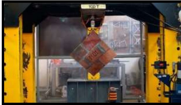
Figura 13. Ensayo por compresión diagonal (murete)
