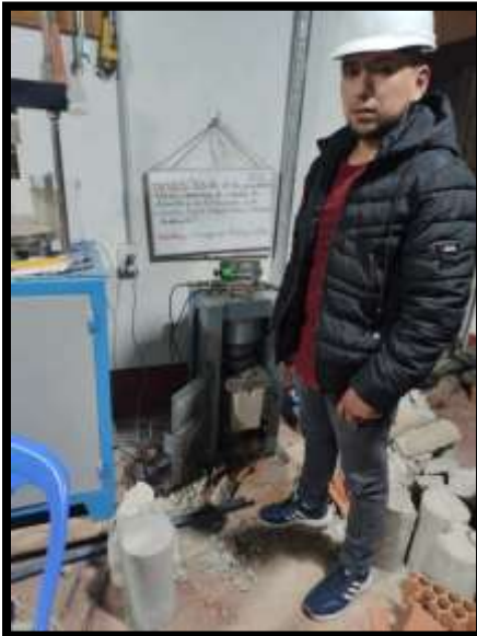
Figura 9. Compresión axial por unidad del Bloquer de arcilla
