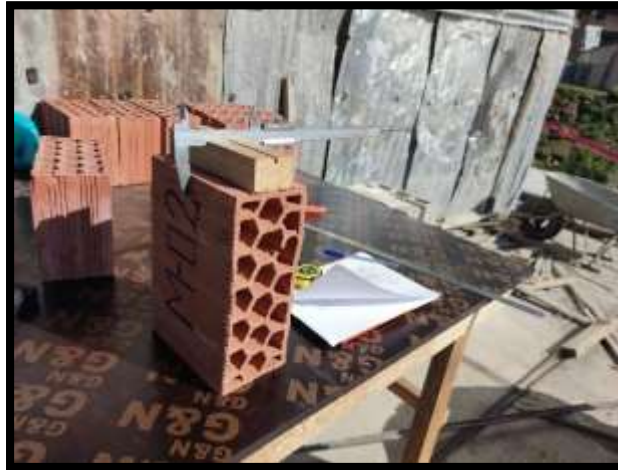
Figura 7. Variación dimensional de Bloquer de arcilla
