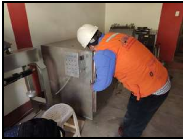
Figura 11. Colocación de muestras en el horno para ensayo de succión y absorción
