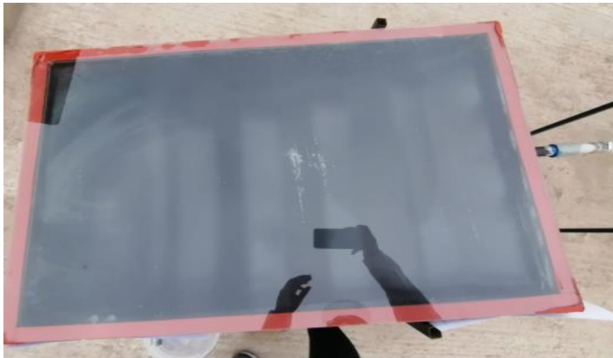
Figura 85. Destilador solar con una medida de 85 cm de largo x 60 cm de ancho, cubierta por un vidrio de 4 mm de espesor
