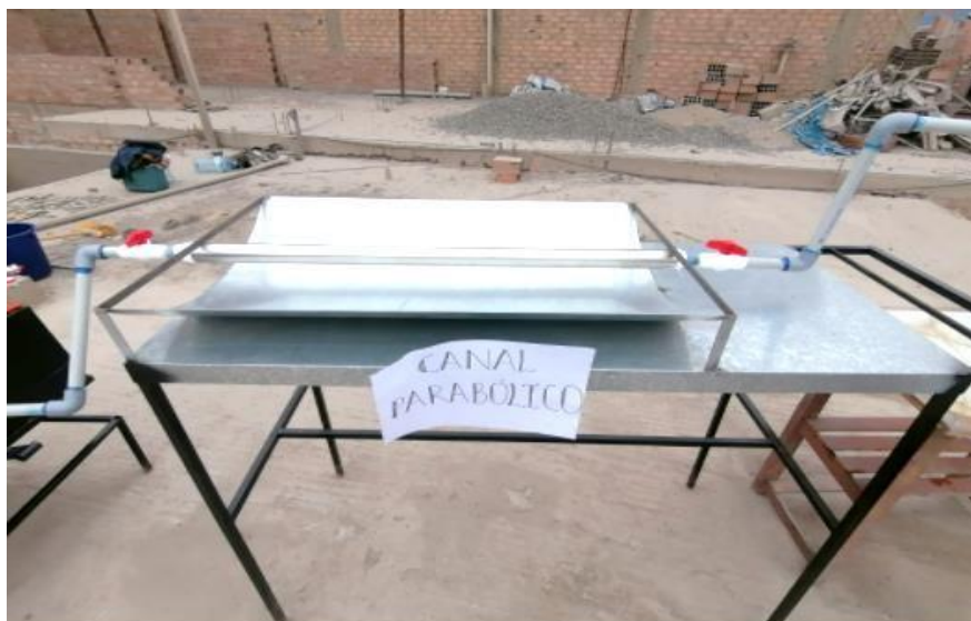
Figura 83. Canal parabólico con una medida de 70 cm de largo x 52.30 cm de ancho
