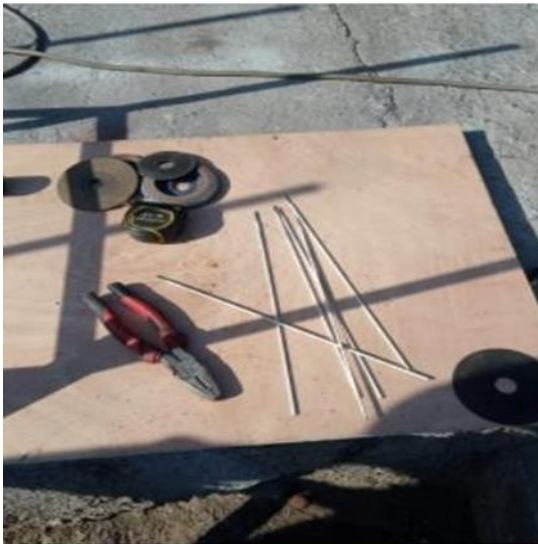
Figura 58. Soldadura de 3/34 con discos de corte de 4 pulg x 1 ml de espesor.
