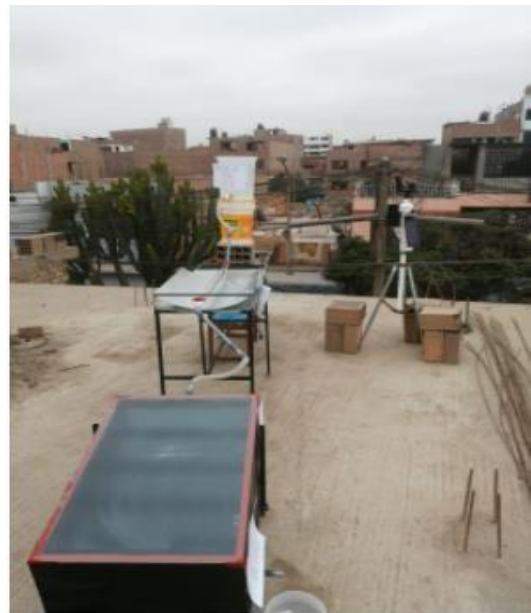
Figura 80. Con la brújula Brunton, se realizó la instalación del destilador solar que tuvo una dirección 305^\circ al noroeste
