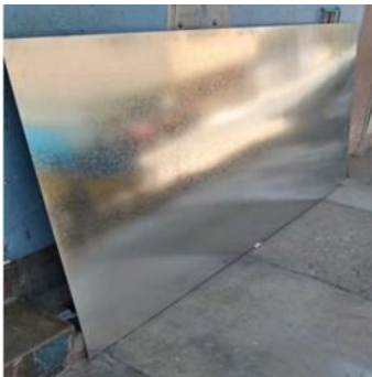
Figura 49. Plancha galvanizada de 1/16 de 3 mm de espesor
