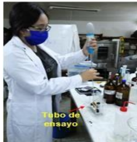
Figura 25. Se añadió 3 ml de dicromato de potasio y ácido sulfúrico
