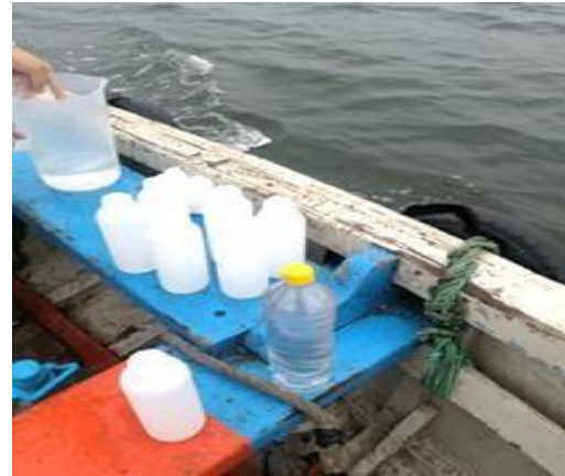
Figura 11. El frasco se sumergió a 20-30 cm de la superficie
