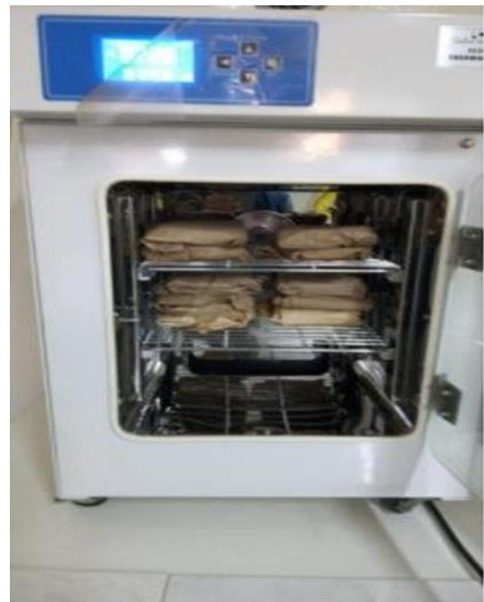
Figura 42. Diluciones para el sembrado se llevó a la incubadora por 24 h a 36°
