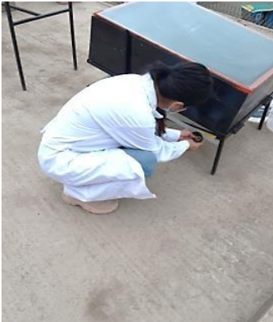
Figura 86. Con la escuadra de combinación se midió el ángulo de inclinación que fue de 14^\circ
