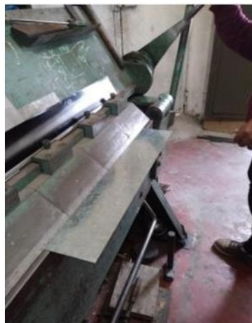
Figura 54. Doblado de las cajas internas y externas del destilador
