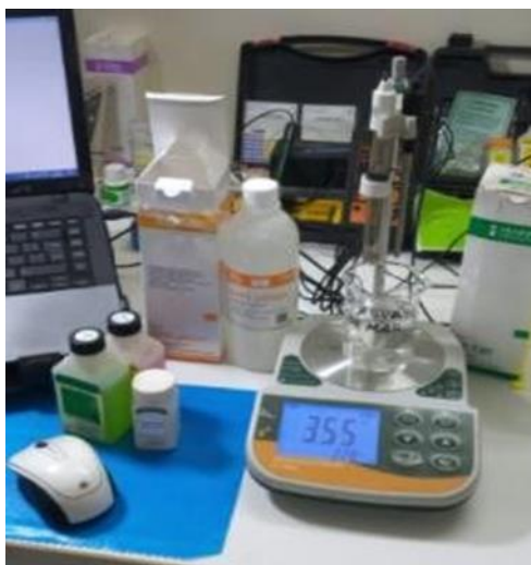
Figura 17. Medición de la T° con el multiparámetro
