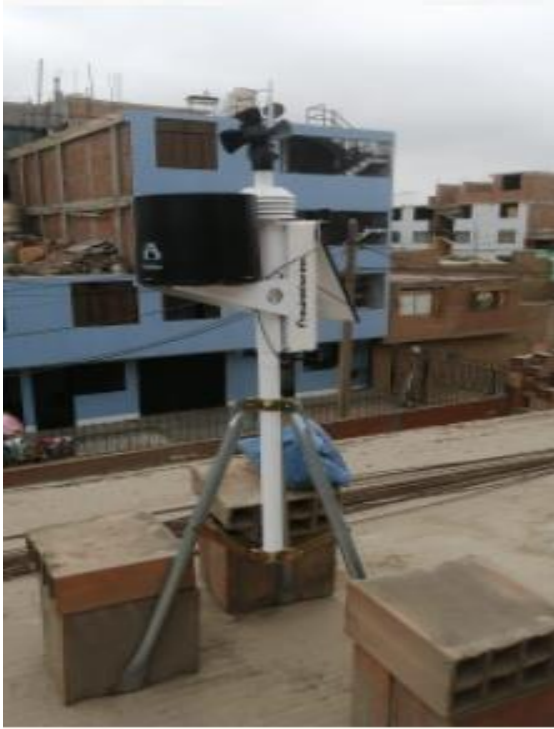
Figura 79. Instalación de la estación meteorológica inalámbrica Pro W / Caoba Base Unit
