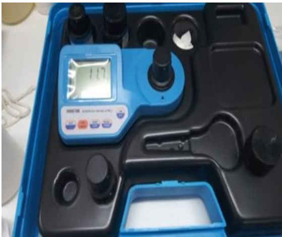
Figura 43. El espectrofotómetro ultravioleta midió los Nitratos NO 3 -
