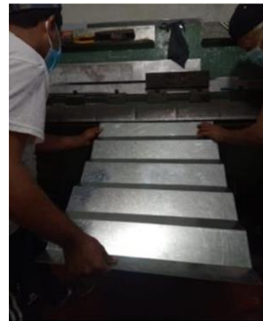
Figura 55. Doblado de las escaleras escalonadas
