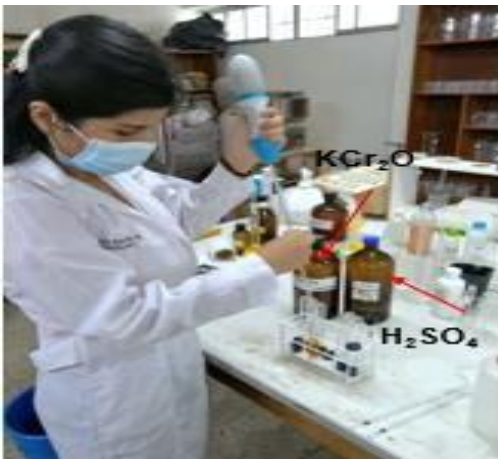
Figura 25. Se añadió 3 ml de dicromato de potasio y ácido sulfúrico
