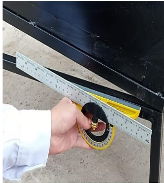
Figura 86. Con la escuadra de combinación se midió el ángulo de inclinación que fue de 14^\circ
