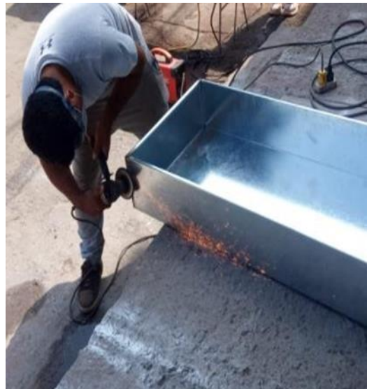
Figura 59. Disco de corte para alisar los bordes de la caja del destilador
