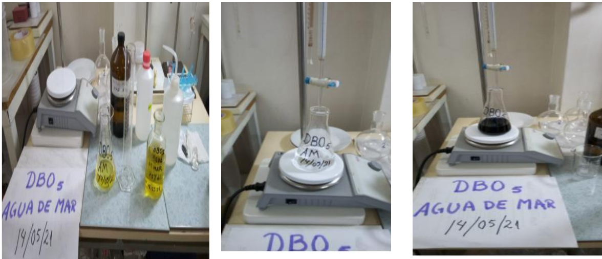
Figura 29. Se midió 30 ml de la solución del agua de mar en la probeta y se transfirió a un matraz, se tituló antes y al final
