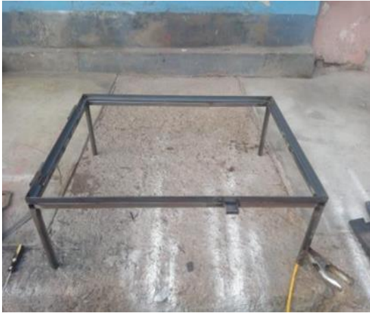
Figura 64. Base con tubos cuadrado y fierro ángulo de 85 cm largo, 60 cm de ancho y 30 cm de alto
