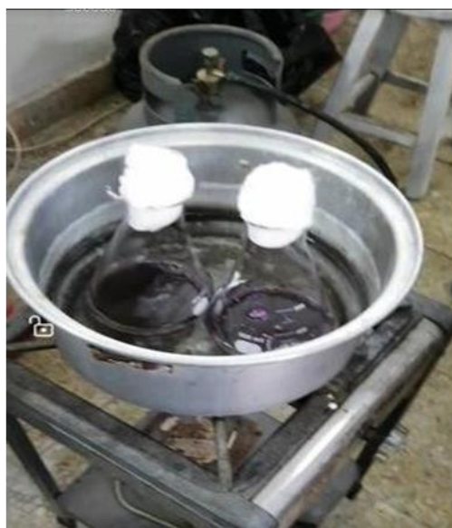
Figura 40. Se añadió 115 ml de h 2 o destilada a cada matraz y se llevó a baño maría por 30 min
