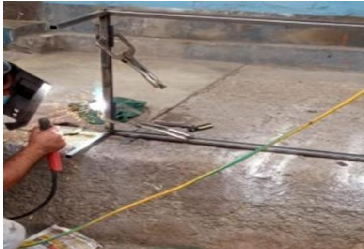
Figura 63. Soldadura de la base del destilador solar
