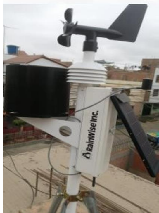
Figura 79. Instalación de la estación meteorológica inalámbrica Pro W / Caoba Base Unit
