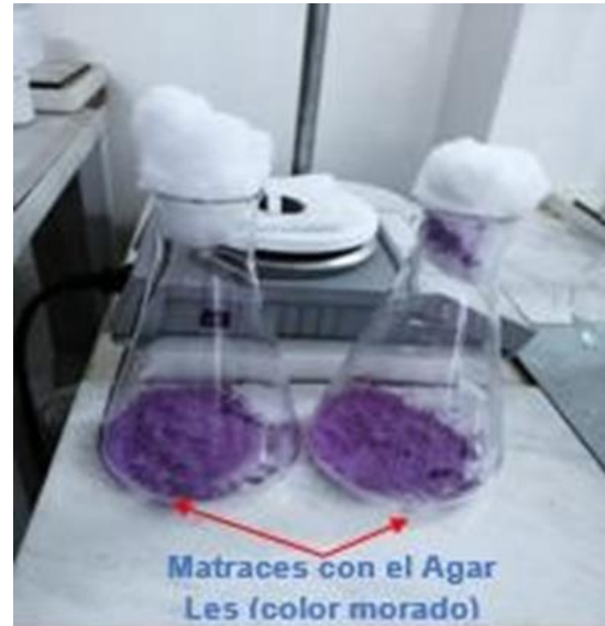
Figura 37. Matraces con el reactivo Agar M – Endo Les
