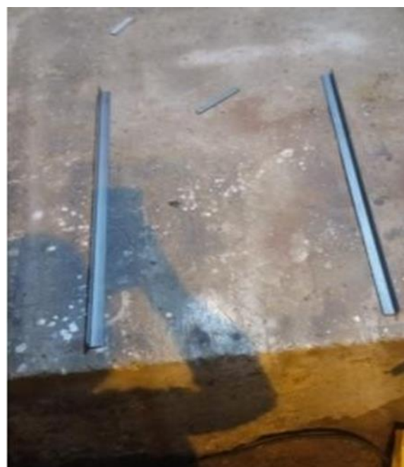
Figura 62. Corte del tubo cuadrado y ángulo para la base del destilador solar
