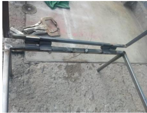
Figura 65. Se colocó 2 bisagras de \frac{1}{2} para el ángulo de inclinación
