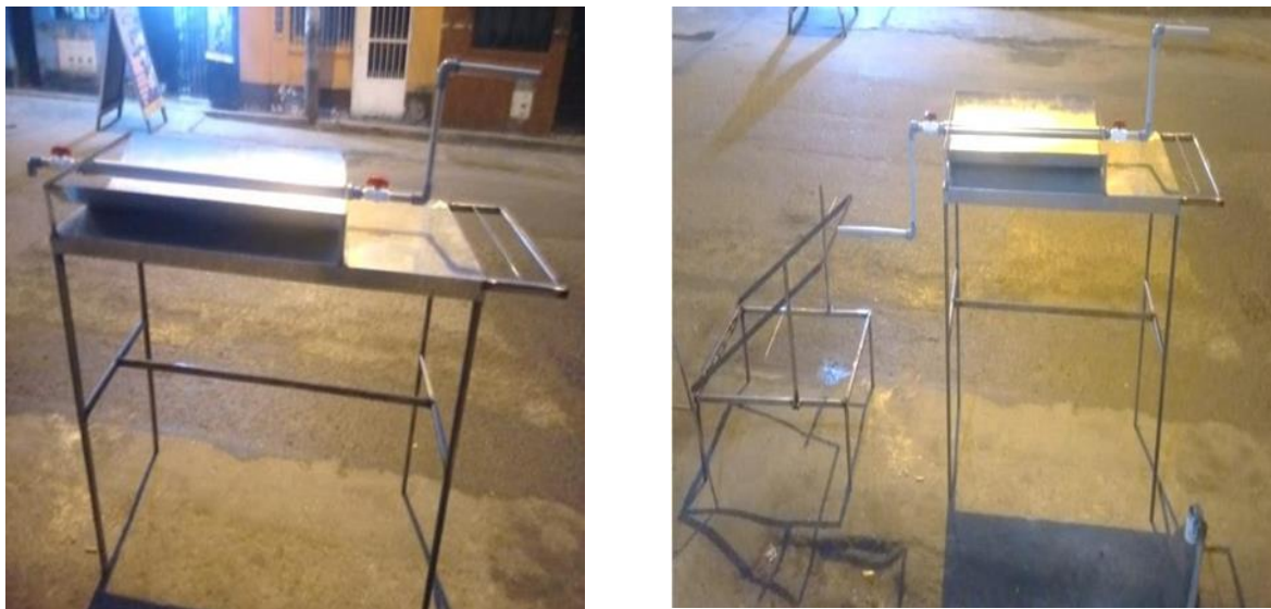
Figura 75. Vista final del destilador solar con las conexiones de PVC y la estructura metálica.
