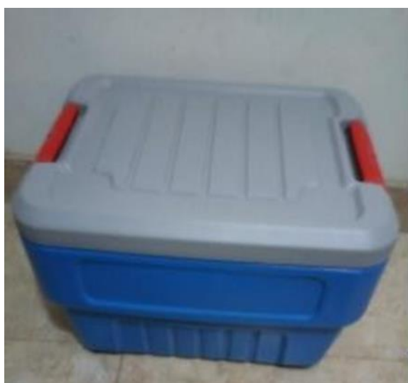
Figura 15. Acondicionamiento de 1 L de muestra para análisis de DBO
