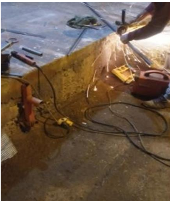
Figura 62. Corte del tubo cuadrado y ángulo para la base del destilador solar
