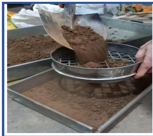
FOTOGRAFÍAS 1 Y 2 Recibimiento de la muestra (Tierra de chacra) y el tamizado por el tamiz \frac{3}{4} pulg.
