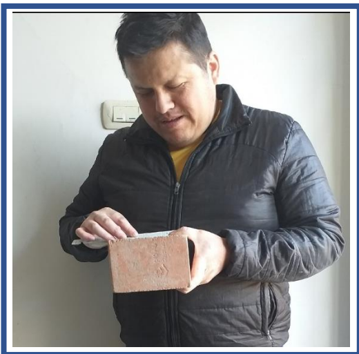
FOTOGRAFÍA 15 y 16. Ejecutando las medidas de la unidad de albañilería.
