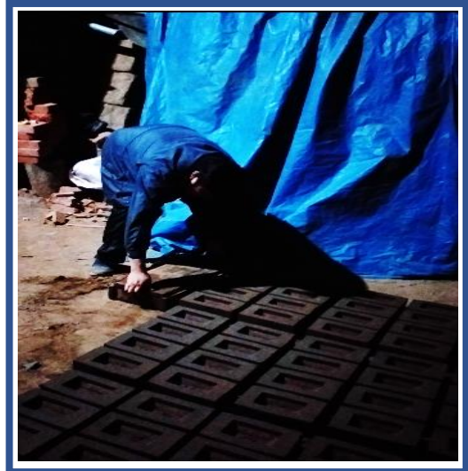
FOTOGRAFÍA 9 y 10. Preparación de ladrillos con la agregación de tierra de chacra
