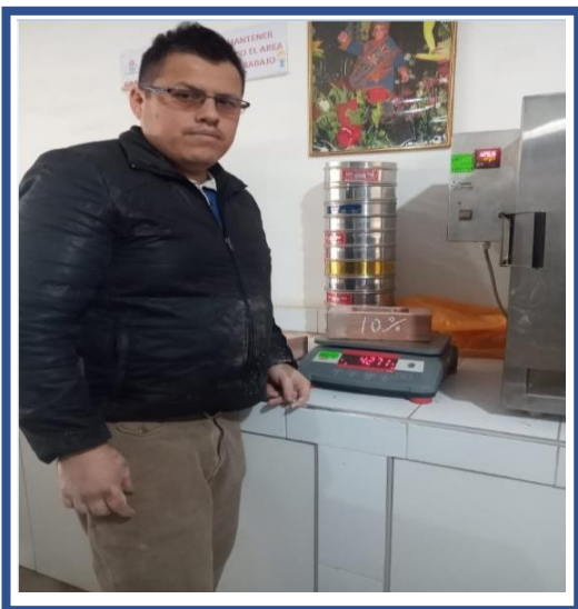
FOTOGRAFÍA 35 y 36. Pesado de la unidad de albañilería con la dosificación del 10%, 15% de tierra de chacra mutuamente, pasadas las 24h en el agua.
