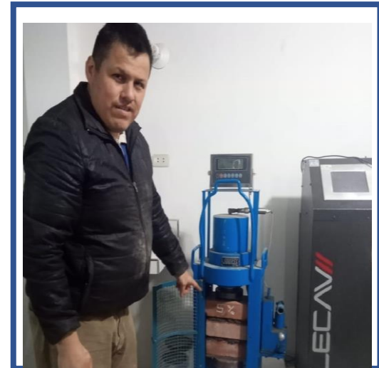
FOTOGRAFIA 39 y 40. Introduciendo las pilas de las unidades de albañilería con incorporación de tierra de chacra a la maquina compresora para la prueba respectivamente.
