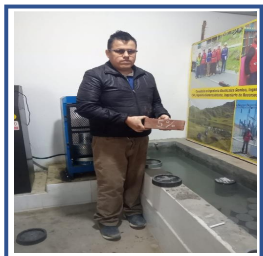
FOTOGRAFIA 29 y 30. Sumergiendo a la unidad de albañilería al agua por 24h.
