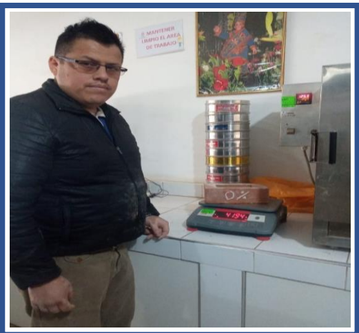
FOTOGRAFÍA 23 y 24. Pesado de los ladrillos patrón y con la incorporación de 5% de tierra respectivamente.
