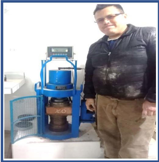
FOTOGRAFIA 19 y 20. Prueba a la compresión de la unidad de albañilería patrón y agregación el 5% de tierra de chacra.
