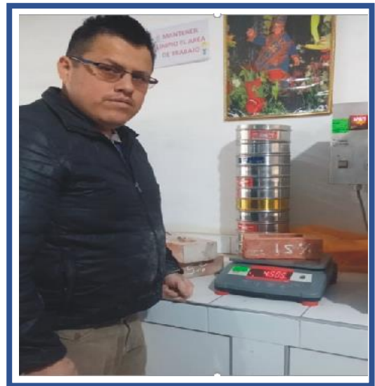
FOTOGRAFÍA 35 y 36. Pesado de la unidad de albañilería con la dosificación del 10%, 15% de tierra de chacra mutuamente, pasadas las 24h en el agua.
