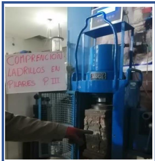
FOTOGRAFIA 41 y 42. Fractura de las pilas de las unidades de albañilería con agregación de tierra de chacra en la prensa para las pruebas respectivamente.
