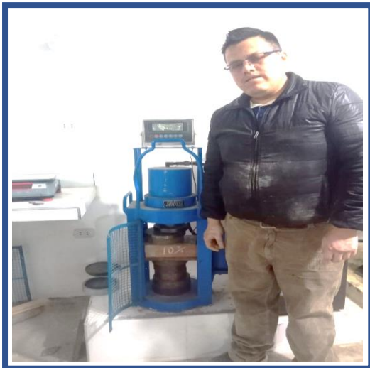
FOTOGRAFIA 21 y 22. prueba de compresión de la unidad de albañilería con el agregado del 10% y 15% de tierra de chacra.
