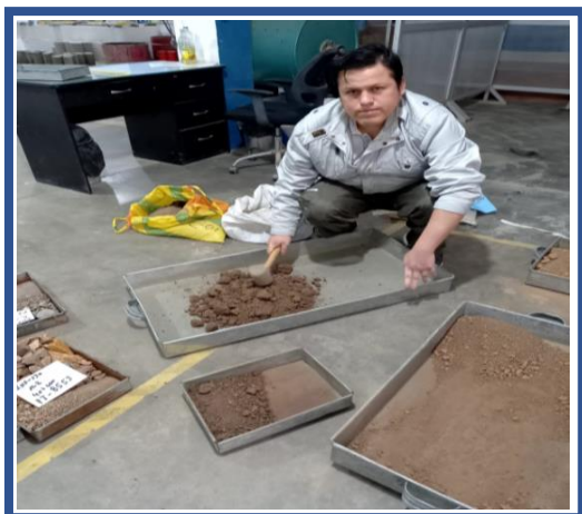
FOTOGRAFÍAS 1 Y 2 Recibimiento de la muestra (Tierra de chacra) y el tamizado por el tamiz \frac{3}{4} pulg.
