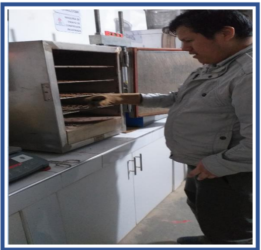
FOTOGRAFÍAS 11 Y 12 pesando la muestra mayor a 20 gramos y introduciendo al horno para el proceso de secado.
