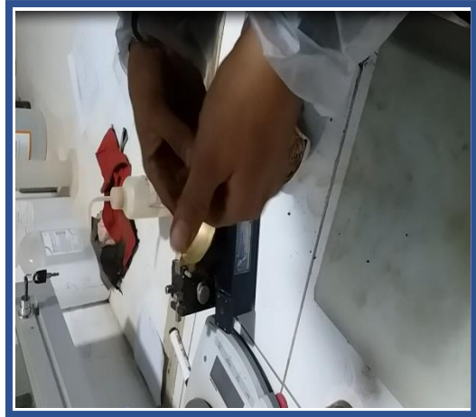
FOTOGRAFÍAS 7 Y 8 La Tierra de chacra tamizado con la malla N° 200 y el amasado para nuestro contenido de humedad.
