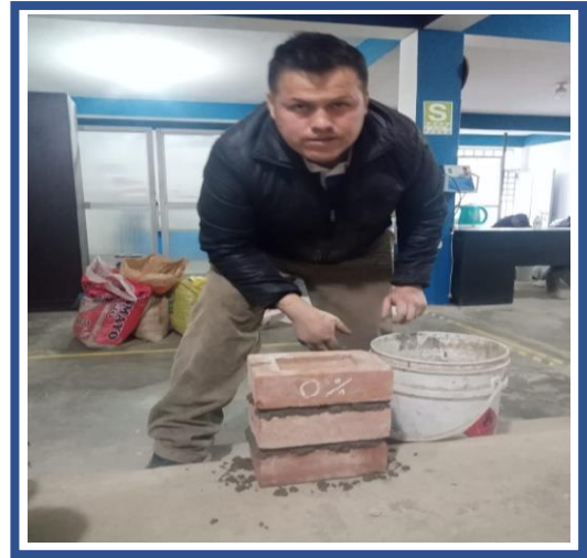
FOTOGRAFIA 37 y 38. Elaborando los ladrillos hechos en 3 hiladas respectivamente.
