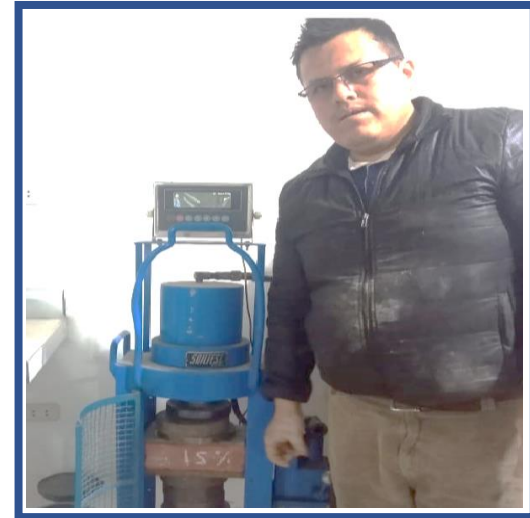
FOTOGRAFIA 21 y 22. prueba de compresión de la unidad de albañilería con el agregado del 10% y 15% de tierra de chacra.
