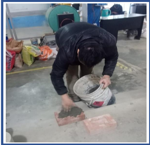
FOTOGRAFIA 37 y 38. Elaborando los ladrillos hechos en 3 hiladas respectivamente.
