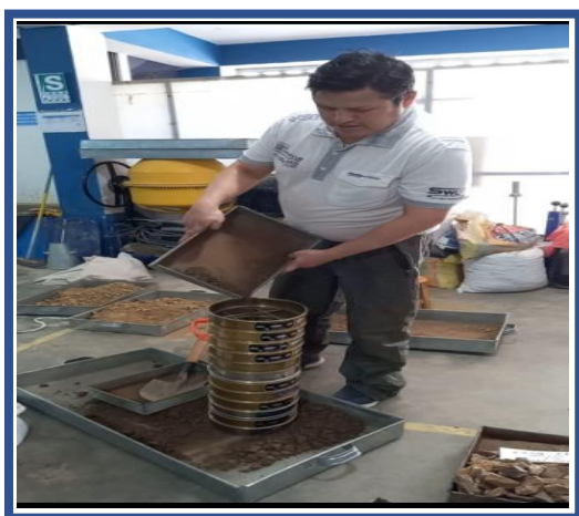
FOTOGRAFÍAS 5 Y 6 Tamizando nuestro agregado (Tierra de chacra). y el lavado por la malla N° 200
