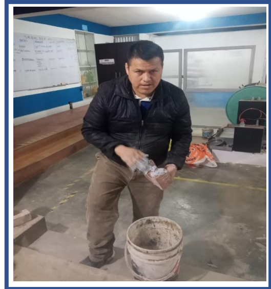
FOTOGRAFIA 13 y 14. Corte por la mitad de las unidades artesanales y recubriendo con yeso
