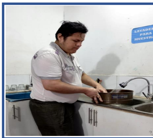
FOTOGRAFÍAS 5 Y 6 Tamizando nuestro agregado (Tierra de chacra). y el lavado por la malla N° 200
