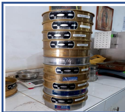
FOTOGRAFÍAS 3 Y 4 peso de la muestra (Tierra de chacra) 1 kg. y el grupo de tamices según la norma E070.
