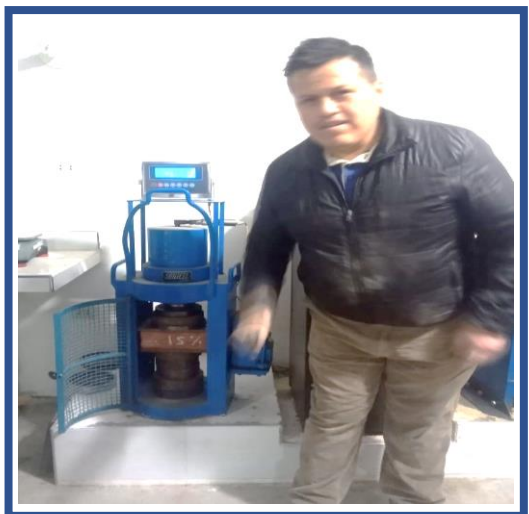
FOTOGRAFÍA 17 y 18. Colocación de las unidades de albañilería a la prensa para la compresión.
