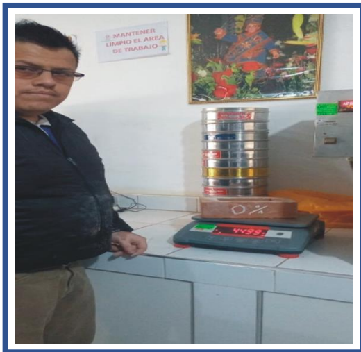
FOTOGRAFIA 33 y 34. Pesado de la unidad de albañilería patrón con la dosificación de 5% de tierra de Chacra correspondientemente, después de 1 día en el agua.
