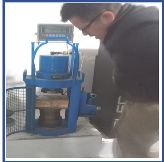
FOTOGRAFIA 19 y 20. Prueba a la compresión de la unidad de albañilería patrón y agregación el 5% de tierra de chacra.
