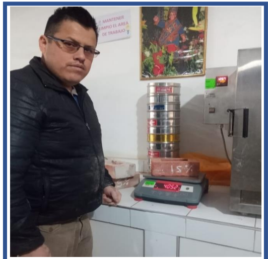
FOTOGRAFÍA 25 y 26. Pesado de los ladrillos con la incorporación de 10% y 15% de tierra de chacra respectivamente.
