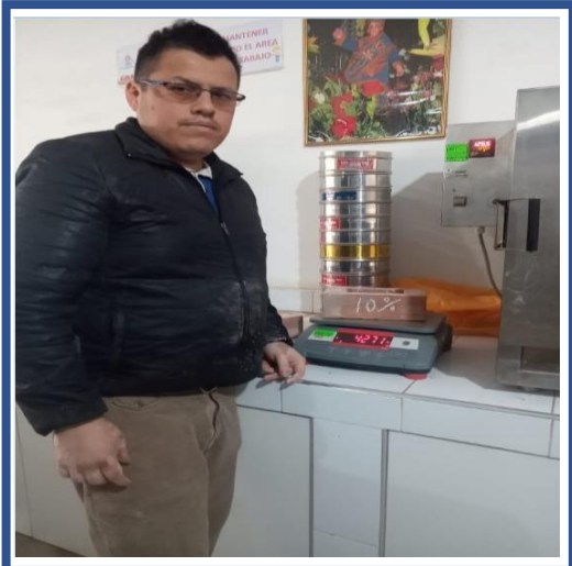
FOTOGRAFÍA 25 y 26. Pesado de los ladrillos con la incorporación de 10% y 15% de tierra de chacra respectivamente.
