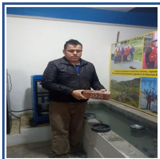
FOTOGRAFIA 29 y 30. Sumergiendo a la unidad de albañilería al agua por 24h.
