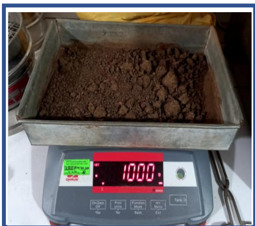
FOTOGRAFÍAS 3 Y 4 peso de la muestra (Tierra de chacra) 1 kg. y el grupo de tamices según la norma E070.
