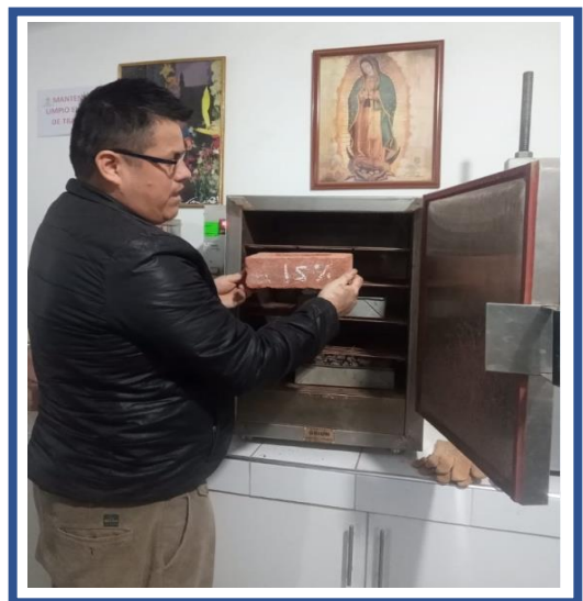
FOTOGRAFÍA 25 y 26. Pesado de los ladrillos con la incorporación de 10% y 15% de tierra de chacra respectivamente.
