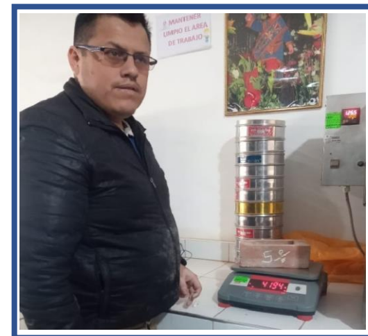
FOTOGRAFÍA 23 y 24. Pesado de los ladrillos patrón y con la incorporación de 5% de tierra respectivamente.
