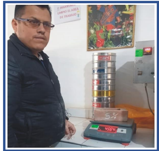
FOTOGRAFIA 33 y 34. Pesado de la unidad de albañilería patrón con la dosificación de 5% de tierra de Chacra correspondientemente, después de 1 día en el agua.
