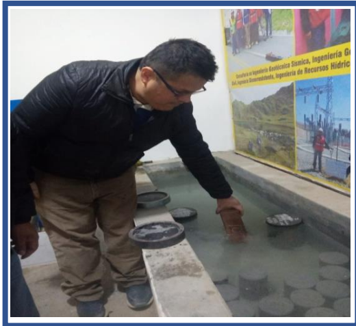
FOTOGRAFIA 31 y 32. Extracción a la unidad de albañilería luego de 1 día.
