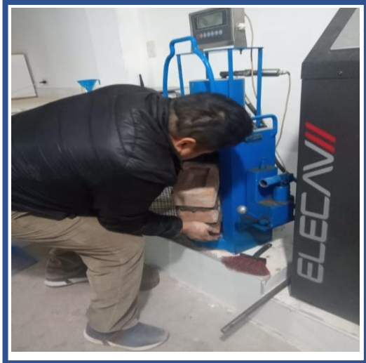
FOTOGRAFIA 39 y 40. Introduciendo las pilas de las unidades de albañilería con incorporación de tierra de chacra a la maquina compresora para la prueba respectivamente.
