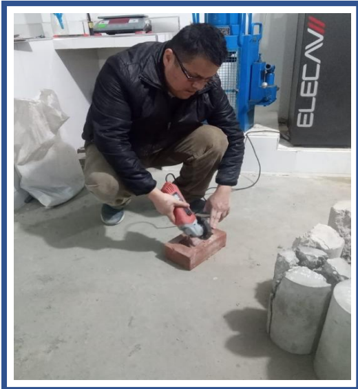
FOTOGRAFIA 13 y 14. Corte por la mitad de las unidades artesanales y recubriendo con yeso
