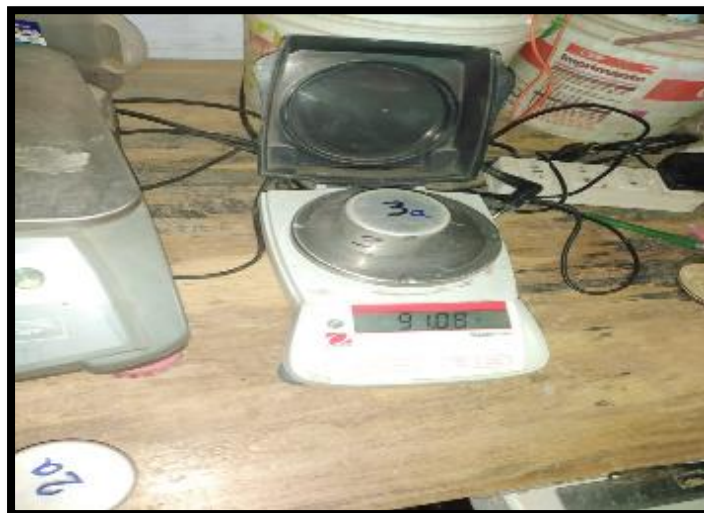
Imagen 11 : Pesado de muestra en balanza electronico
