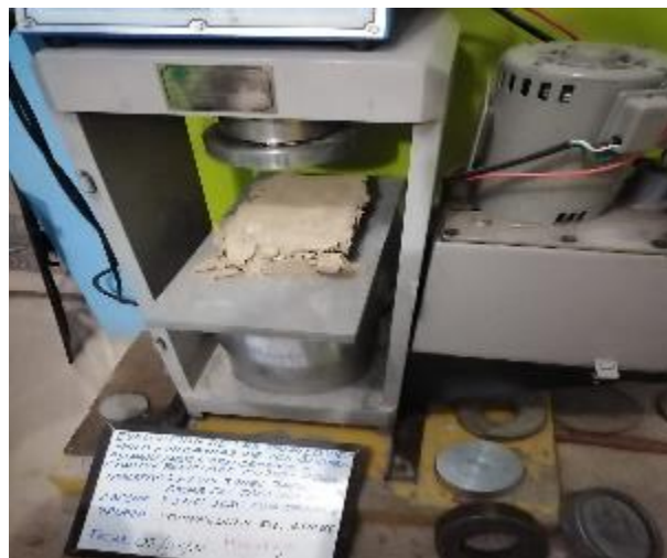
Imagen 36: Muestra después de ensayo de compresión
