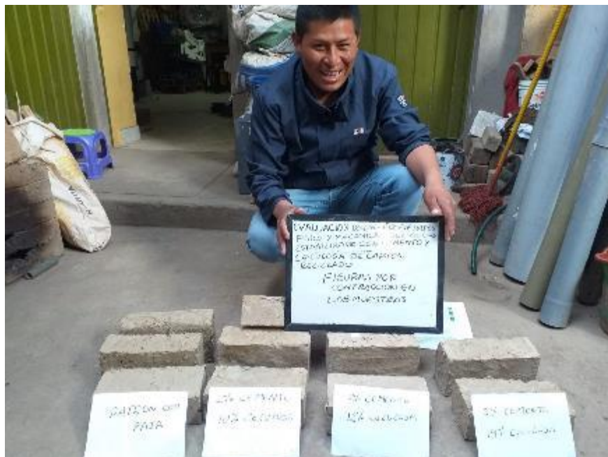
Imagen 79: verificación de fisuras de adobe de diferentes especímenes
