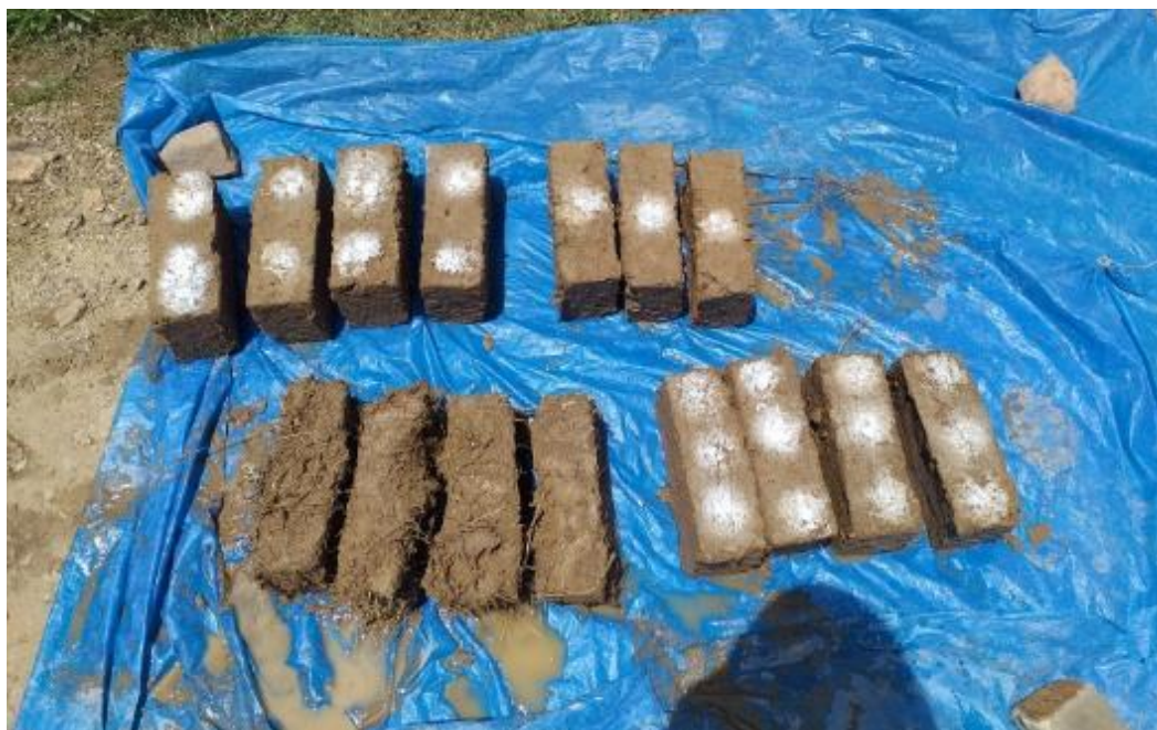
Imagen 66: Después de sumergido la muestra M1, M2, M3 Y M4
