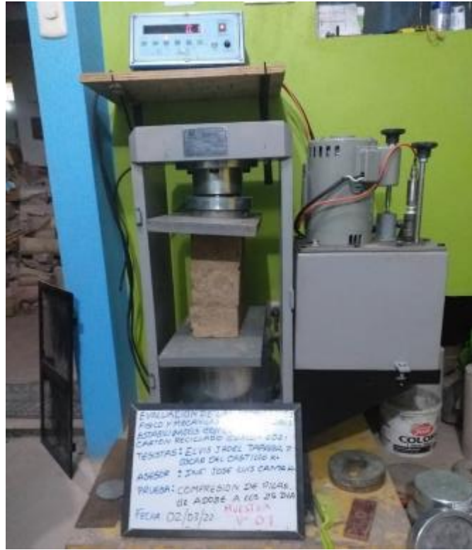
Imagen 76:Proceso resistencia a compresión de murete (pilas) tipo M1
