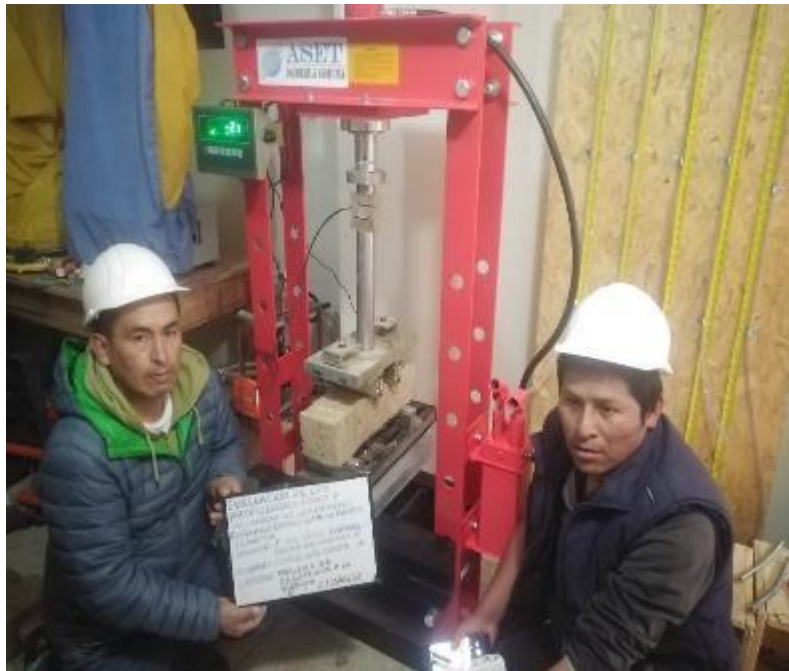
Imagen 37: Ensayo de resistencia a la flexión
