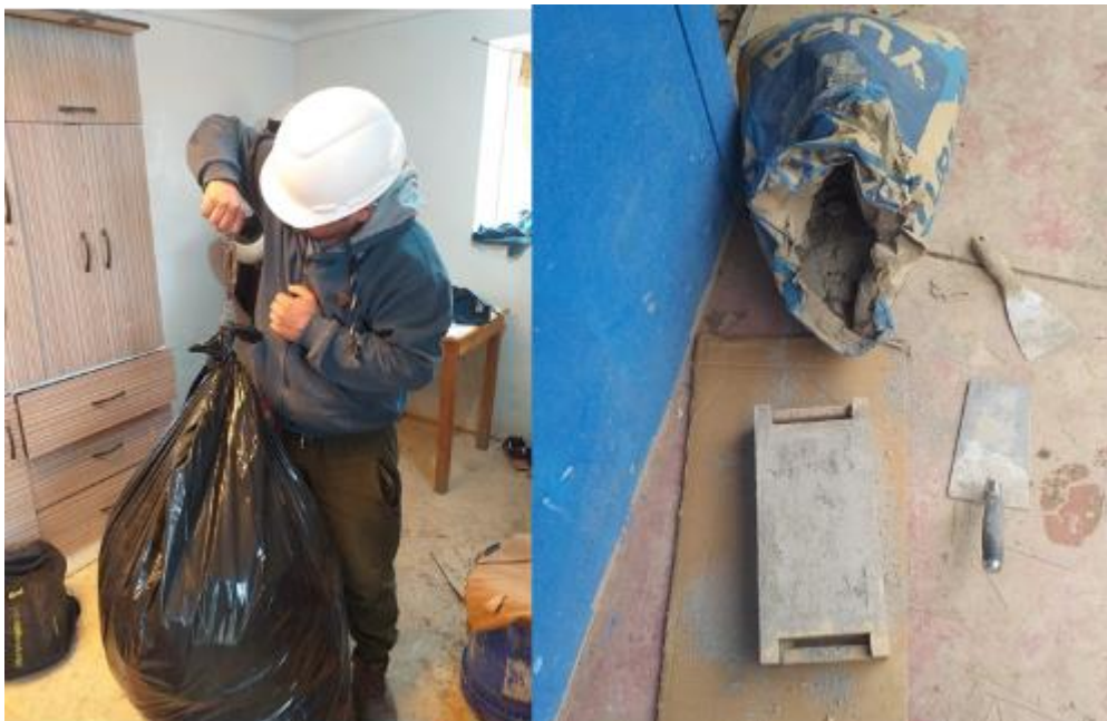
Imagen 59: Proceso de pesado de cemento y celulosa de cartón reciclado
