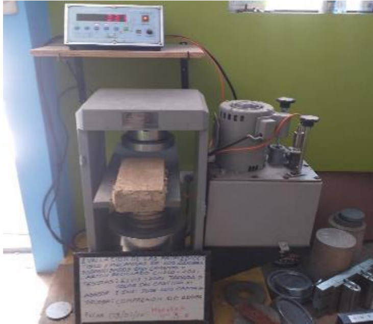
Imagen 35: Prueba de resistencia a la compresión
