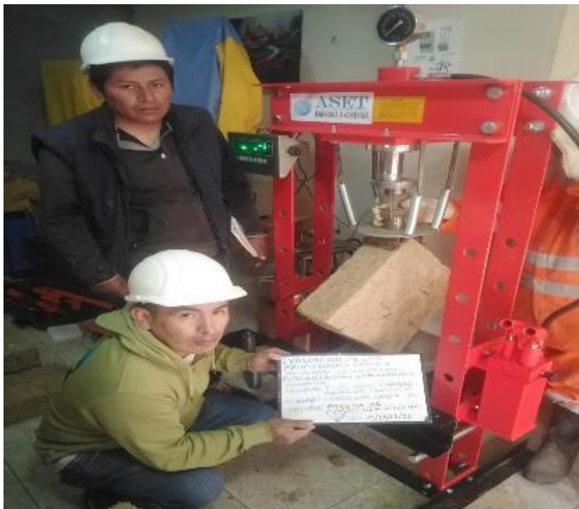
Imagen 41: Ensayo de compresión diagonal
