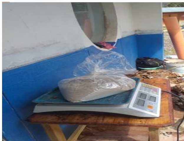
Imagen 16: Pesado de cemento para muestras
