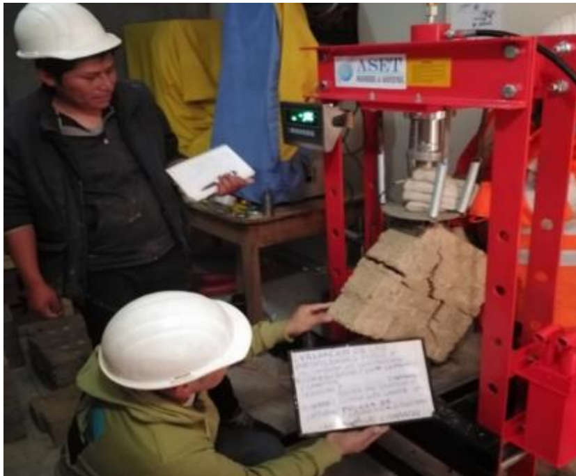
Imagen 63: Prueba de resistencia compresión diagonal de adobe
