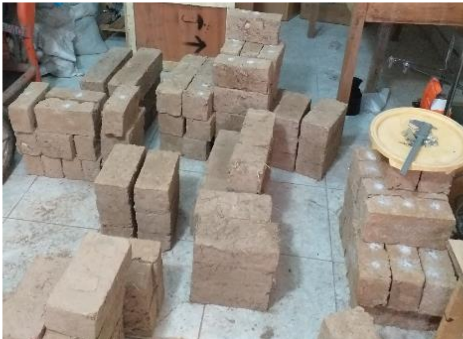
Imagen 62:Proceso de selección de adobes para su respectiva prueba en laboratorio
