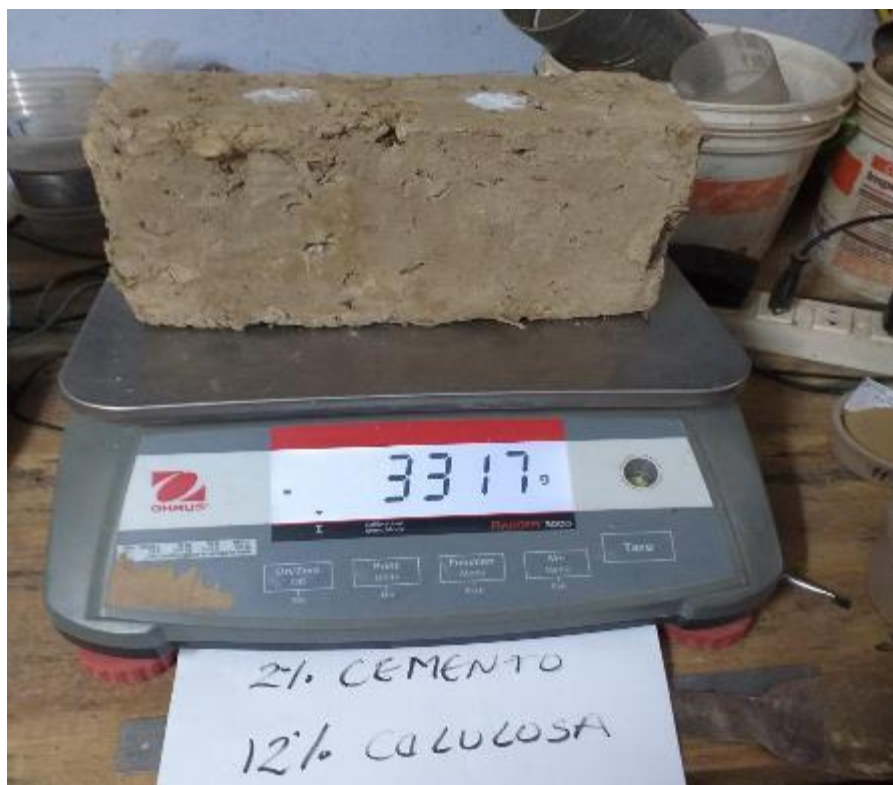
Imagen 71:Proceso de pesado de adobe con 2% cemento, 10%carton reciclado
