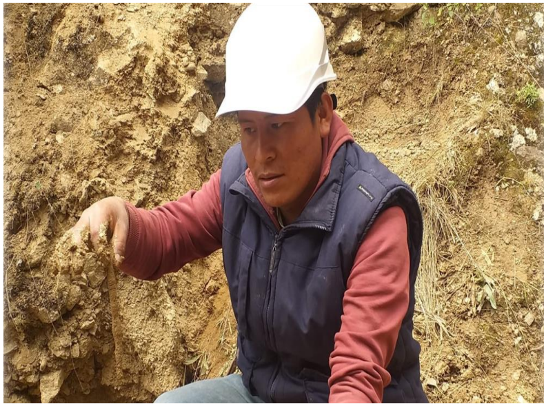
Imagen 3:Ensayo de cinta de barro.
