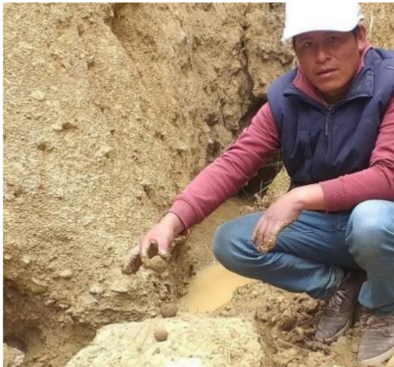
Imagen 4:Ensayo de bolitas de barro
