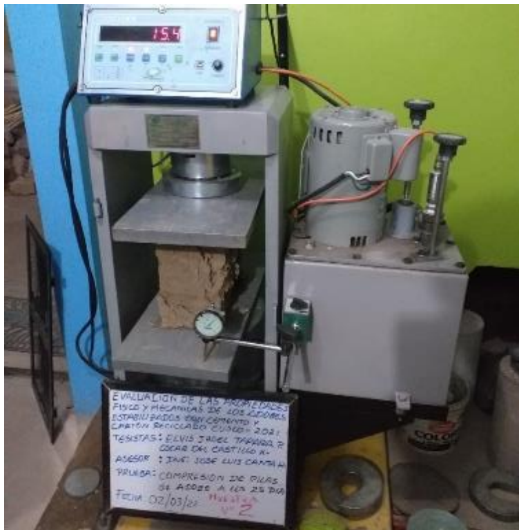
Imagen 77:proceso de resistencia a compresión de murete (pilas) adobe M2
