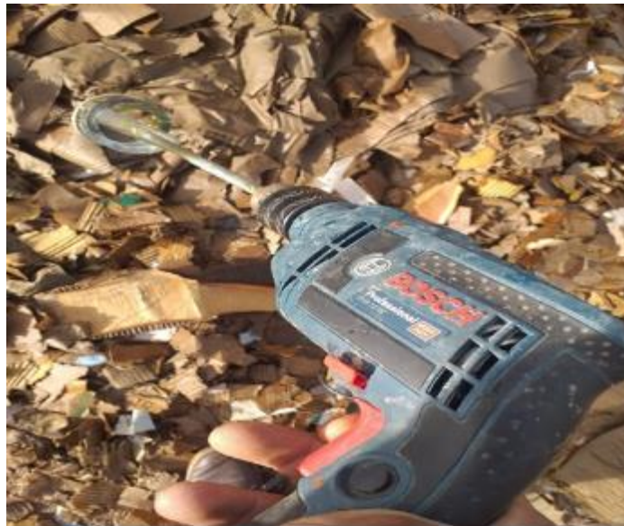
Imagen 12: Desfibrador adecuado al taladro
