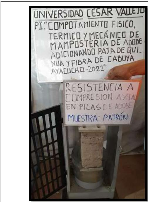
**Fotografía 60:** resistencia a compresión axial en pilas de adobe.
