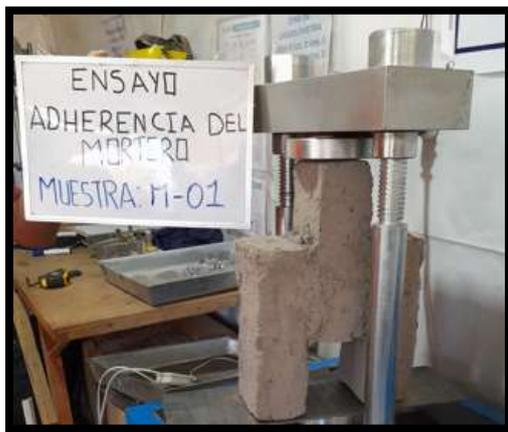
**Fotografía 70:** Ensayo de adherencia del mortero.
