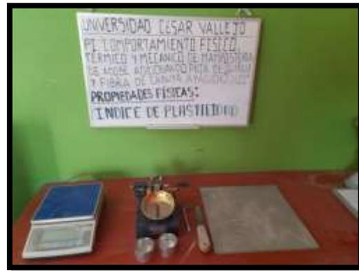
**Fotografía 35:** ensayo físico límites de consistencia
