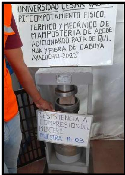
**Fotografía 50:** falla de la muestra del mortero a compresión.
