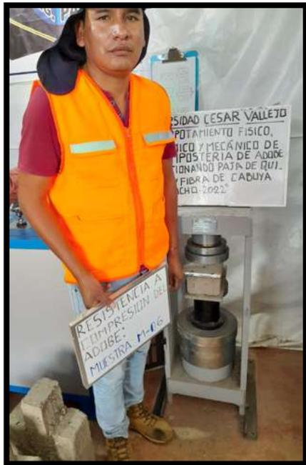
**Fotografía 44:** propiedades mecánicas (resistencia a la compresión del adobe)
