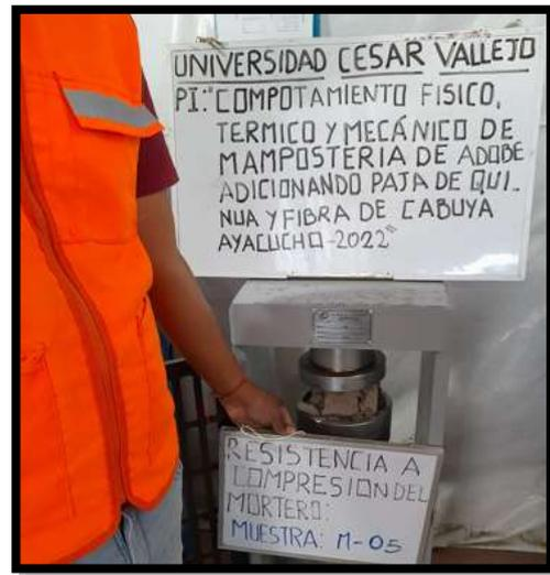
**Fotografía 55:** falla de la muestra del mortero a compresión.
