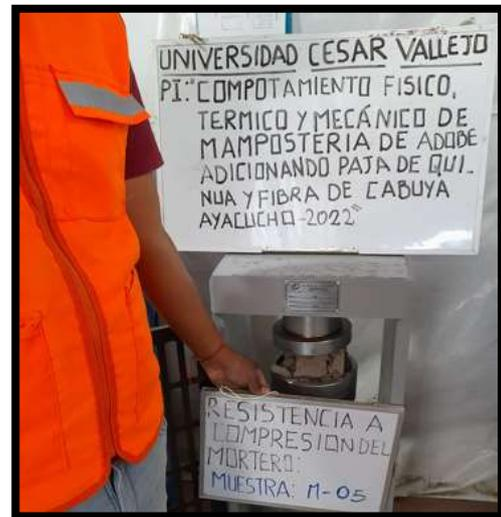
**Fotografía 51:** falla de la muestra del mortero a compresión.
