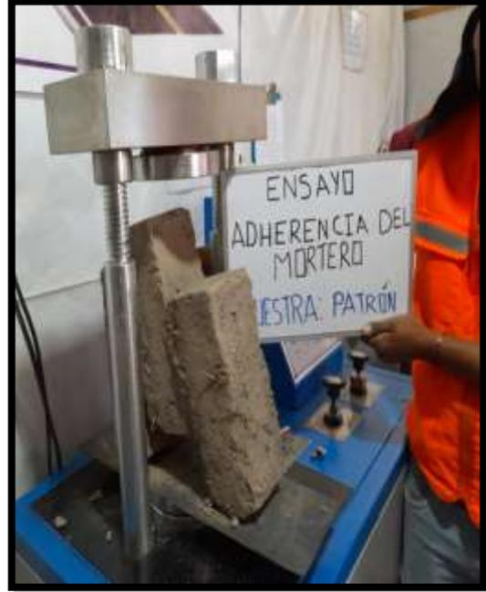
**Fotografía 73:** Ensayo de adherencia del mortero.
