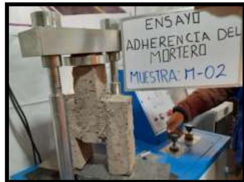
**Fotografía 71:** Ensayo de adherencia del mortero.
