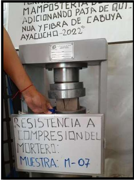
**Fotografía 56:** resistencia del mortero a compresión.
