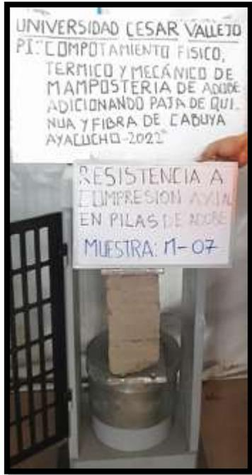
**Fotografía 68:** resistencia a compresión axial en pilas de adobe.
