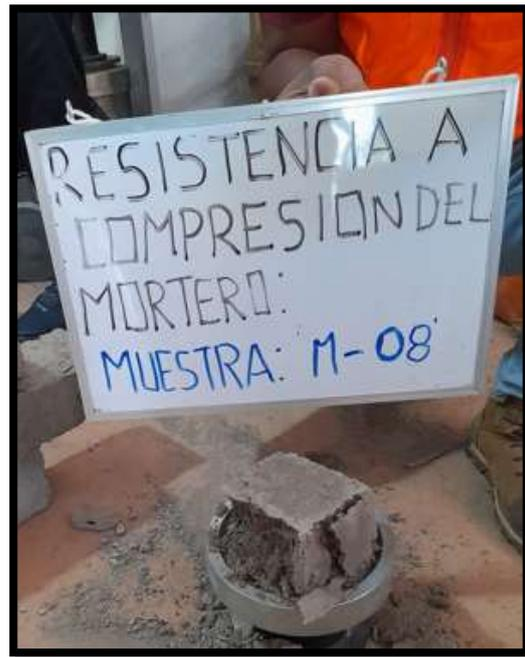
**Fotografía 59:** falla de la muestra del mortero a compresión.
