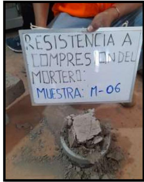
**Fotografía 57:** falla de la muestra del mortero a compresión.
