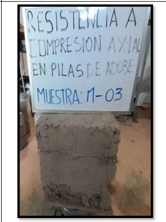
**Fotografía 67:** falla a compresión de pilas de adobe.
