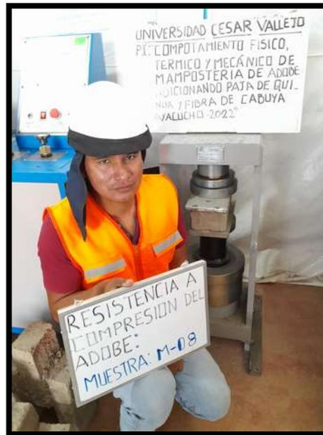
**Fotografía 45:** propiedades mecánicas (resistencia a la compresión del adobe)
