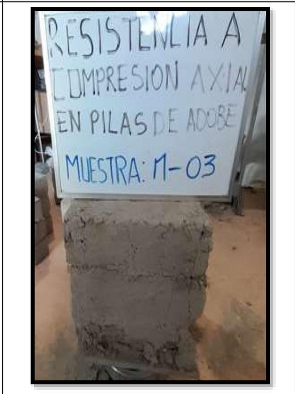
**Fotografía 63:** falla a compresión de pilas de adobe.
