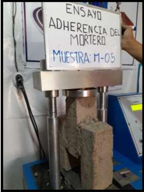
**Fotografía 72:** Ensayo de adherencia del mortero.
