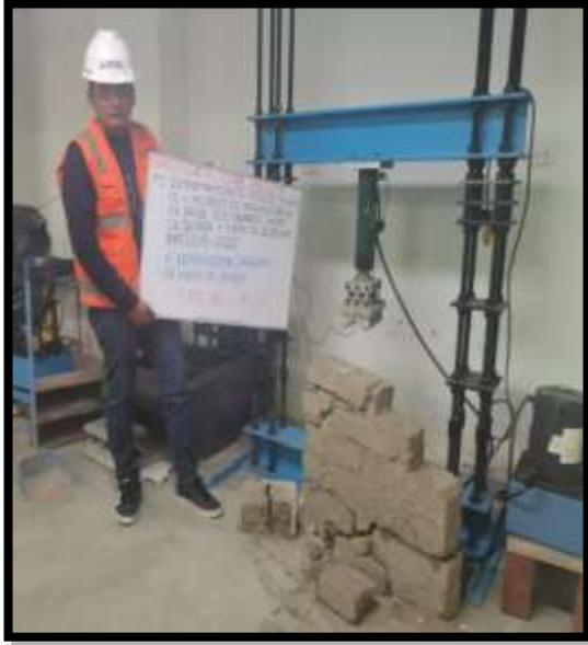
**Fotografía 76:** resistencia a compresión diagonal en muretes de adobe.
