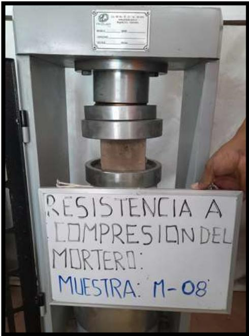
**Fotografía 58:** resistencia del mortero a compresión.
