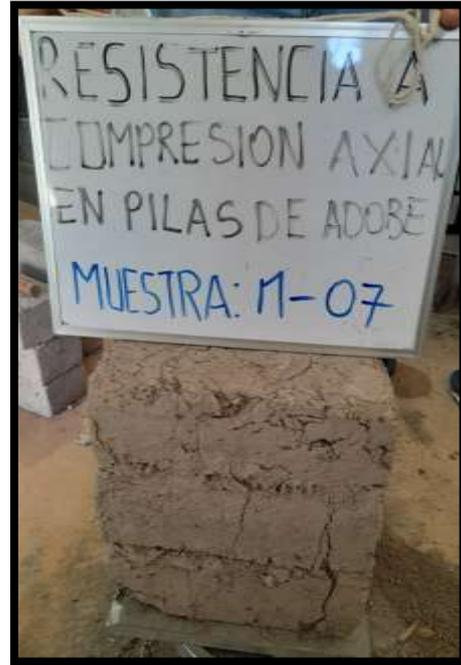
**Fotografía 69:** falla a compresión de pilas de adobe.
