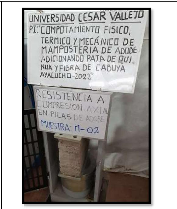
**Fotografía 65:** resistencia a compresión axial en pilas de adobe.
