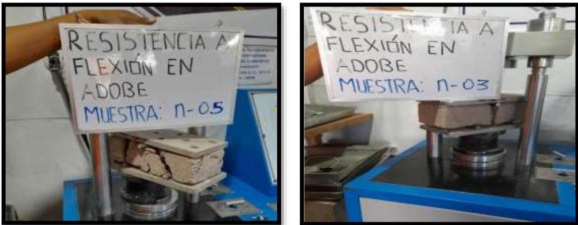
Tabla 30. Ensayo de flexión (muestra patrón)
