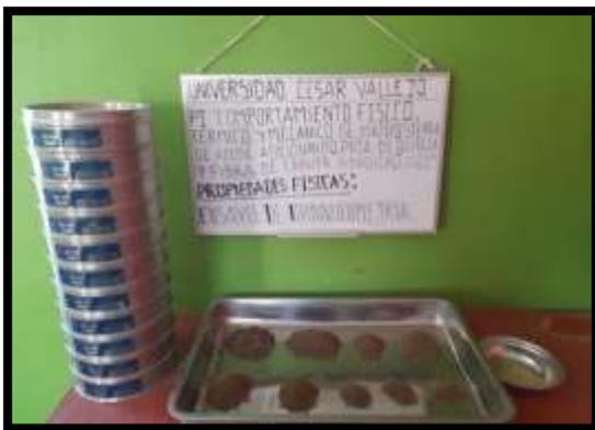
**Fotografía 35:** ensayo físico análisis granulométrico
