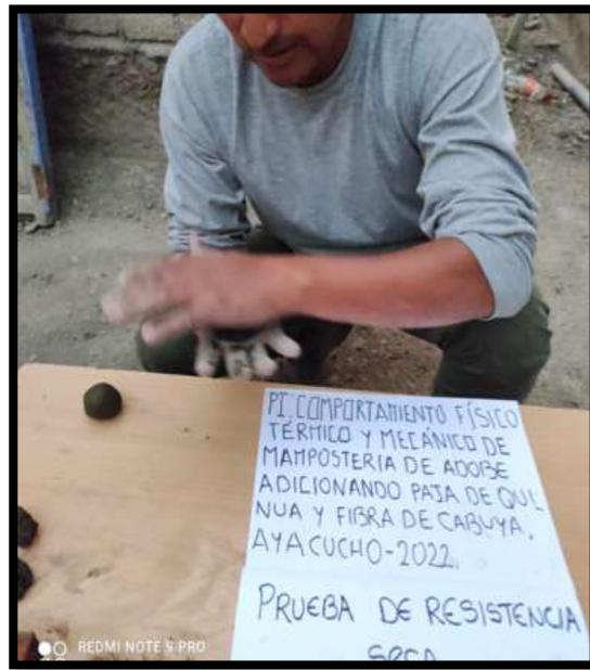
**Fotografía 16:** Prueba resistencia seca
