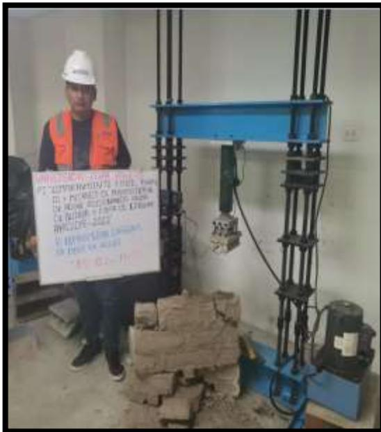
**Fotografía 74:** resistencia a compresión diagonal en muretes de adobe.
