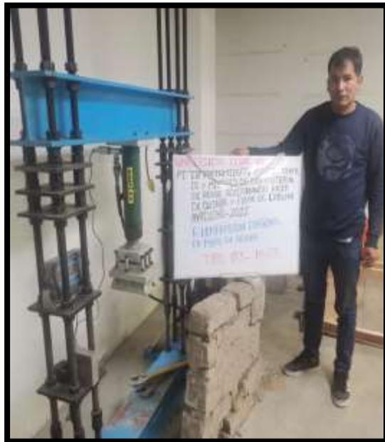
**Fotografía 75:** resistencia a compresión diagonal en muretes de adobe.
