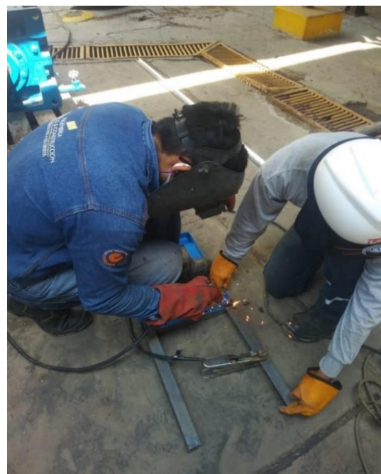
Soldeo de soporte de tablero.
